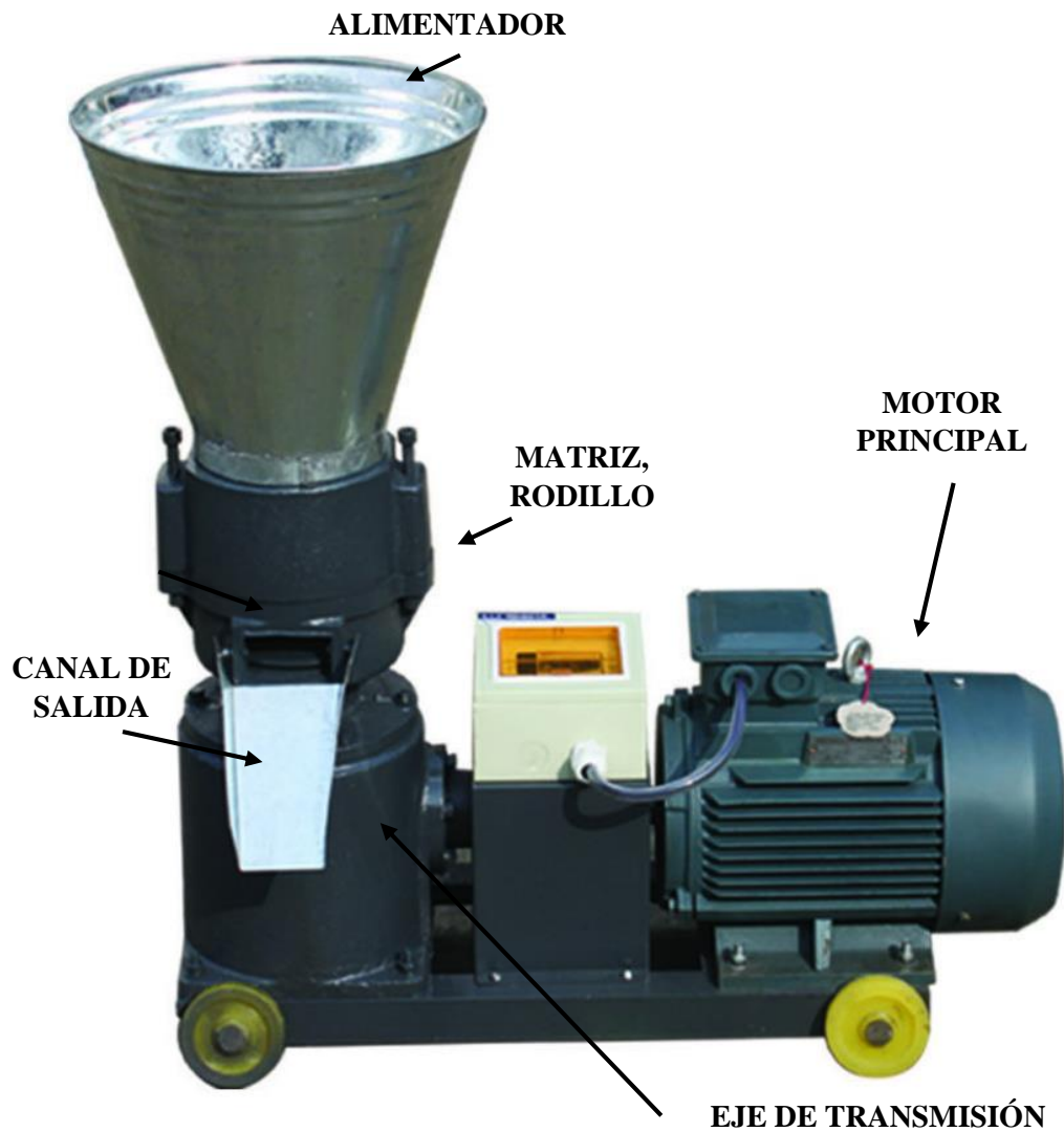
Figura No 10. Partes de una máquina pelletizadora de matriz horizontal Fuente: Laizhou Chengda Machinery Co., Ltd., 2012
