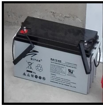
Figura 41. Batería de descarga profunda.
