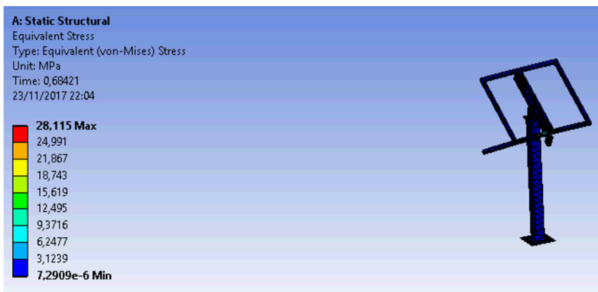
Ansys N°5. Estructura del panel – Esfuerzo equivalente.
