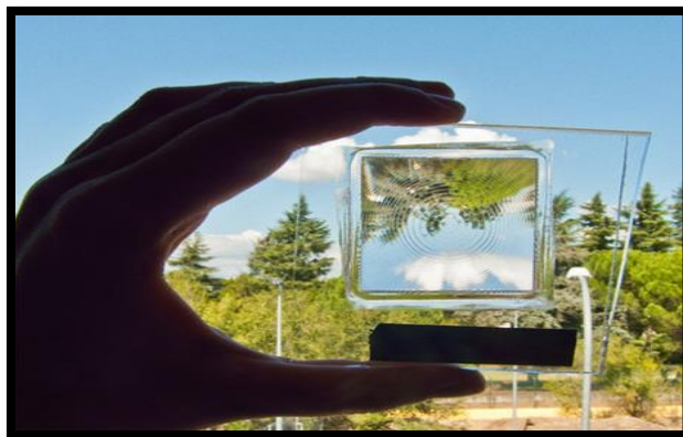
Figura 44. Sistema fotovoltaico con captador solar Fresnell. Fuente: Broessel (Broessel, 2014)
