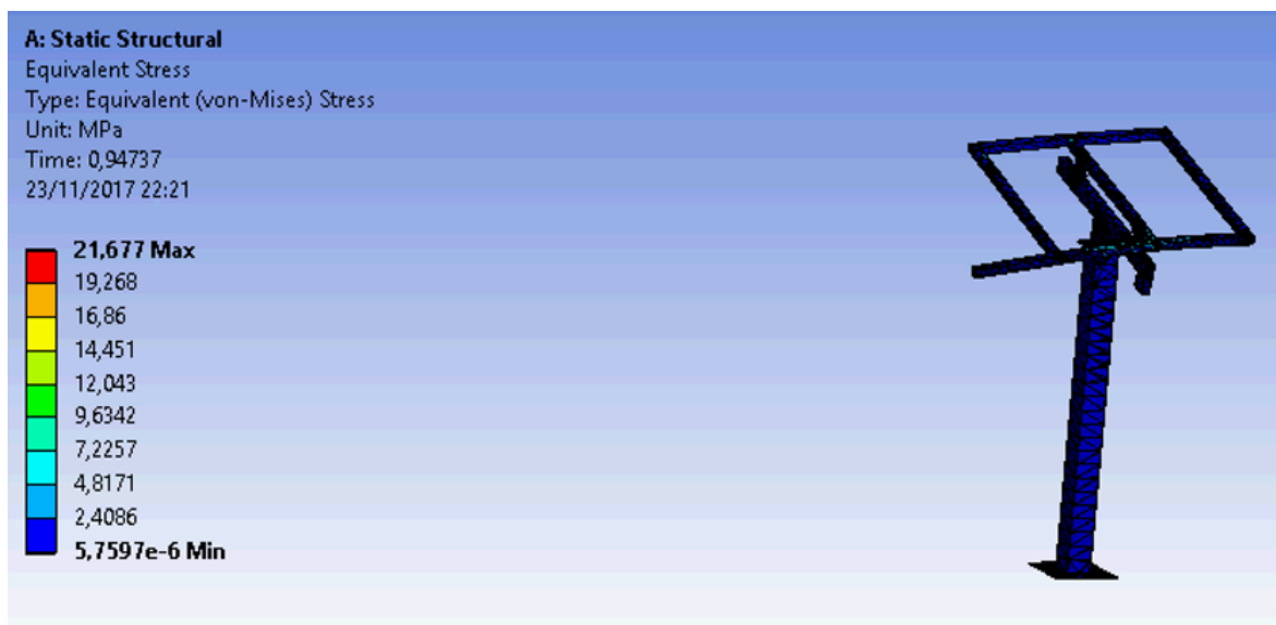
Anslys N°1. Estructura del panel – Esfuerzo equivalente.
