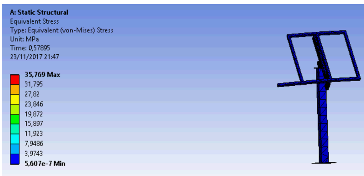
Anslys N°9. Estructura del panel – Esfuerzo equivalente.
