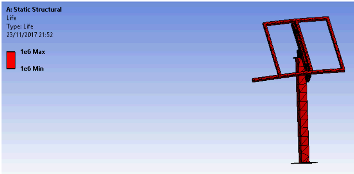
Ansys N°12. Estructura del panel – Vida útil.
