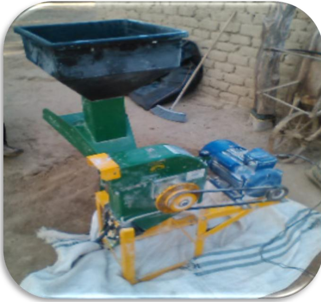
Figura N°7 Molino de Martillo graduado en 1 cm de picado.
