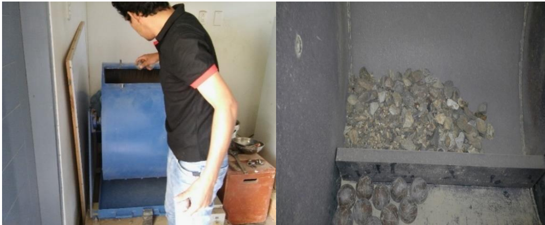
Figura 45: colocación de esferas de acero.
