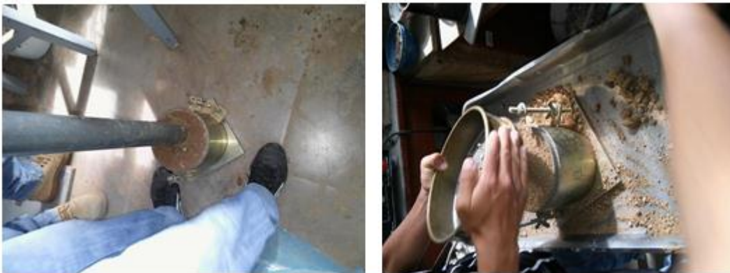
Figura 50: compactacion de material en molde para proctor y saturacion para cbr.
