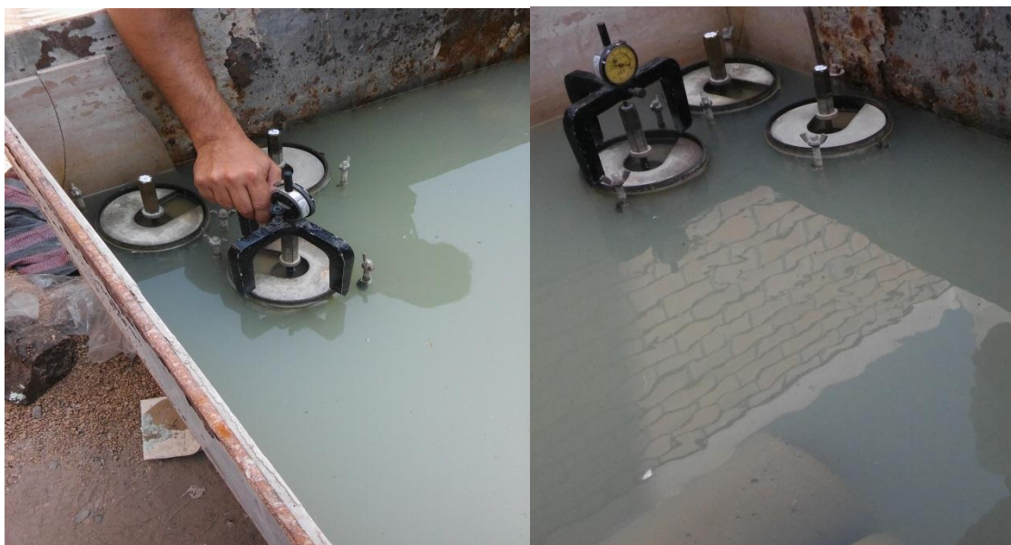
Figura 50: compactacion de material en molde para proctor y saturacion para cbr.
