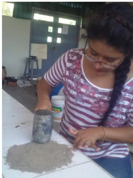
Figura 63. Aplicación del martillo de goma para contenido de sales. Fuente: Elaboración propia
