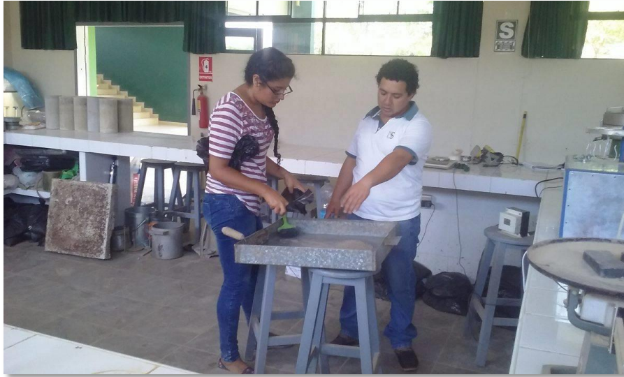
Figura 41: Haciendo el cuarteado del material sacado de la calicata
