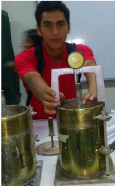
Figura 37. Ensayo de CBR, realizado muestra obtenida del área de estudio de la Urbanización Santa Margarita etapa I y II.
