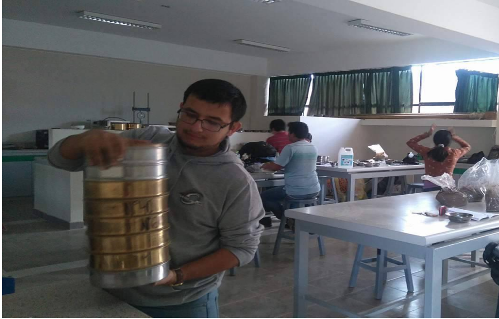
Figura 27. Tamizado de las muestras de las calicatas.
