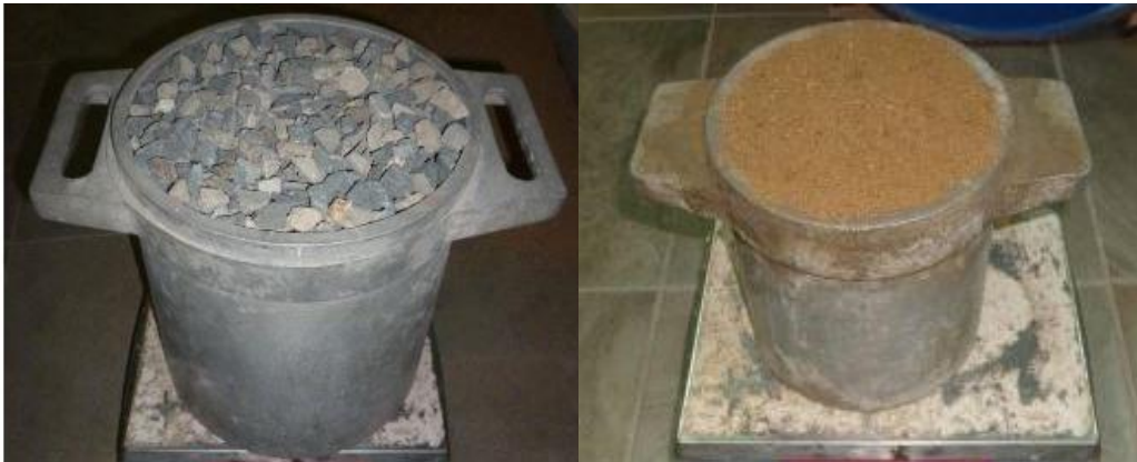
Figura 42. Peso de los agregados finos y gruesos.
