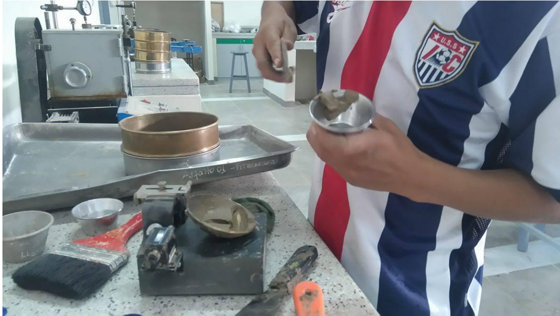
Figura 31. Se saca una porción de muestra a la ranura cerrada y se procede a determinar el contenido de humedad.
