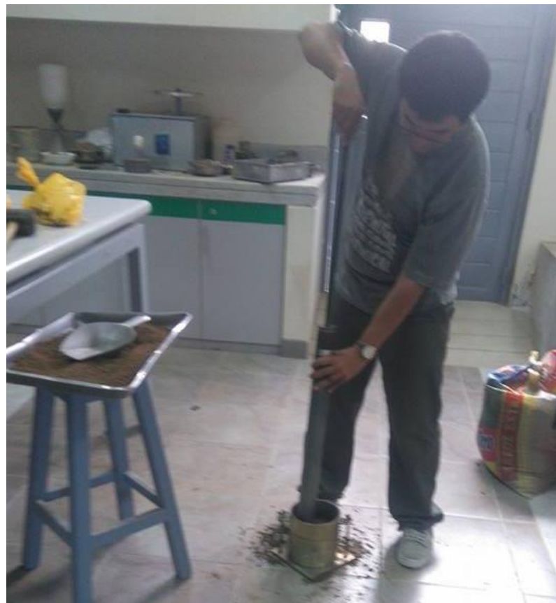
Figura 36. Compactación de la muestra preparada.
