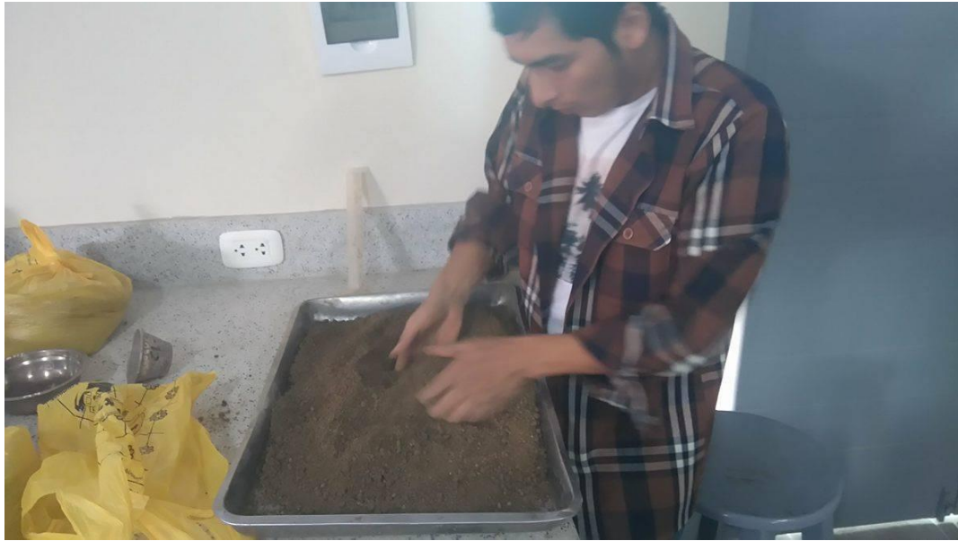
Figura 35. Ensayo de contenido de proctor modificado.
