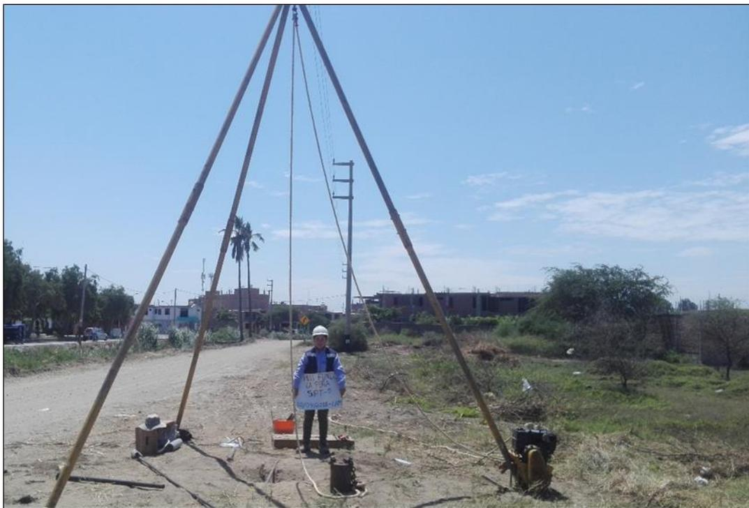
**Figura 62:** Ensayo de Penetración Estándar
