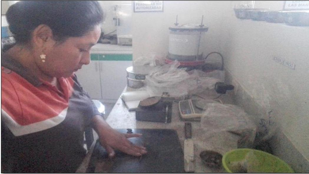
**Figura 60:** Detalle del procedimiento que se siguió para realizar el ensayo de Limite plástico según norma ASTM D4318
