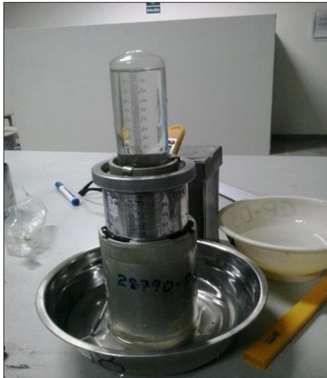
**Figura 61:** Ensayo de permeabilidad de carga constante:
