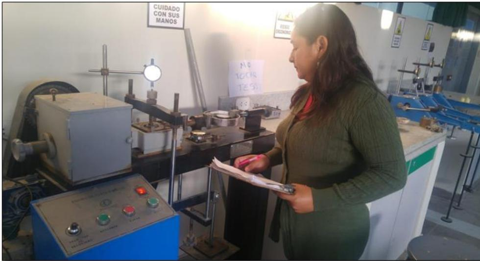
**Figura 42** : Detalle del procedimiento que se siguió para realizar el ensayo de corte directo según la Norma ASTM D3080, y el inicio de las mediciones de las cargas y deformaciones.
