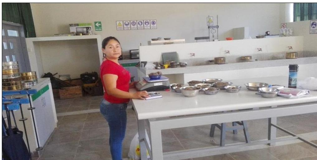
**Figura 44:** Pesaje de las muestras alteradas para los cálculos respectivos.
