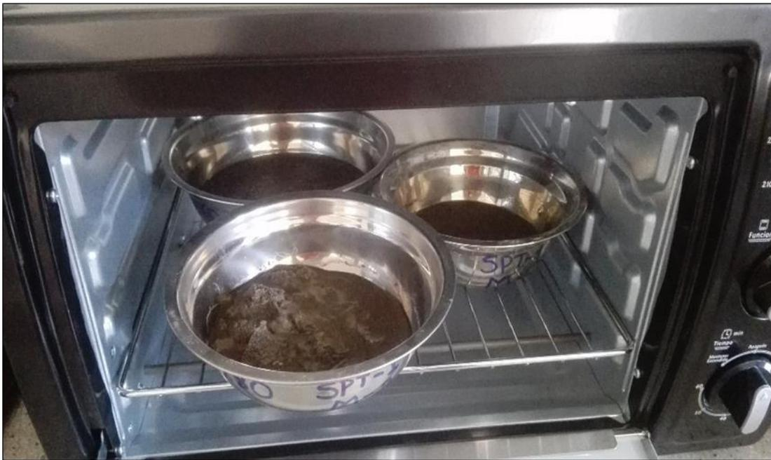
**Figura 43:** Detalle del procedimiento que se siguió para realizar el ensayo de Contenido de Humedad Natural, según ASTM D2216.
