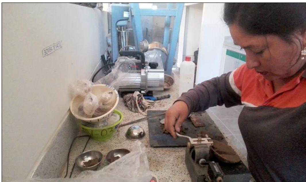
*Figura 59: Detalle del procedimiento que se siguió para realizar el ensayo de Limite Liquido según norma ASTM D4318*
