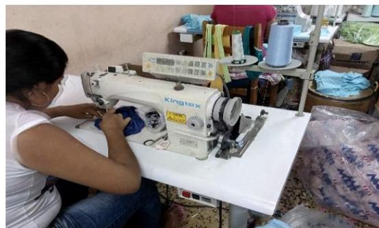
*Figura 29:* Pegado de Delantera y Posterior
