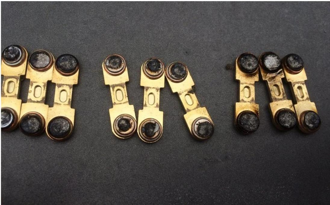
**Figura 14:** Bornes del contactor sulfatados
