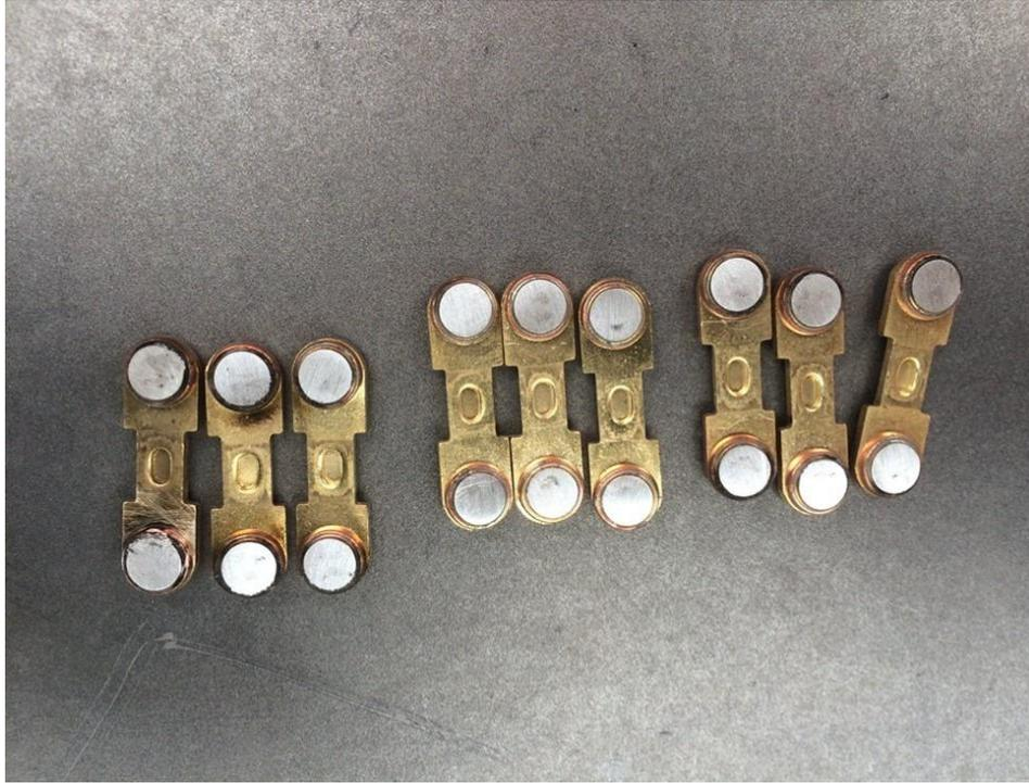
**Figura 15:** Bornes limpios del contactor para optimo trabajo
