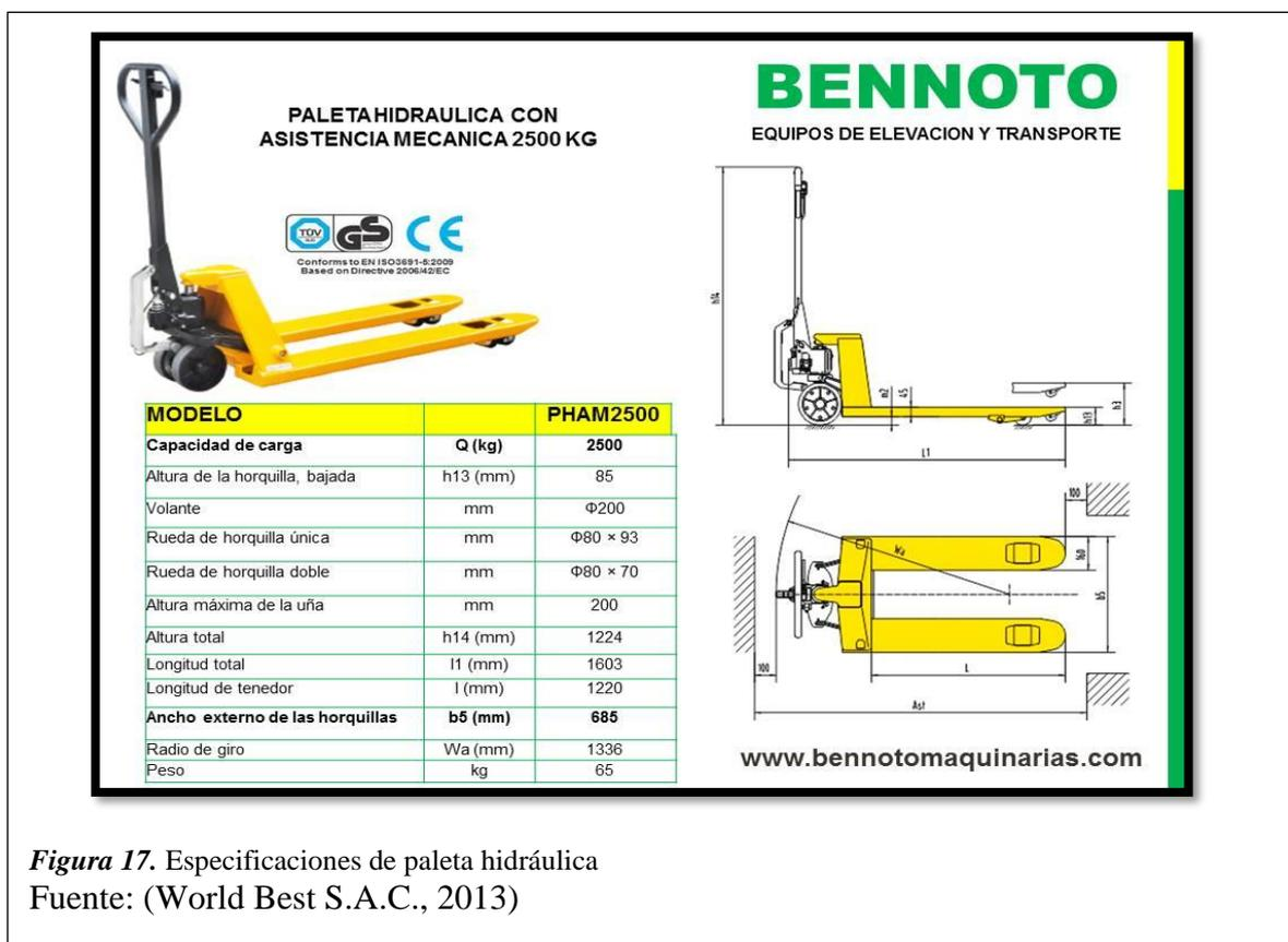
Figura 17. Especificaciones de paleta hidráulica
