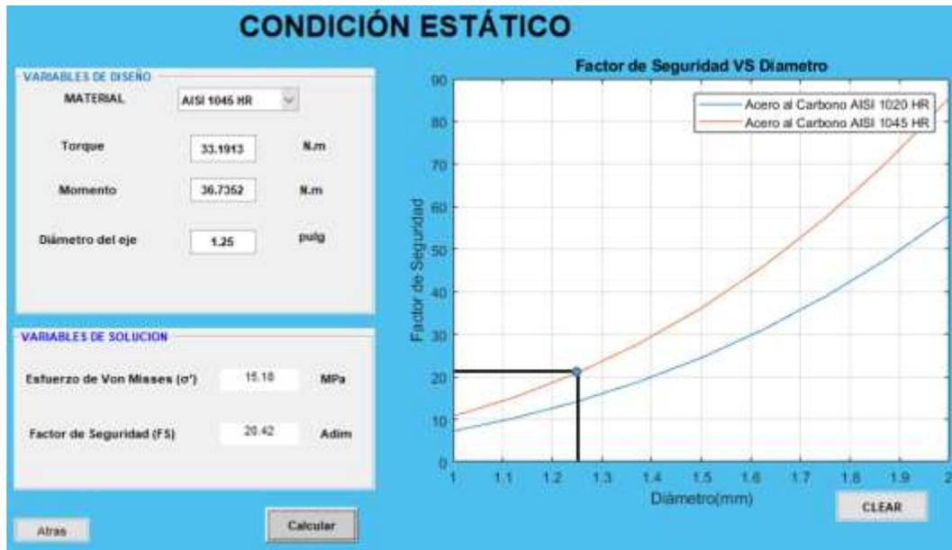
**Figura 54.** Condición estático -AISI (1045)- MatLab-GUI
