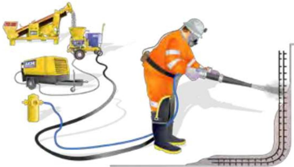
**Figura 34.** Mangueras-aire, agua, concreto
