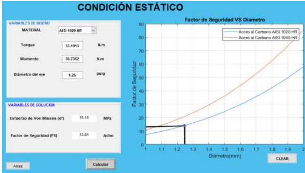
**Figura 52.** Condición estático -AISI (1020)- MatLab-GUI
