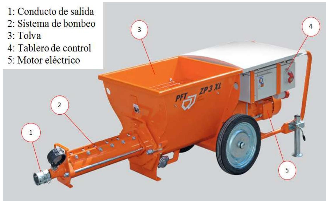
**Figura 31.** Partes de la maquina de concreto lanzado
