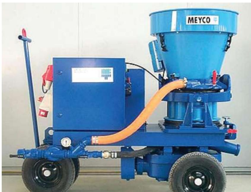
**Figura 25.** Equipo Meyco Piccola de shotcrete via seca
