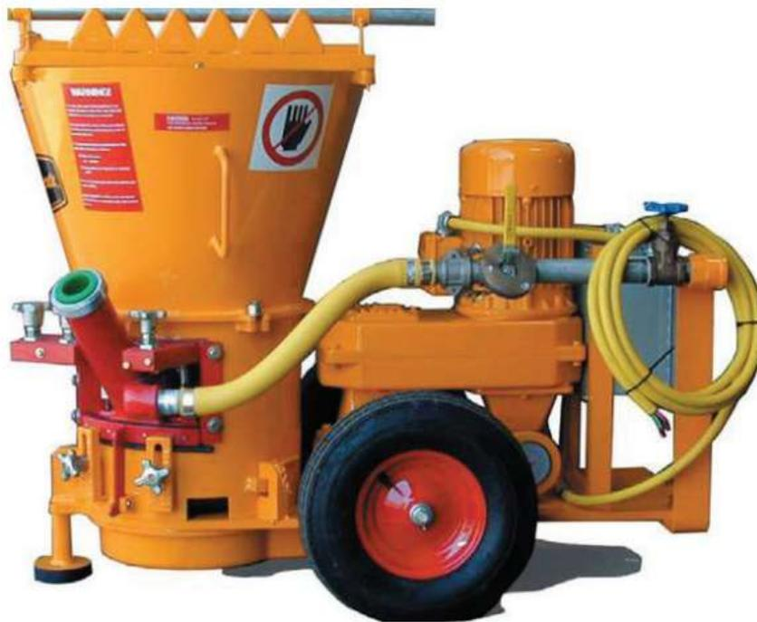
**Figura 28.** Equipo de shotcrete via seca “plato rotatorio”
