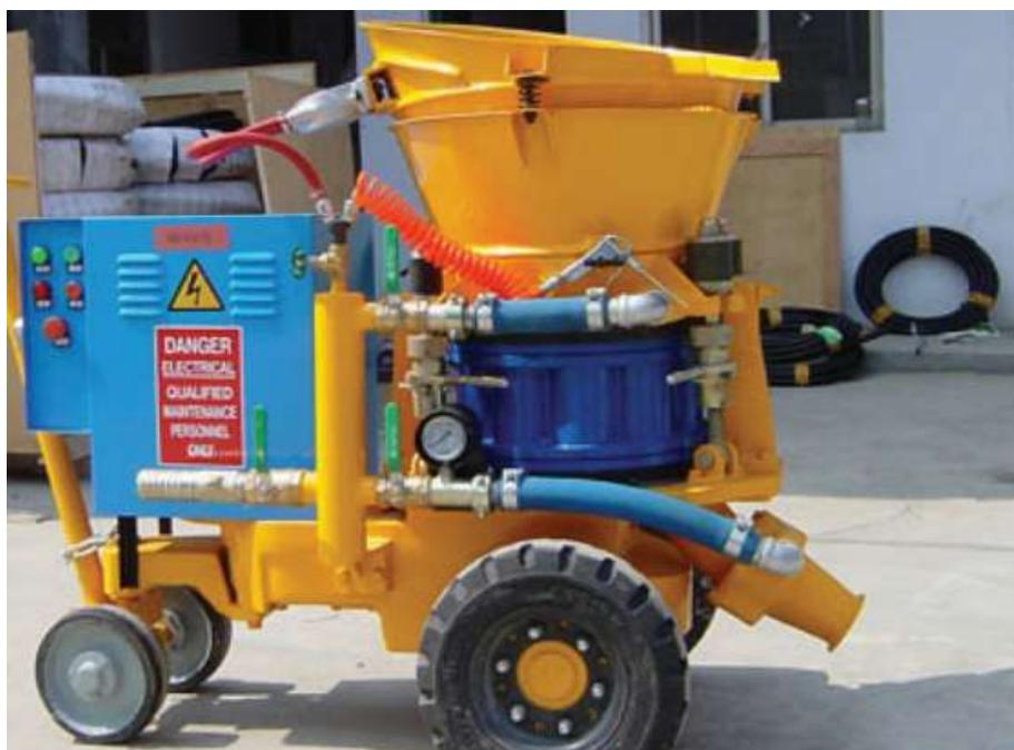
**Figura 26.** Otro modelo del equipo de shotcrete para via seca del tipo rotatorio
