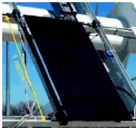
Figura 2.2: Módulo basado en silicio poli-cristalino depositado sobre vidrio.
