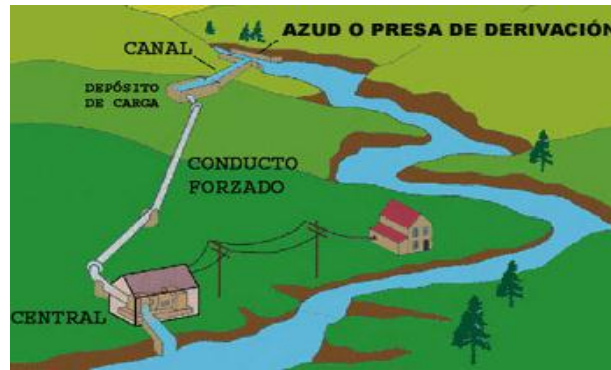
Ilustración 17 Mini central hidroeléctrica de pasada. Fuente (ITDG)
