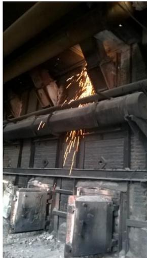
Entradas de bagazo, a través de toberas, imagen tomada durante el mantenimiento
