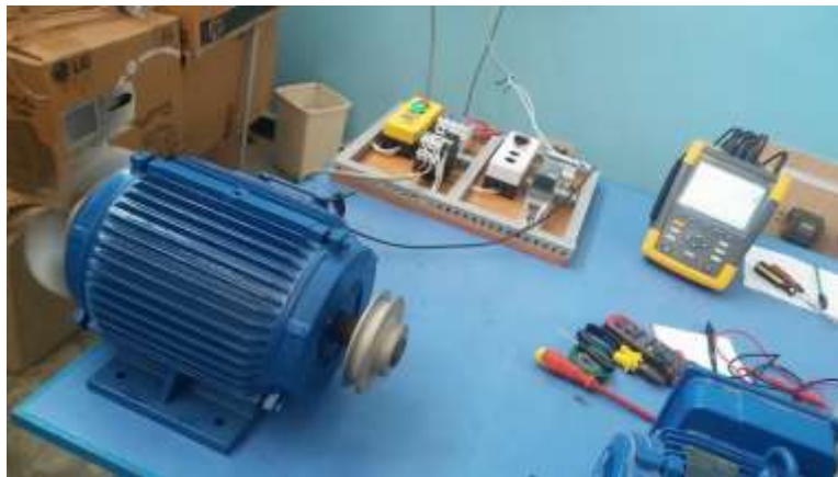
Figura 76 Prueba de Motor 5 HP - Circuito Convencional.
