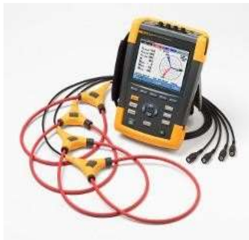
Figura 71 Analizador de energía.
