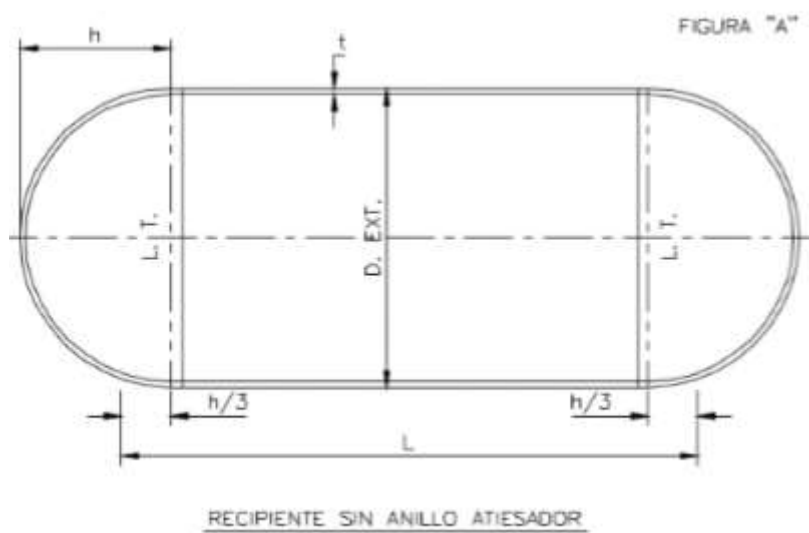
Ilustración 16: Recipiente sometido a presión según la norma ASME.
