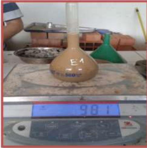
Figura 18 y 19: Peso de la fiola con el agregado fino para concluir con el ensayo de peso específico del agregado fino.
