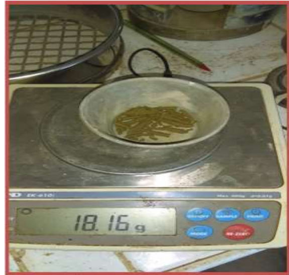
Figura 11 y 12: Ensayo de Limite Plástico con la muestra moldeada y pesada lista para su secado.
