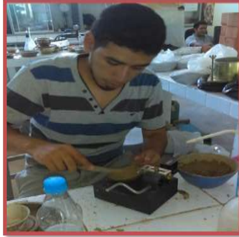
Figura 10: Ensayo de límite líquido con el instrumento Casagrande.
