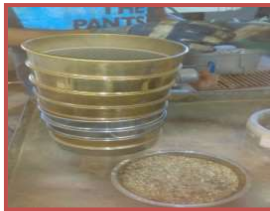
Figura 7 y 8: Tamizado del material fino para el ensayo de granulometría.
