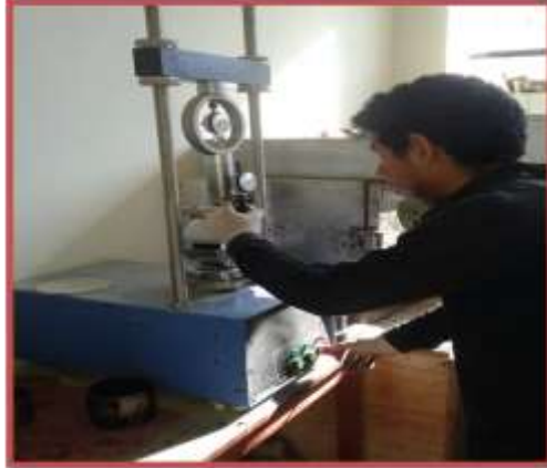
Figura 33: Ensayo de Marshall para saber el flujo y la estabilidad de las briquetas.
