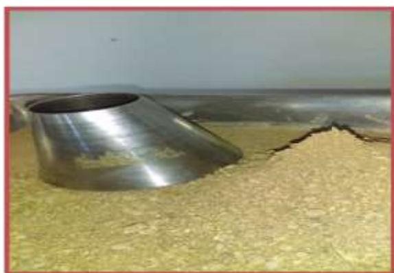
Figura 16 y 17: Ensayo de peso específico del agregado fino y la prueba con el molde cónico ya con la muestra seca.
