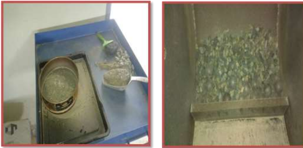
Figura 24 y 25: Ensayo de Abrasión de los ángeles, tamizado y vaciado para ver el desgaste del agregado grueso.
