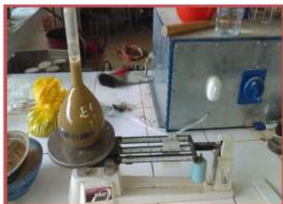
Figura 16 y 17: Ensayo de peso específico del agregado fino y la prueba con el molde cónico ya con la muestra seca.
