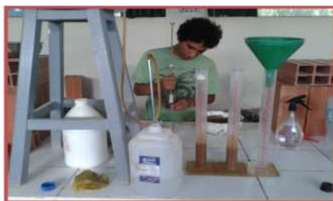
Figura 13: Ensayo de Equivalente de arena, alistando la manguera para que descargue la solución a la muestra.
