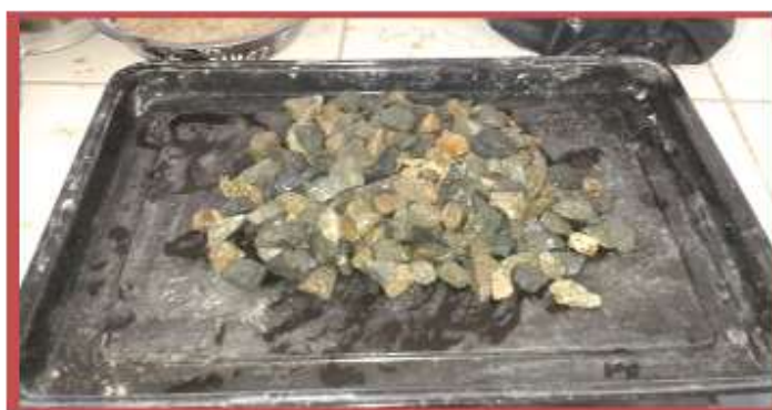
Figura 15: Peso específico del agregado grueso, muestra lista para el ensayo.
