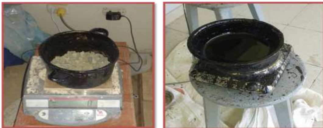
Figura 31 y 32: Agregado grueso y fino calentado a 135° y el asfalto a 150°.
