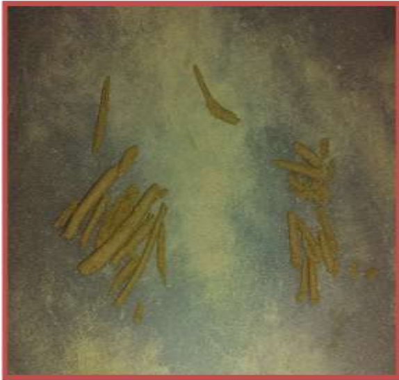
Figura 11 y 12: Ensayo de Limite Plástico con la muestra moldeada y pesada lista para su secado.
