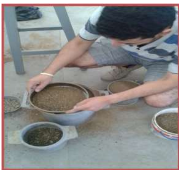
Figura 22 y 23: Peso unitario del agregado fino vaciado y compactado
