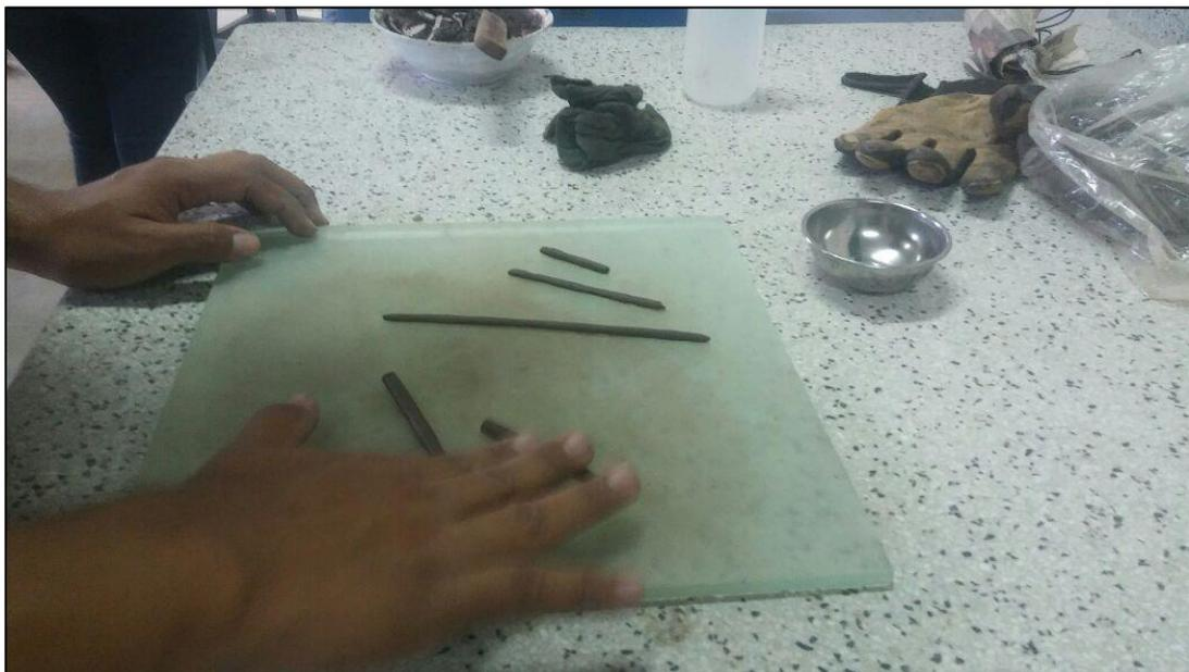
**Figura 21:** Realización de bastoncillos para determinar el límite plástico.
