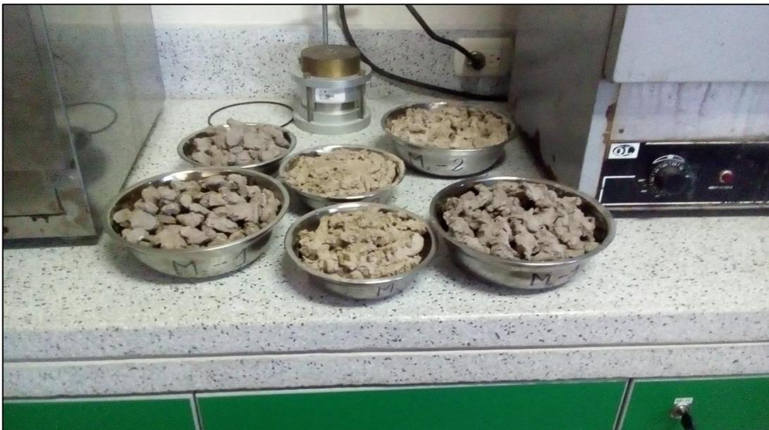
**Figura 18:** Muestras secadas al horno durante 24 horas.
