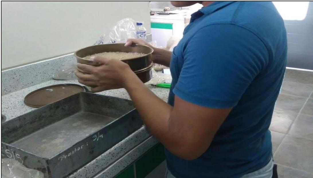
**Figura 22:** Tamizado de muestra seca por la malla N°4.
