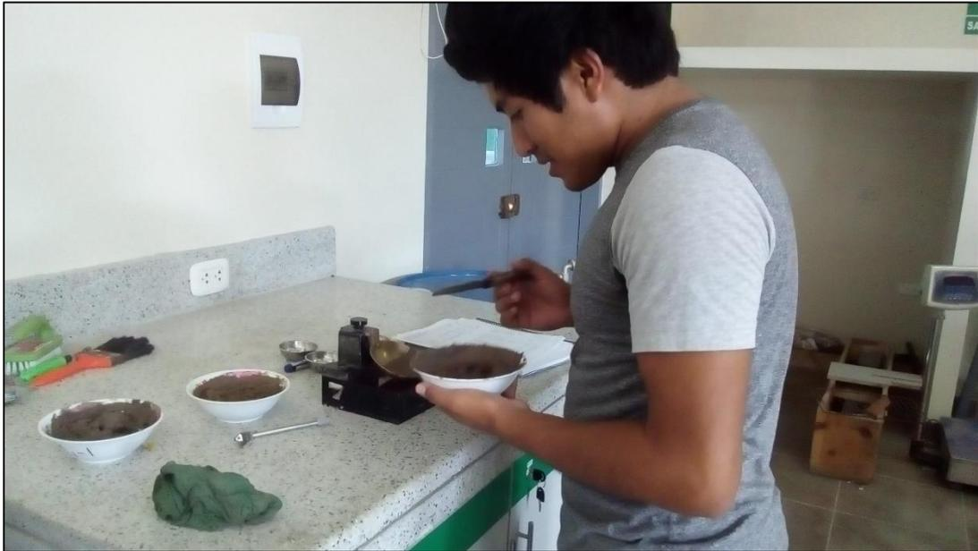
**Figura 20:** Batido de mezcla para variar el contenido de humedad.
