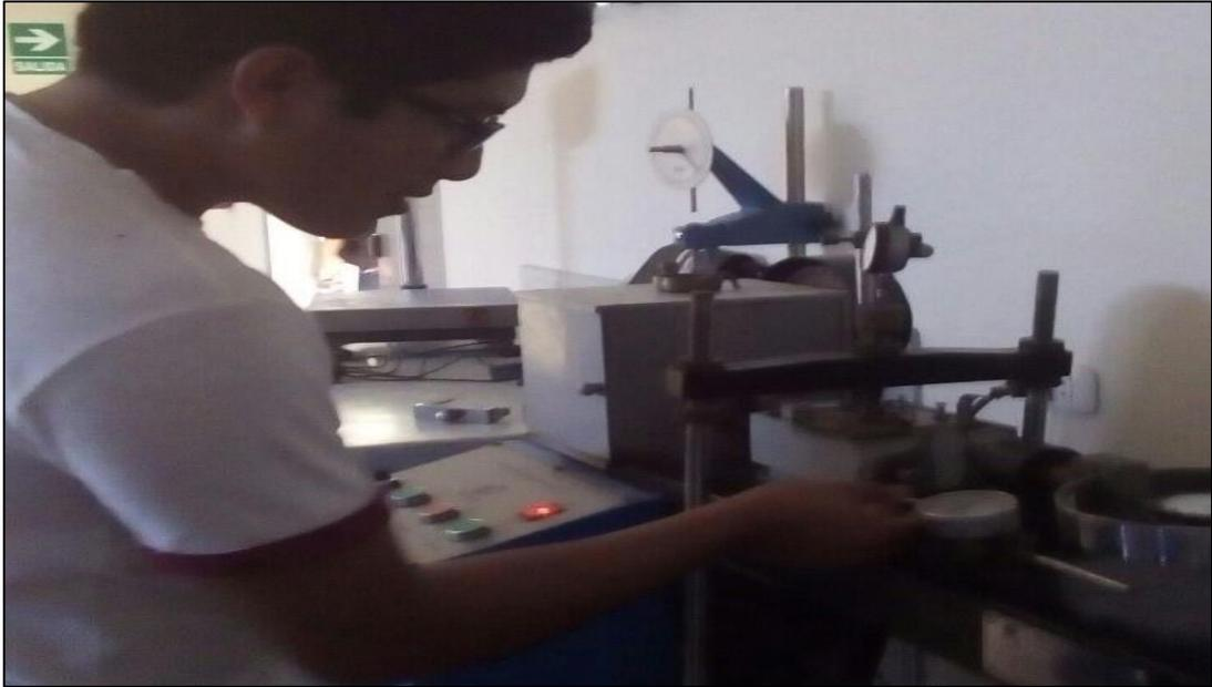
**Figura 23:** *Preparación del equipo de corte directo.*
