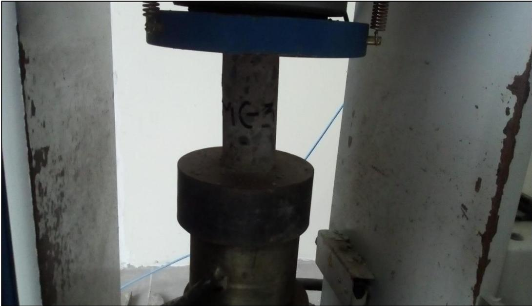
**Figura 25:** Rotura de corazón diamantino en presa para ensayo de concreto.
