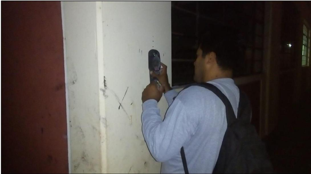
**Figura 16:** Técnico identificando la distribución de refuerzo longitudinal en columnas.
