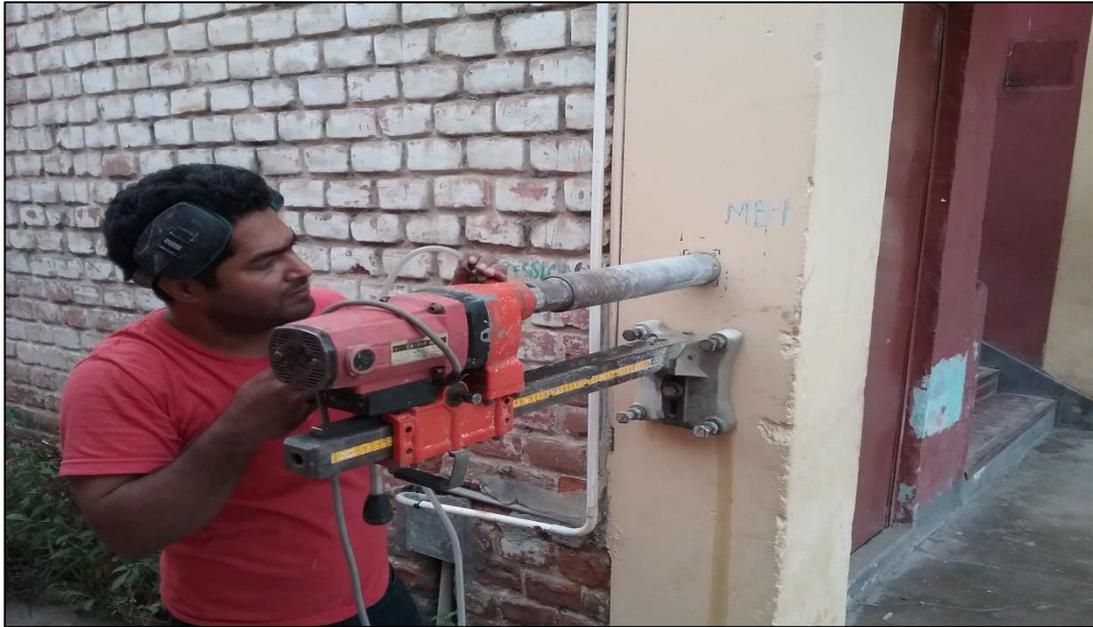
**Figura 24:** *Extracción de corazones diamantinos en elementos estructurales.*
