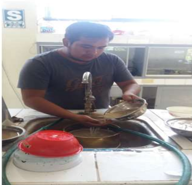
Figura 46: Lavado de muestras para realizar la granulometría Fuente: Propia
