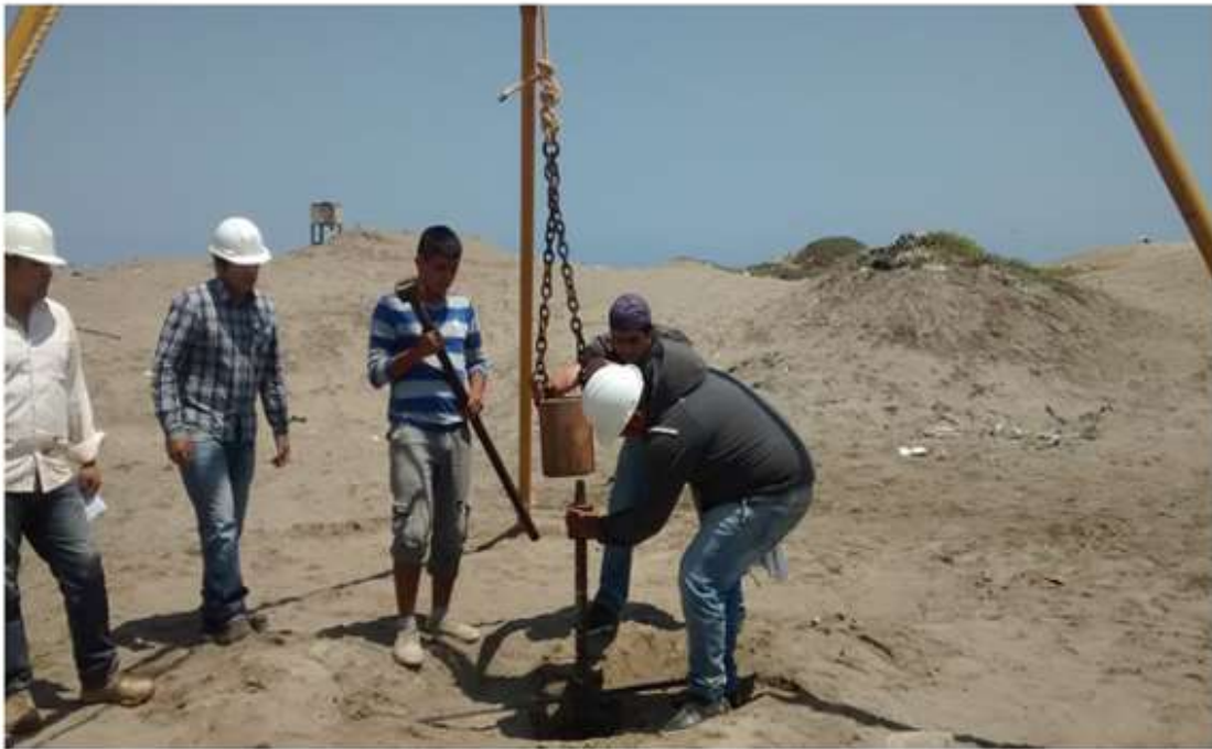
Figura 33: Preparación de la caña para hincar los primeros 15 cm en el SPT-4 Fuente: Propia
