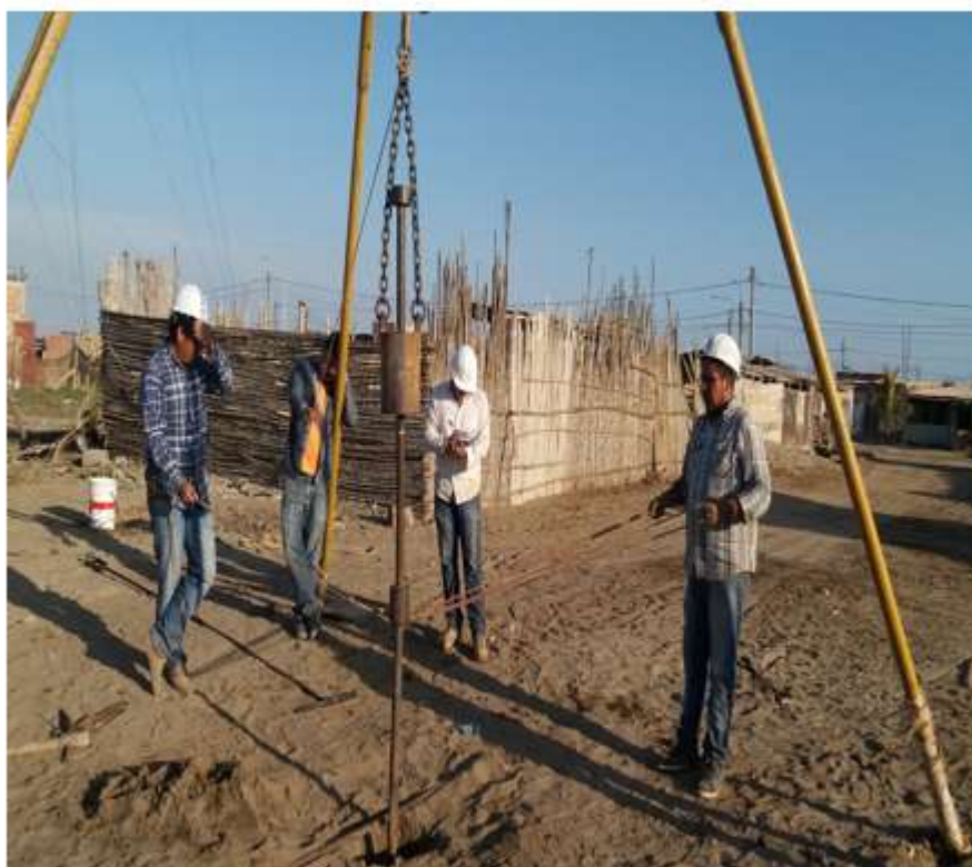
Figura 36: Tomando registro del numero de golpes ( N_{SPT} ) para cada 15cm en el SPT-8
