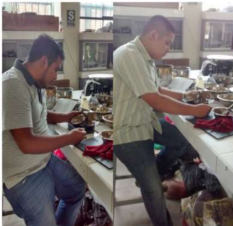
Figura 51: Copa casa grande, realizando ensayo de limite liquido mediante el numero de golpes Fuente: Propia
