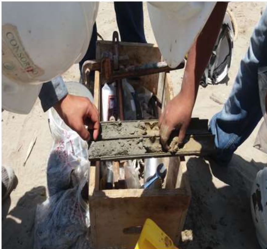
Figura 43: Muestra obtenida de la caña partida para el SPT-7 Fuente: Propia
