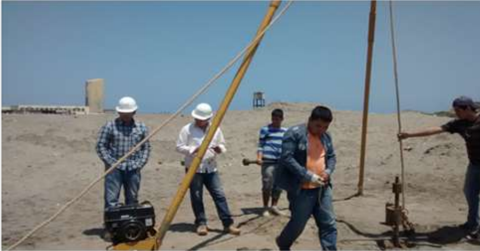
Figura 31: Ensamblaje del equipo SPT para iniciar el sondo respectivo del SPT-3
