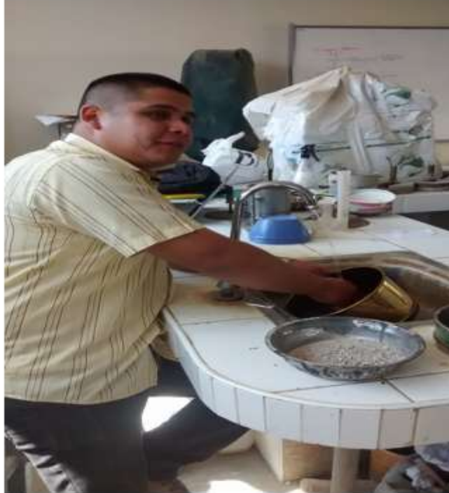
Figura 45: Lavado de muestras para realizar la granulometría SPT-3 Fuente: Propia.
