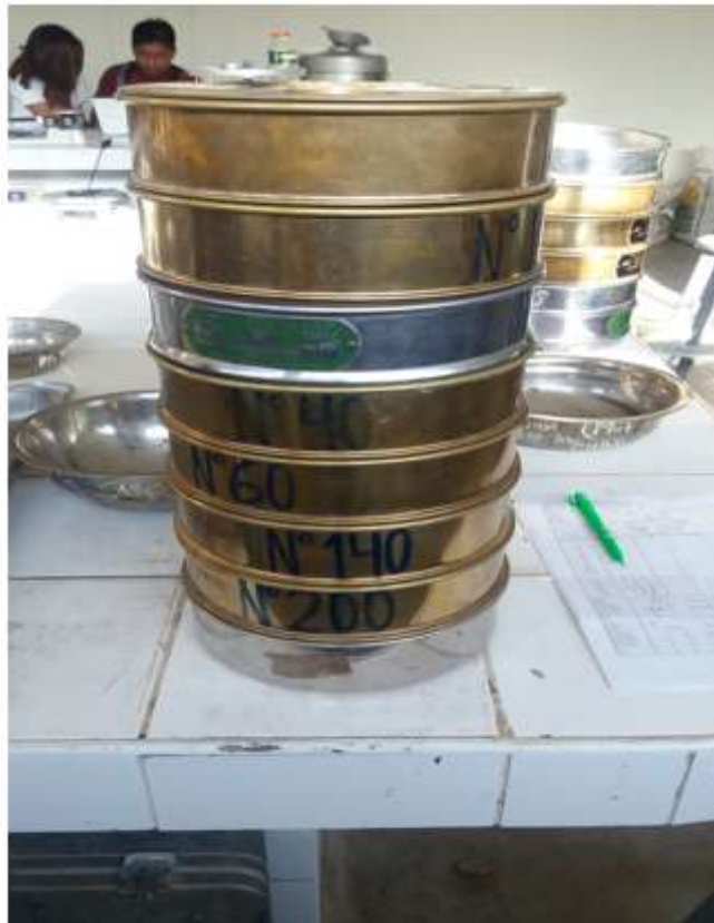
Figura 48: Tamices utilizados en la granulometría Fuente: Propia
