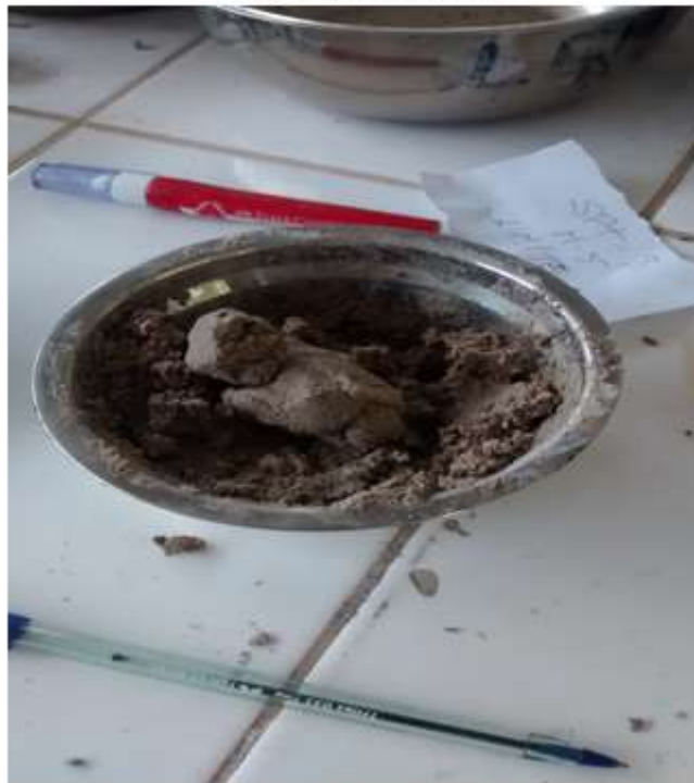
Figura 49: Muestra húmeda para empezar a realizar el ensayo de limite liquido Fuente: Propia
