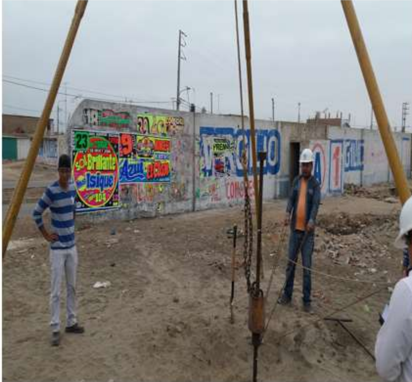
Figura 37: Tomando registro del número de golpes ( N_{SPT} ) para cada 15cm en el SPT-7
