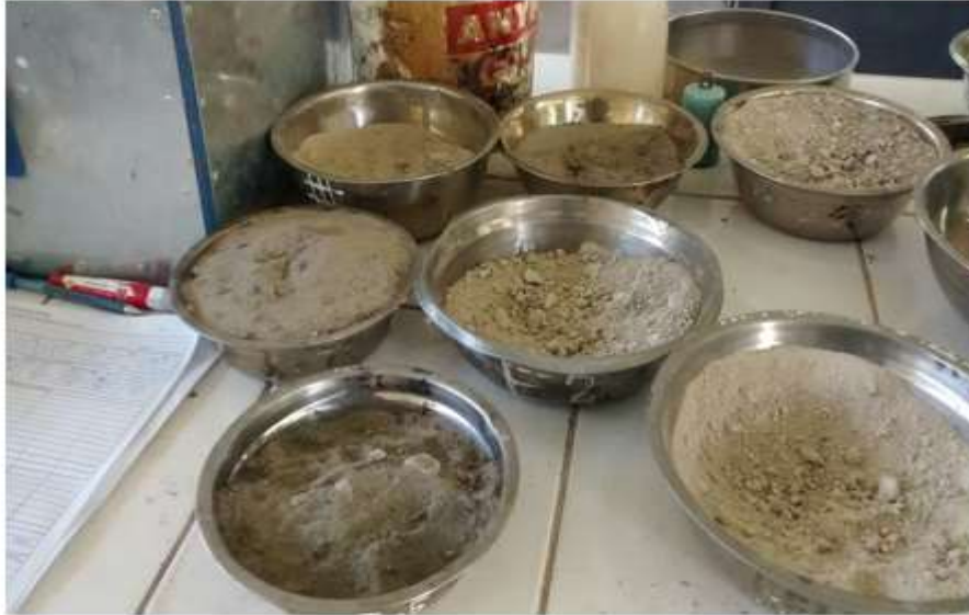
Figura 45: muestras para realizar el cuarteo y realizar granulometría, límites y gravedad específica Fuente: Propia
