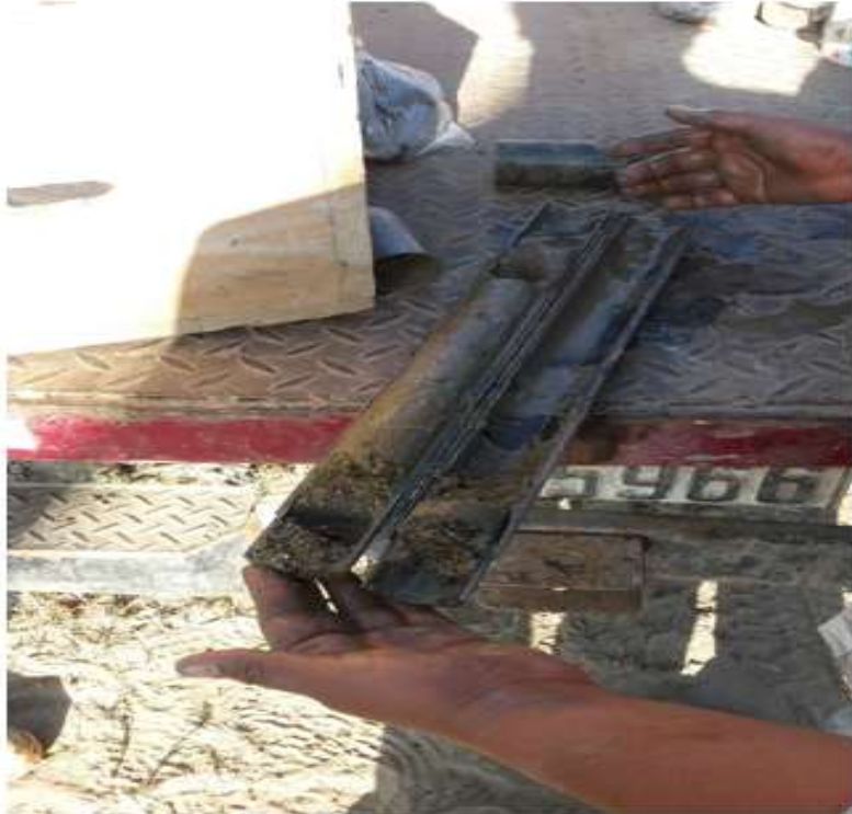
Figura 44: Muestra obtenida de la caña partida para el SPT-8 Fuente: Propia
