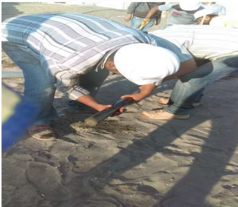
Figura 38: extracción del muestreador de caña partida en el SPT-2 Fuente: Propia
