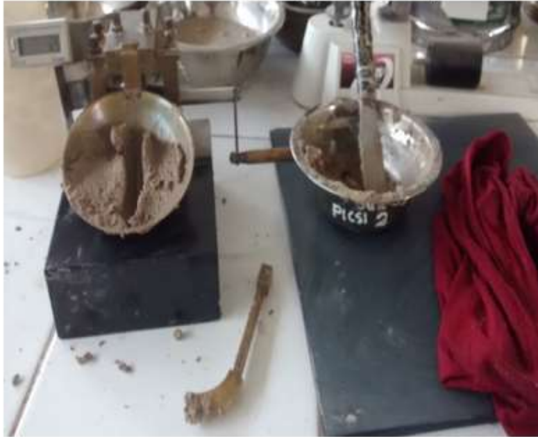
Figura 50: Muestra para realizar limite liquido Fuente: Propia
