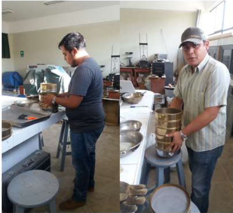
Figura 47: Tamizado de las muestras para la granulometría Fuente: Propia
