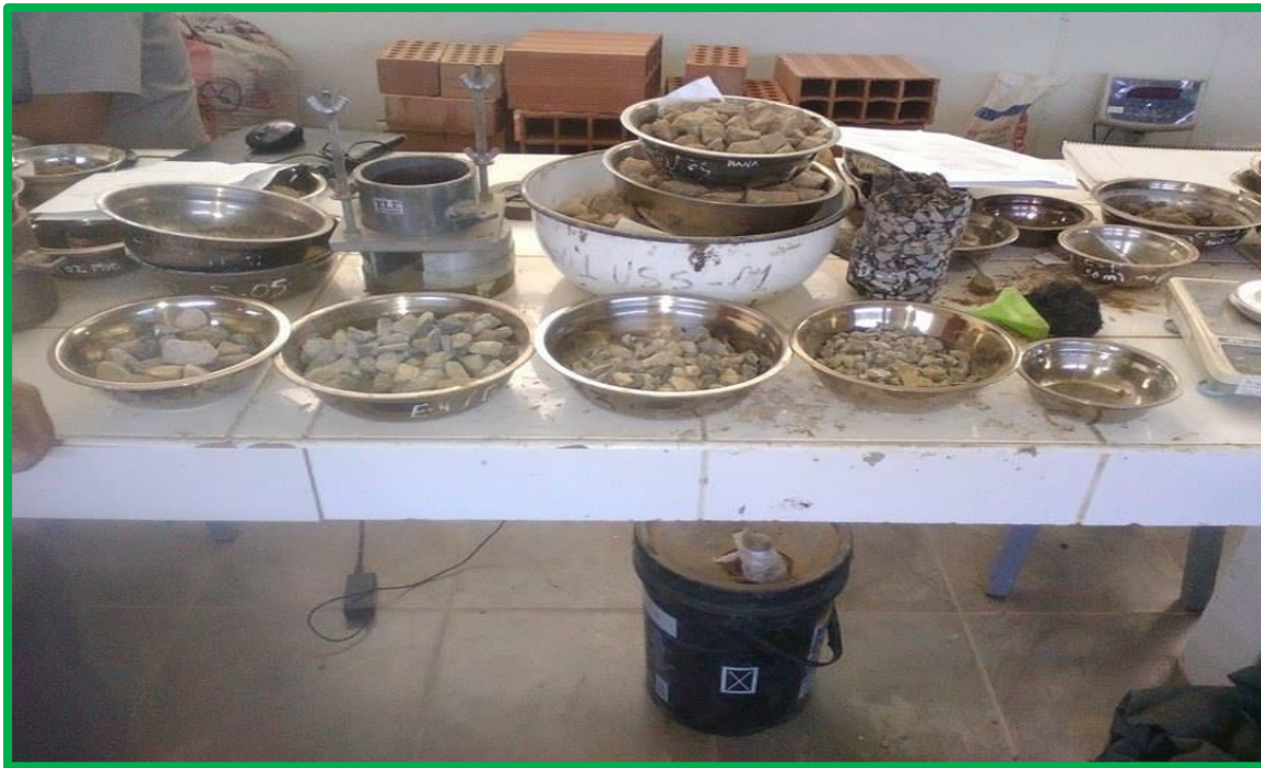
Foto N° 01 : Análisis granulométrico por tamizado del agregado grueso. Norma: (NTP 400.012); (ASTM C 136)
