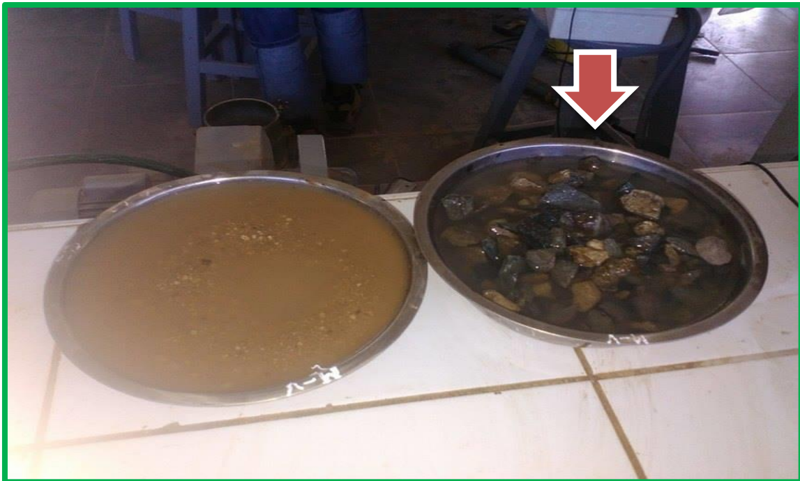
Foto N° 03 : Peso específico y porcentaje de absorción del agregado grueso. Norma: (NTP 400.021); (ASTM C 127)
