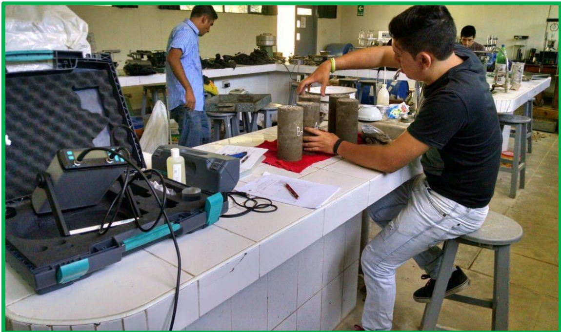
Foto N° 17 : Aplicando el gen transductor a las muestras para el ensayo de velocidad de pulso.
