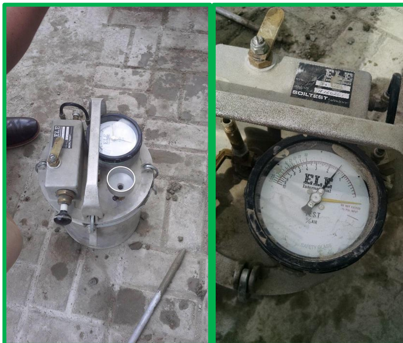
Foto N° 10 : Ensayo para determinar el contenido de aire. Norma: (ASTM C138)
