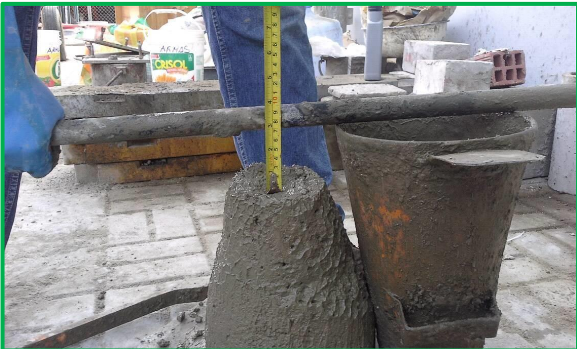
Foto N° 08 : Ensayo para la medición del asentamiento. Norma: (ASTM C143)
