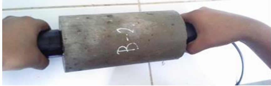
Figura 20: Técnicas de medición directa sobre probeta cilíndrica
