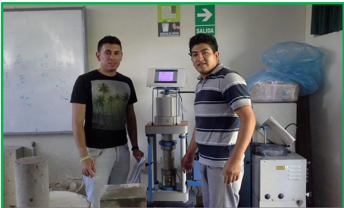
Foto N° 18 : Ensayos de Resistencia a compresión. Norma: (ASTM C39); (NTP 339.034)
