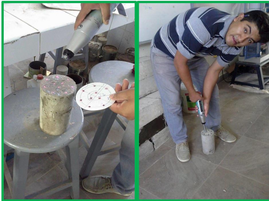
Foto N° 19 : Ensayo adicional con el esclerómetro (END). Norma : (ASTM C805); (NTP 399.181)
