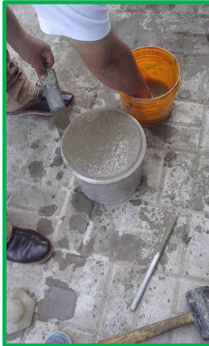
Foto N° 09 : Ensayo para determinar el peso unitario y densidad. Norma: (ASTM C138)
