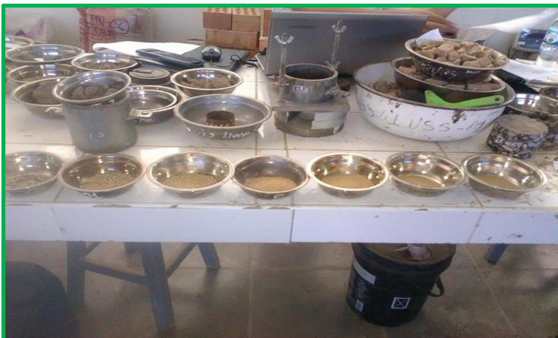
Foto N° 02 : Análisis granulométrico por tamizado del agregado fino. Norma: (NTP 400.012); (ASTM C 136)
