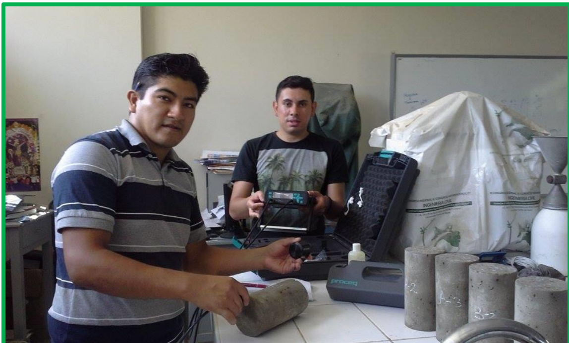
Foto N° 16 : Ensayo de la velocidad de pulso ultrasónico. Norma: (ASTM C597)
