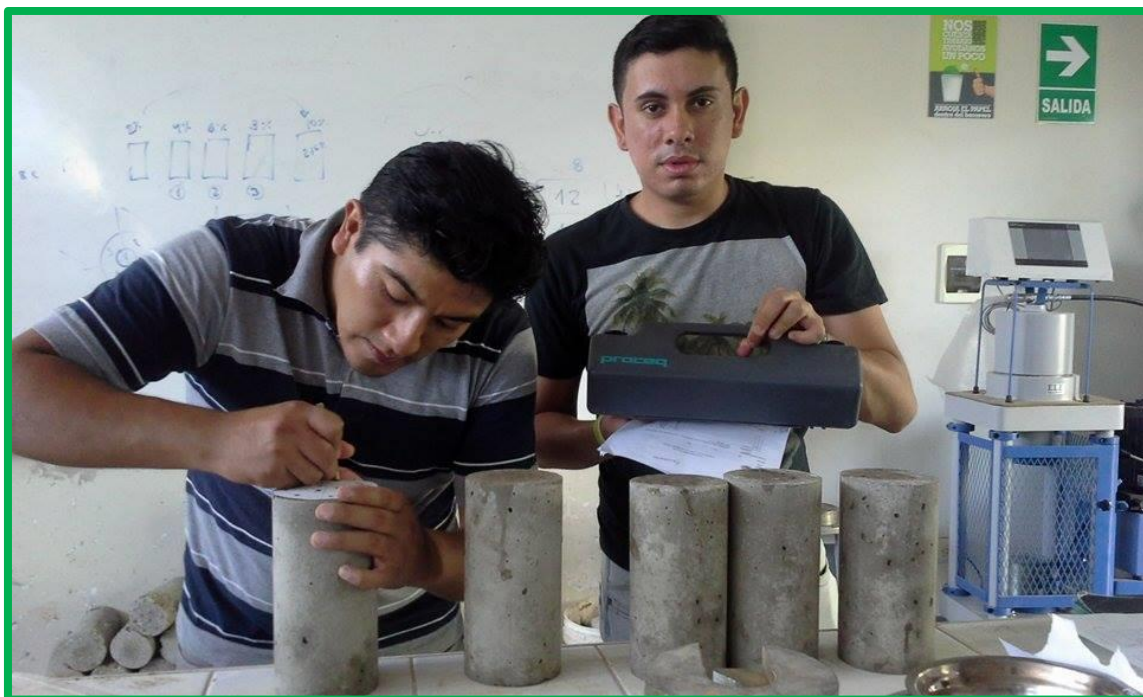
Foto N° 20 : Distribución y marcado de los puntos en las muestras para el Ensayo adicional con el esclerómetro.
