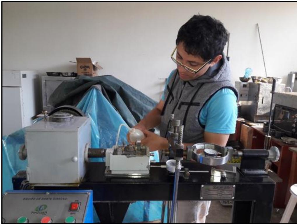
Figura 73. Colocación del molde en el equipo de corte (previa saturación por 24 horas).
