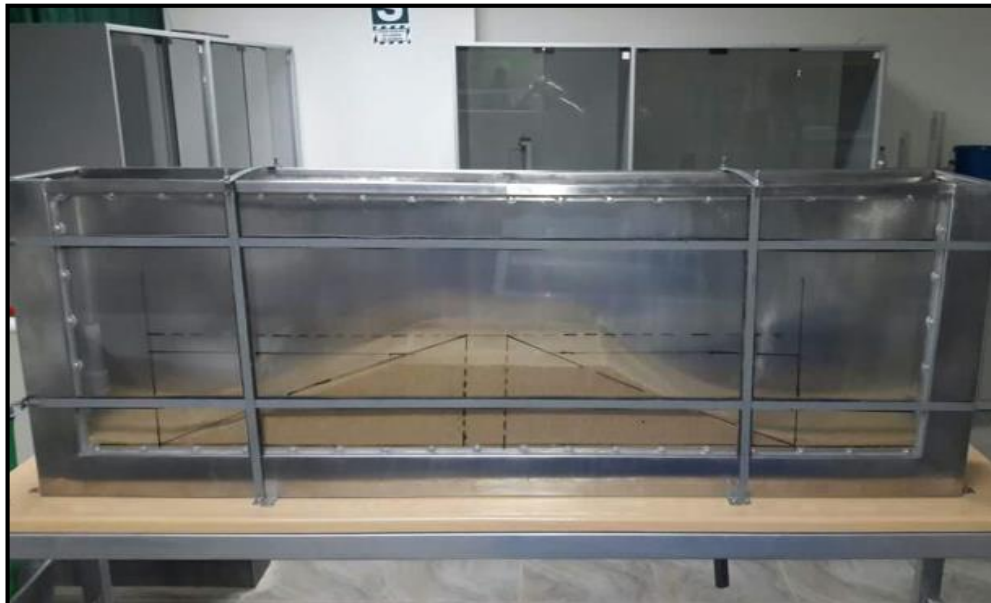
Figura 202. Trazo de la sección transversal de presa en la pantalla acrílica.
