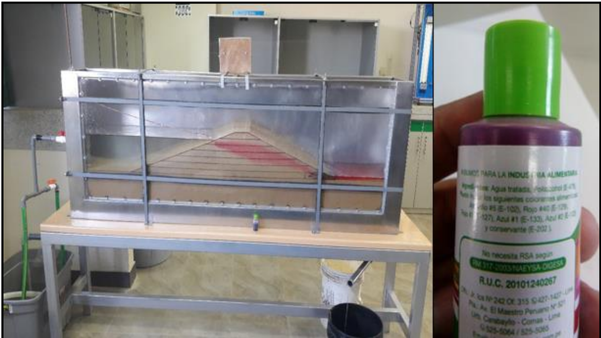
Figura 223. Línea de saturación visible gracias al tinte rojo a base de agua tratada, polialcohol y colorante #40.
