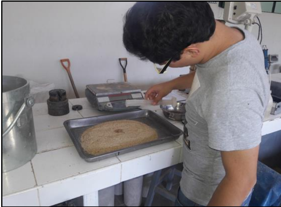
Figura 65. Incorporación de agua a la muestra de arena.
