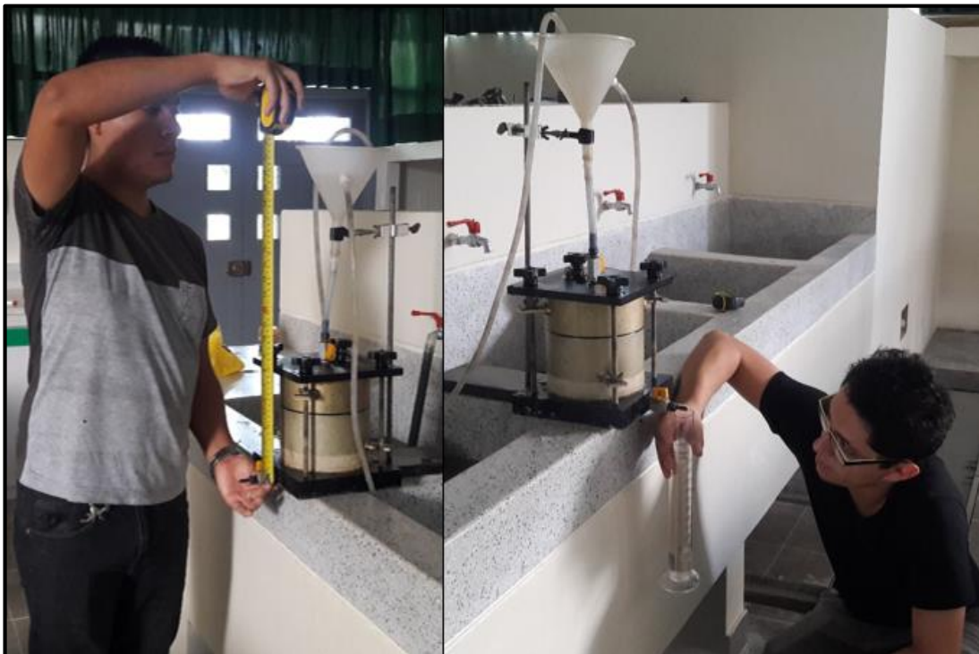
Figura 71. Toma de mediciones en el permeámetro de carga constante.
