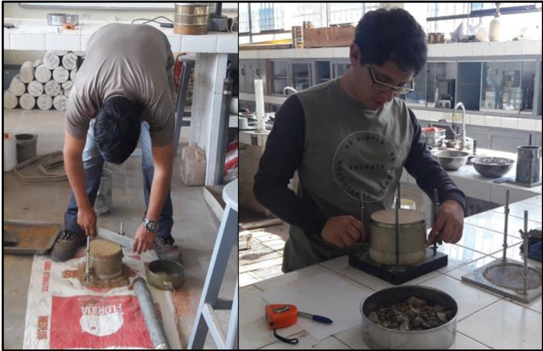
Figura 68. Enrasado de la arena y colocación del molde cilíndrico en la base del permeámetro.
