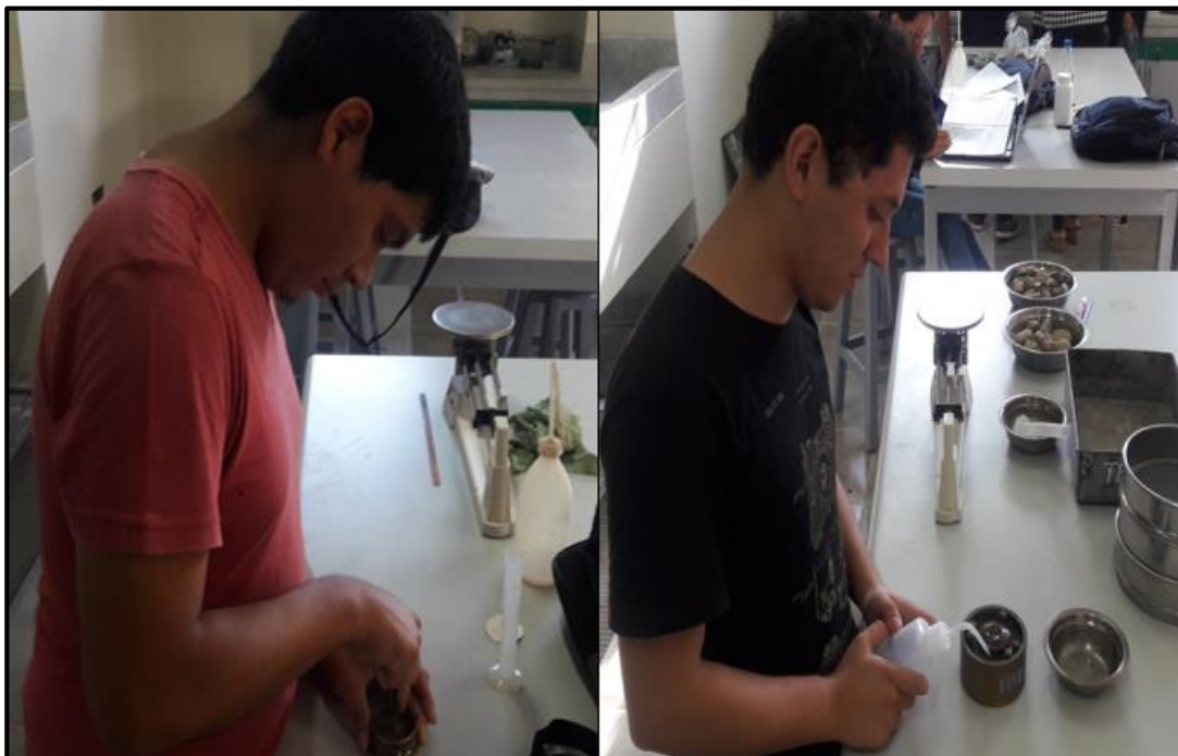
Figura 75. Colocación de las muestras en el tallador metálico y posterior saturación.
