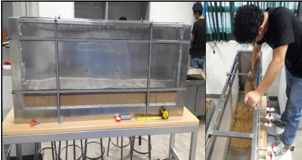
Figura 206. Colocación de la malla metálica (entre los estratos de la cimentación).
