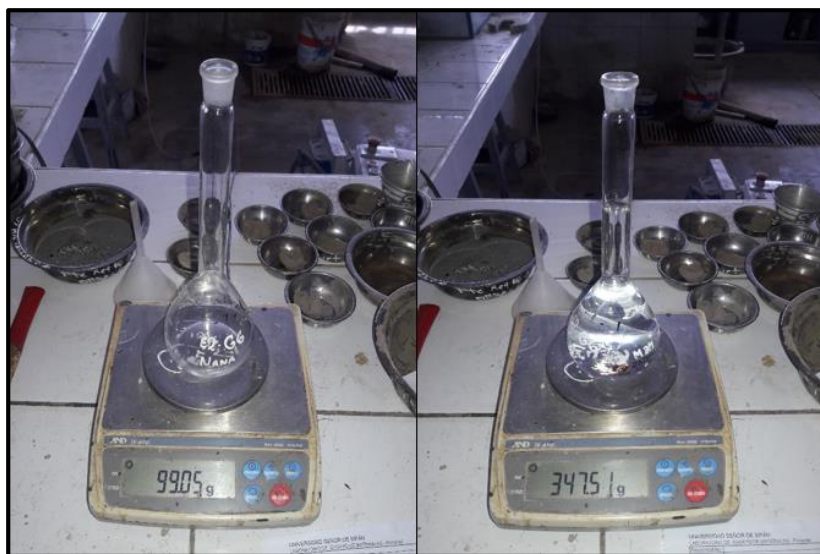
Figura 54. Calibración de la fiola (peso del instrumento sin y con agua).
