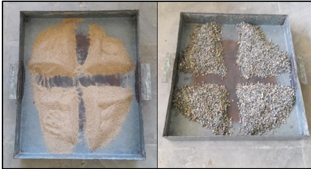
Figura 52. Cuarteo de las muestras (arena gruesa y confitillo).
