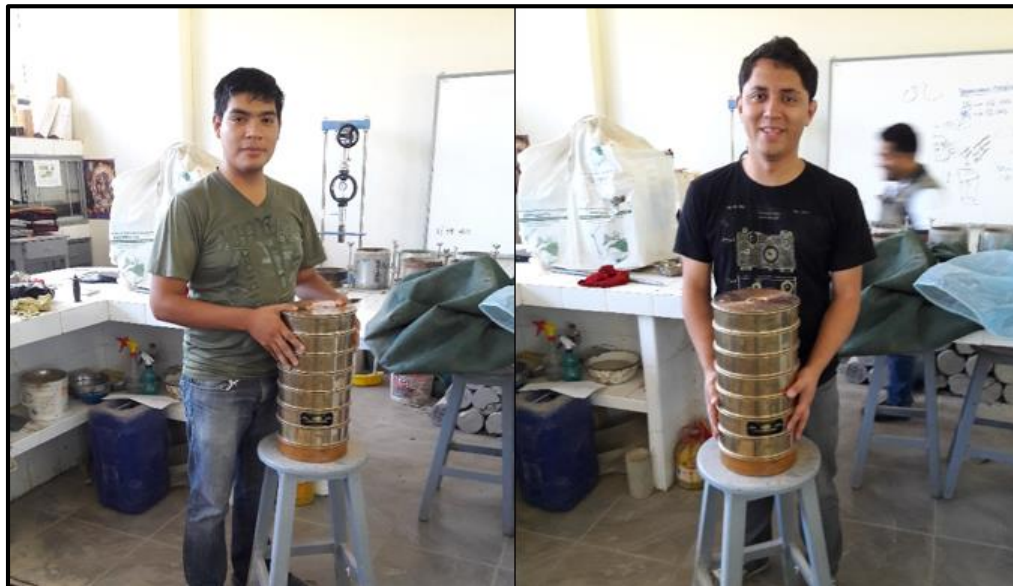
Figura 53. Tamizado de las muestras de suelo.
