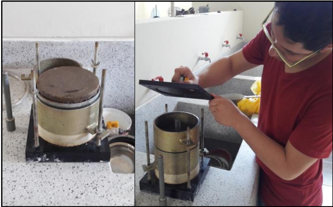
Figura 70. Colocación de la tapa del permeámetro (previa colocación de la piedra porosa).
