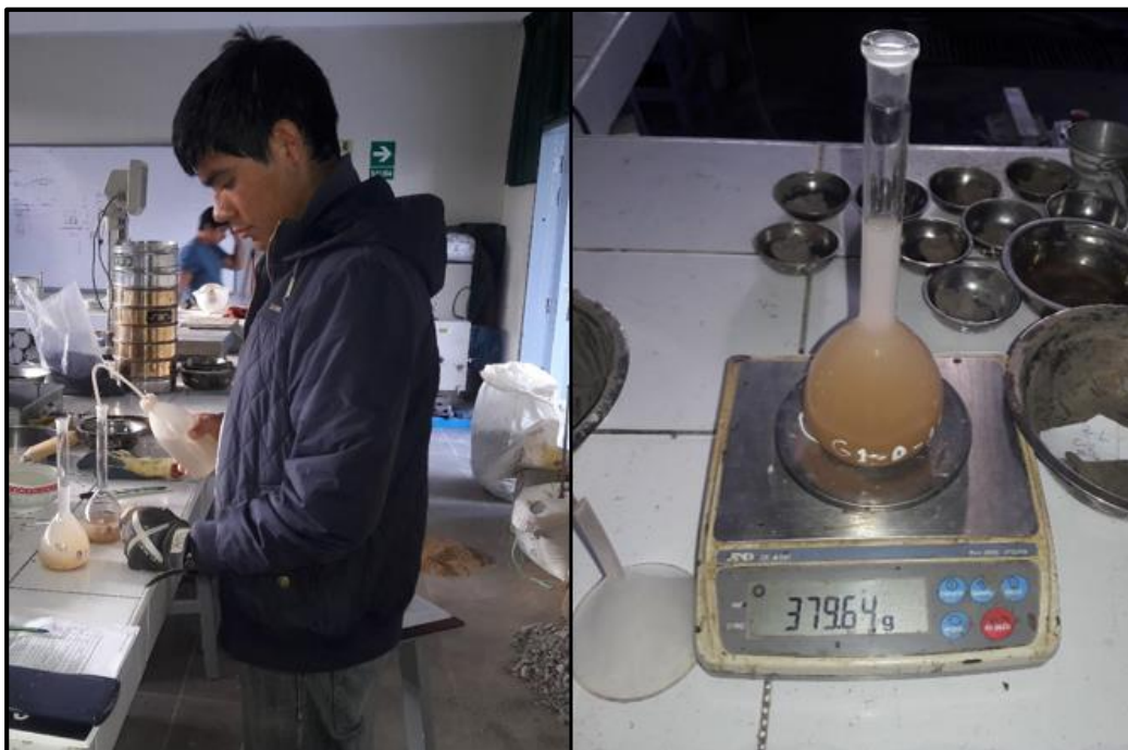
Figura 56. Incorporación de agua hasta el menisco de la fiola.
