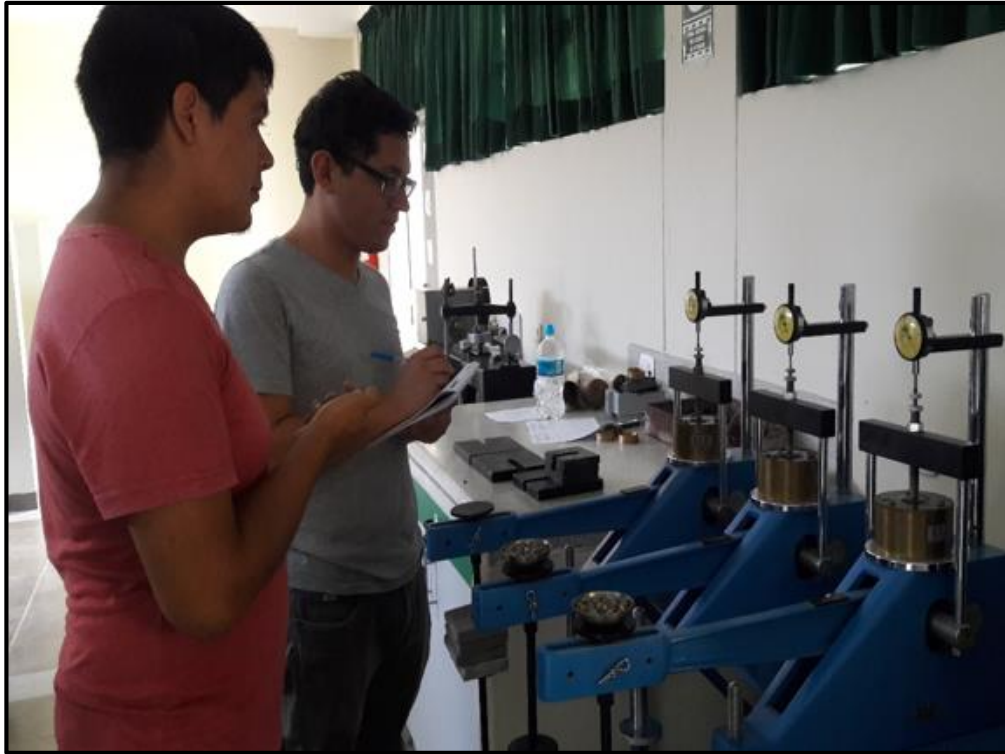
Figura 78. Lectura del deformímetro para cada carga en diferentes intervalos de tiempo.
