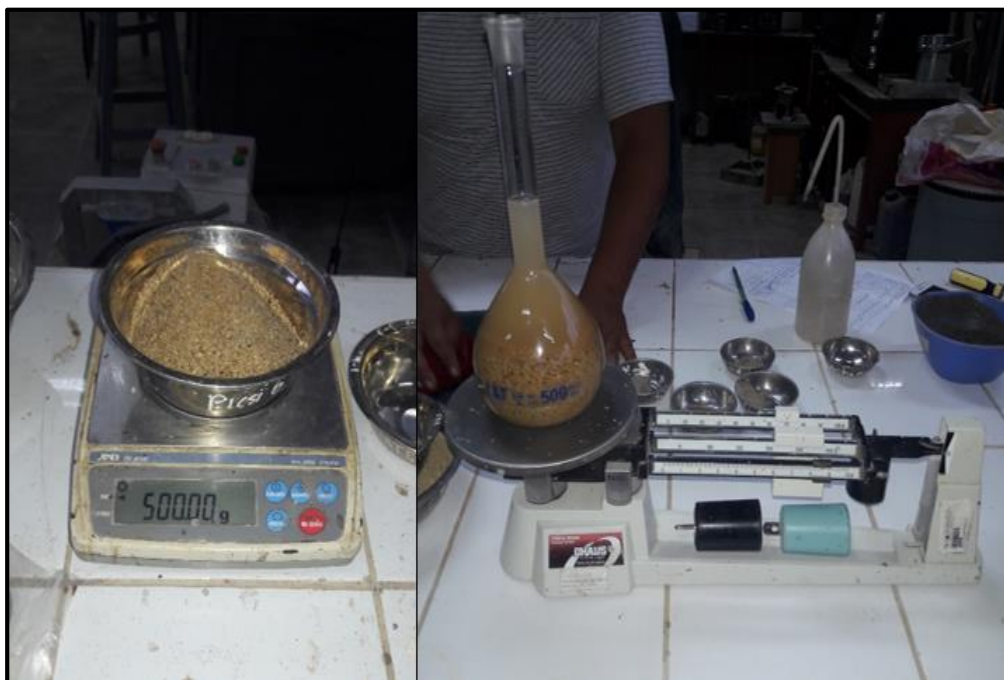
Figura 62. Peso de la muestra dentro de la fiola luego de una agitación leve.
