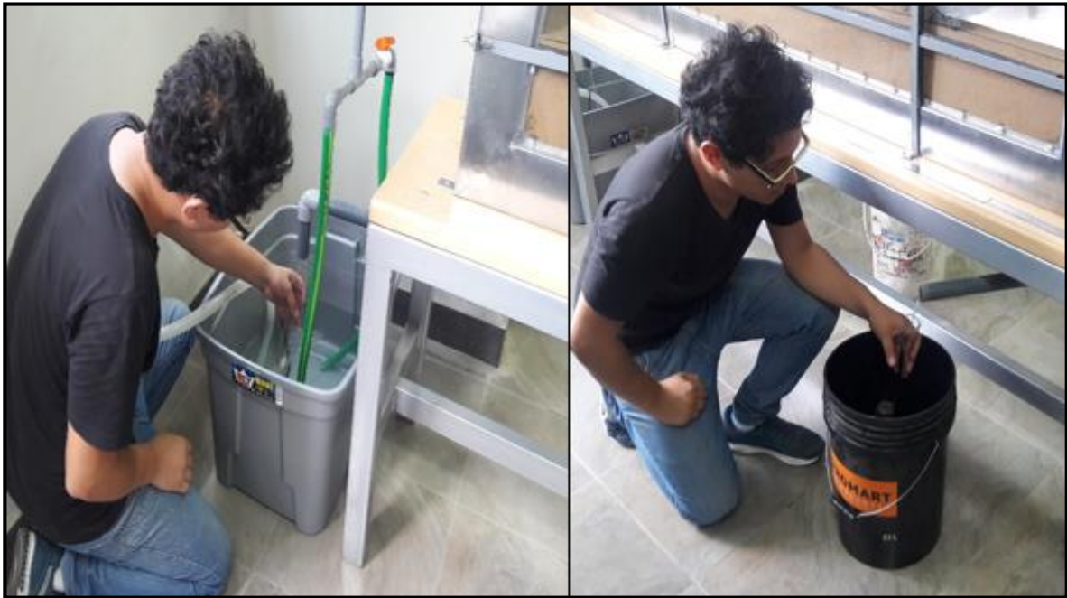
Figura 219. Medición de caudales en los reboses N° 01 y N° 02, mediante el uso de probeta y cronómetro.
