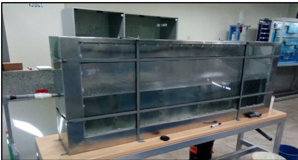
Figura 201. Revisión de fugas y deformaciones horizontales del Equipo de Drenaje.
