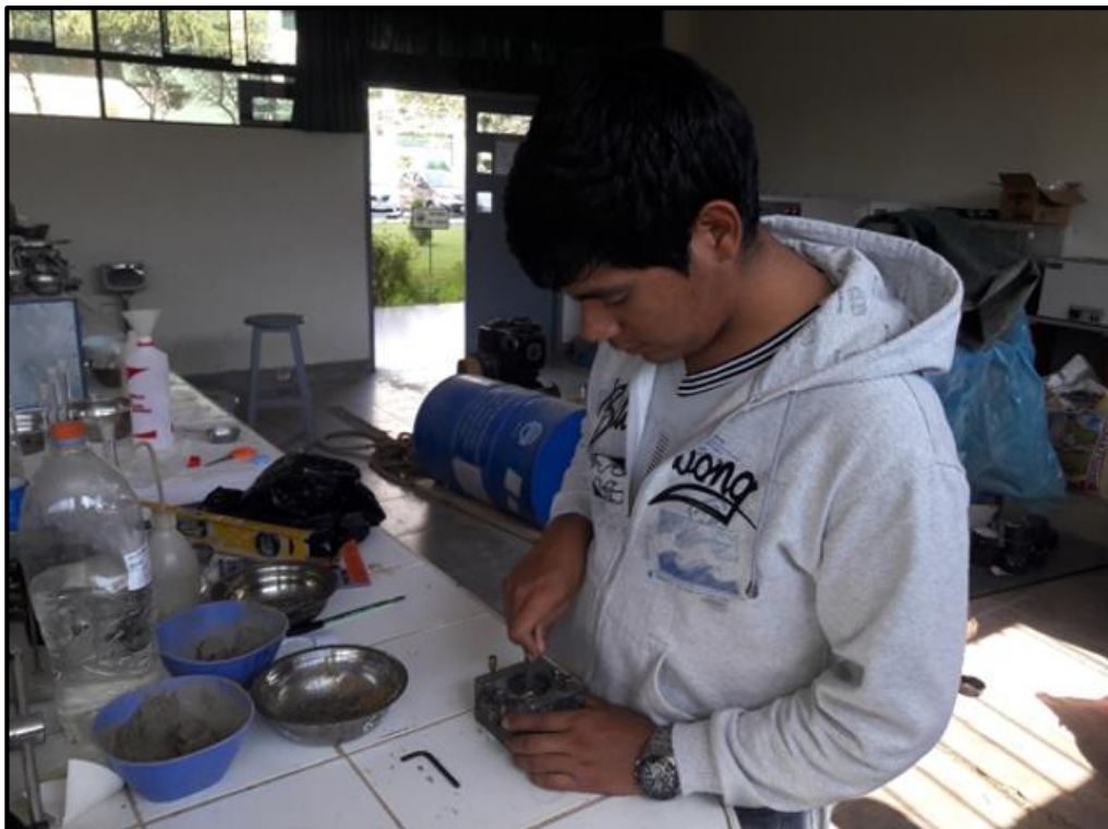
Figura 72. Compactación de la arena (3 capas) dentro del molde de sección circular.
