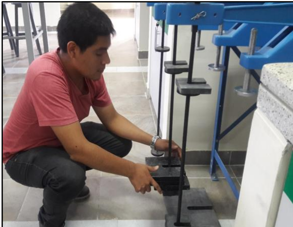
Figura 77. Colocación y/o retiro de pesas metálicas según la carga y descarga.
