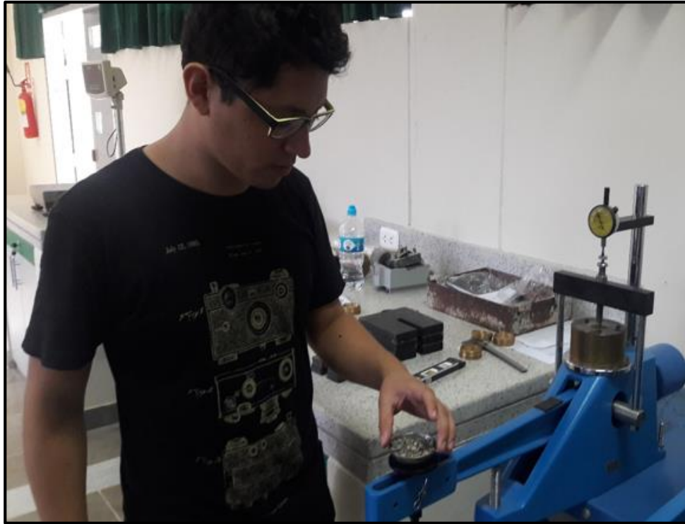
Figura 76. Muestra saturada sometida a una pre-carga de 100 gr. (Duración de 24 hrs).
