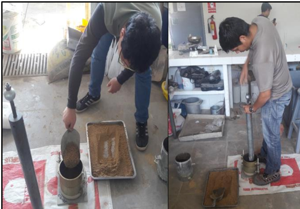
Figura 67. Colocación de la muestra (arena) dentro del molde cilíndrico y apisonado.
