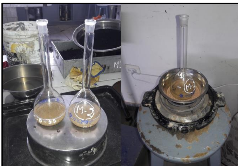
Figura 55. Liberación del aire atrapado en las muestras de arena.
