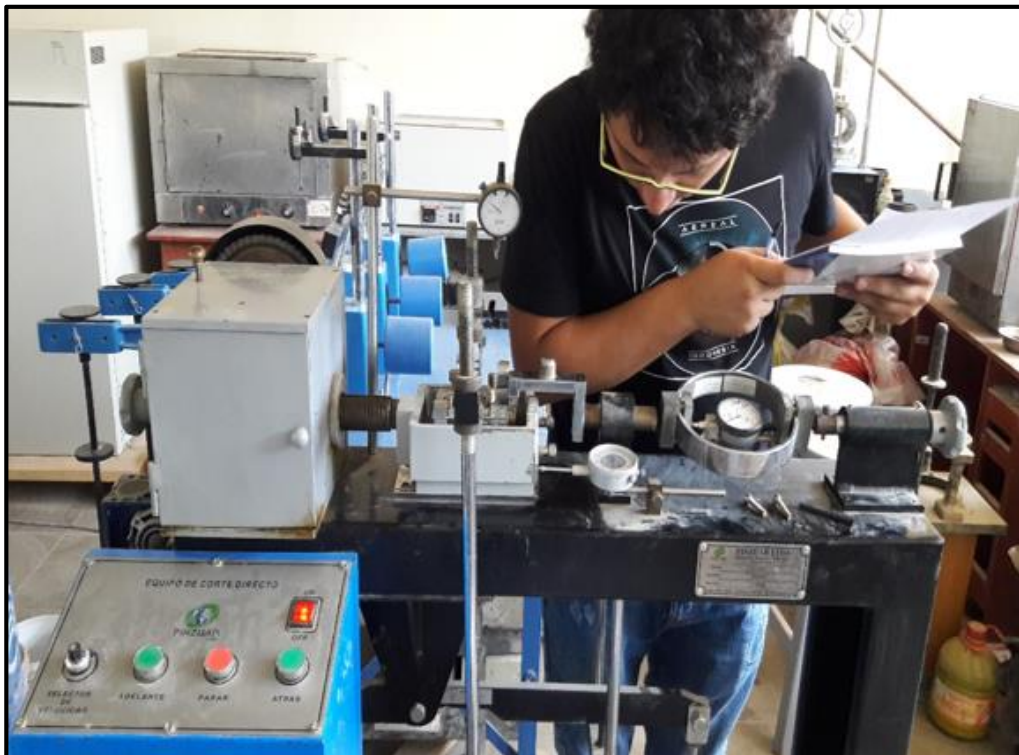
Figura 74. Lecturas en los diales cada cierto tiempo (para una determinada carga aplicada).
