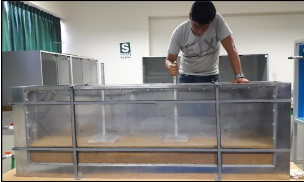
Figura 212. Compactación del estrato superior de cimentación ( e = 3 cm) para un nuevo ensayo.
