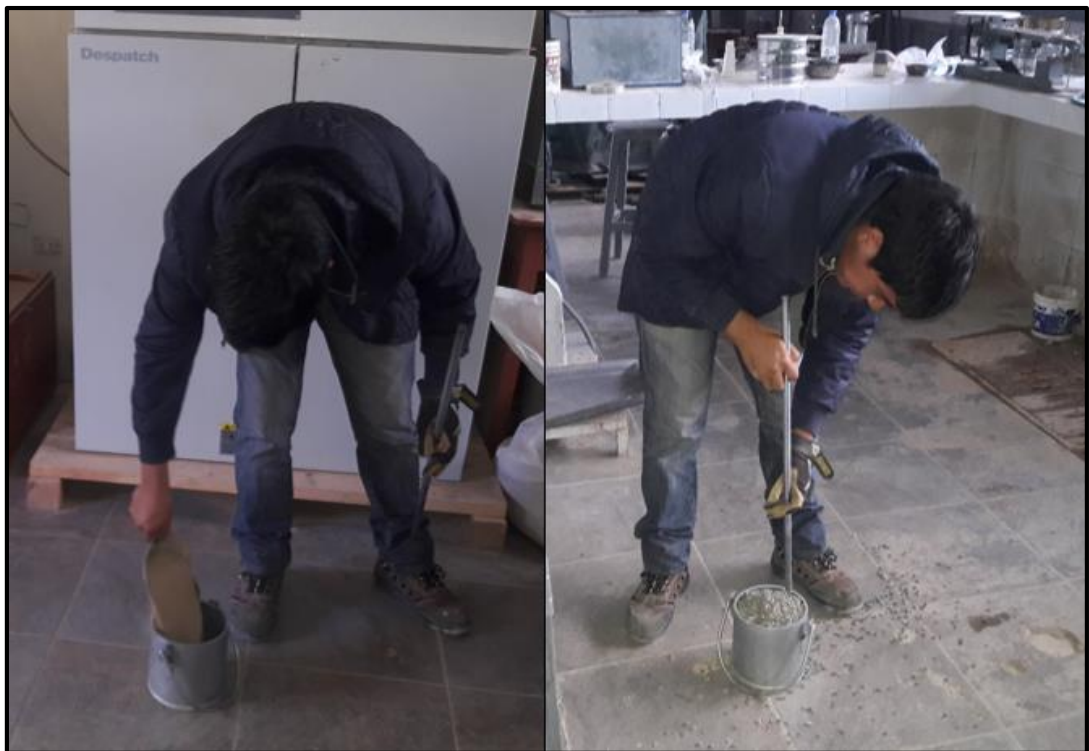
Figura 58. Colocación de los agregados en el molde cilíndrico metálico (Arena / Confitillo).
