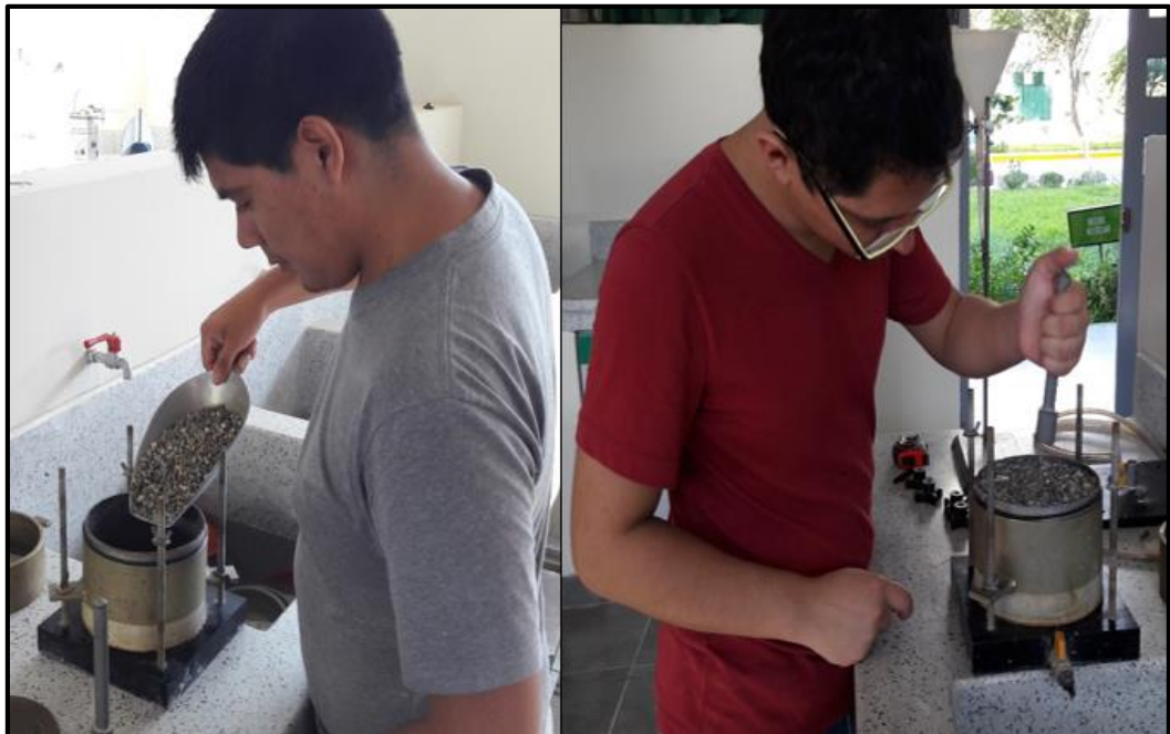
Figura 69. Colocación del confitillo dentro del permeámetro (previa compactación con un pequeño pisón metálico).
