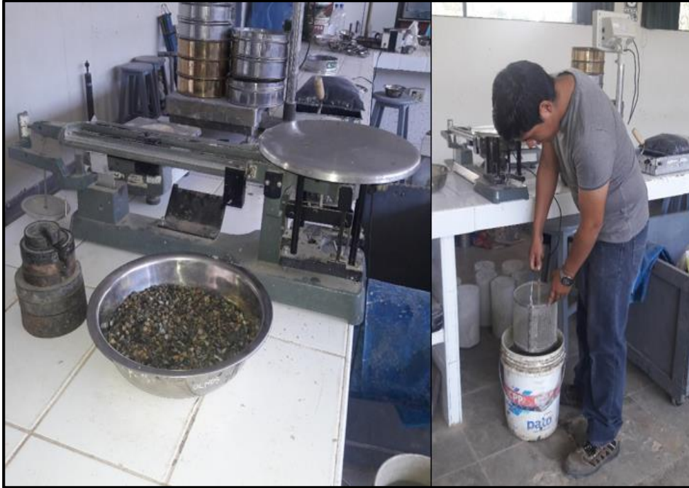
Figura 64. Ingreso de la canastilla con confitillo en el recipiente lleno de agua.
