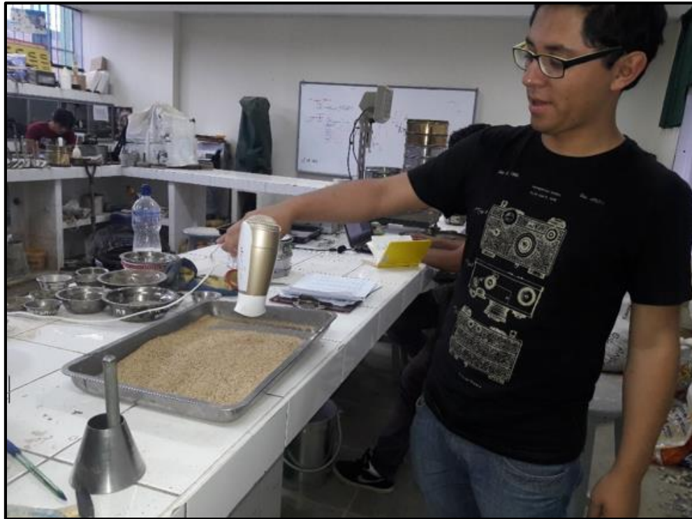
Figura 60. Oreado de la muestra de arena con el uso de una secadora.
