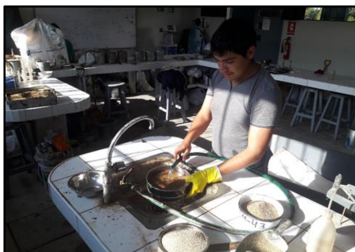
Figura 48. Arena sometida a lavados sucesivos a través de la malla N° 40.
