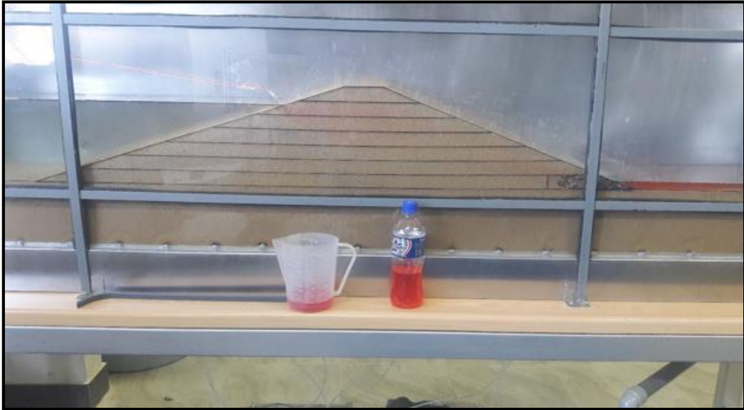
Figura 221. Línea de saturación ligeramente visible con el uso de suero.
