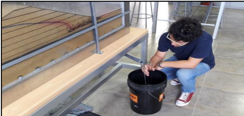
Figura 228. Medida del volumen de agua saliente en la tubería de rebose #2 ubicada aguas abajo de la presa.
