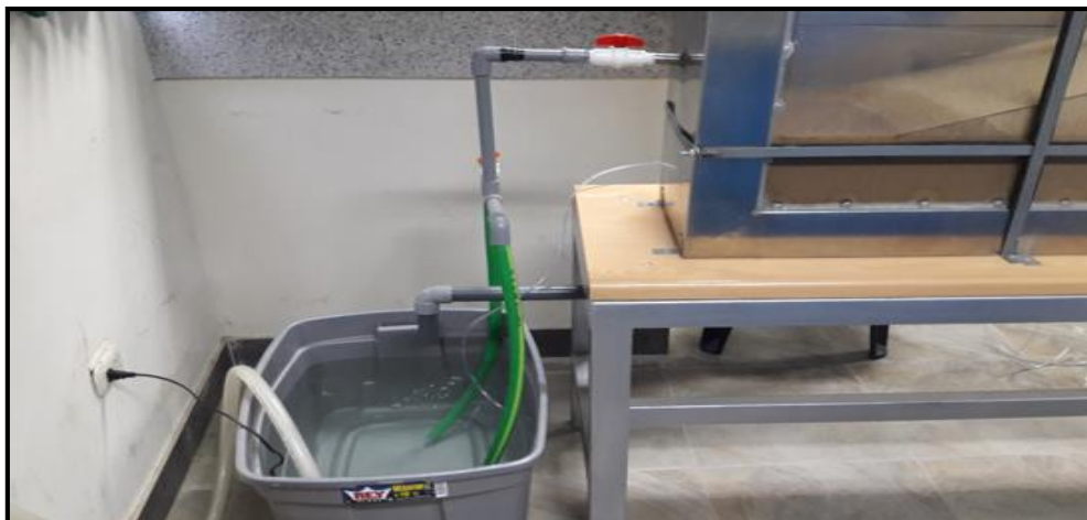
Figura 209. Control del caudal de ingreso durante el primer llenado de presa (1er predimensionamiento).
