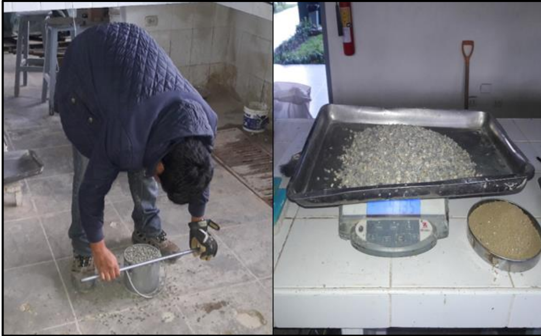
Figura 59. Enrasado de los agregados en el molde cilíndrico metálico, para luego determinar su peso (Confitillo).
