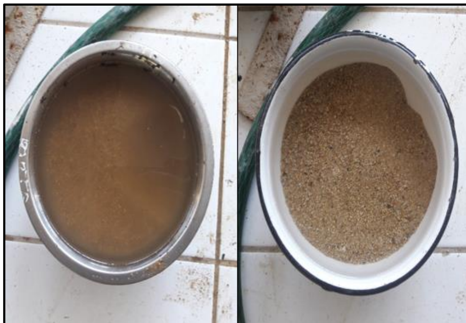
Figura 49. Apariencia del agua en contacto con la arena, antes (turbia) y después (cristalina) de los lavados sucesivos.
