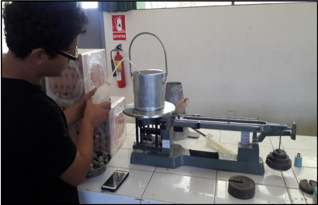
Figura 57. Calibración del molde cilíndrico metálico.
