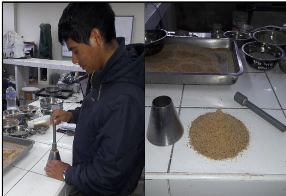
Figura 61. Apisonado de la muestra (arena) dentro del molde cónico.
