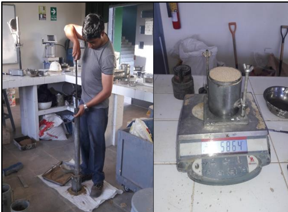
Figura 66. Apisonado de la muestra (arena) dentro del molde cilíndrico, para determinar su peso.
