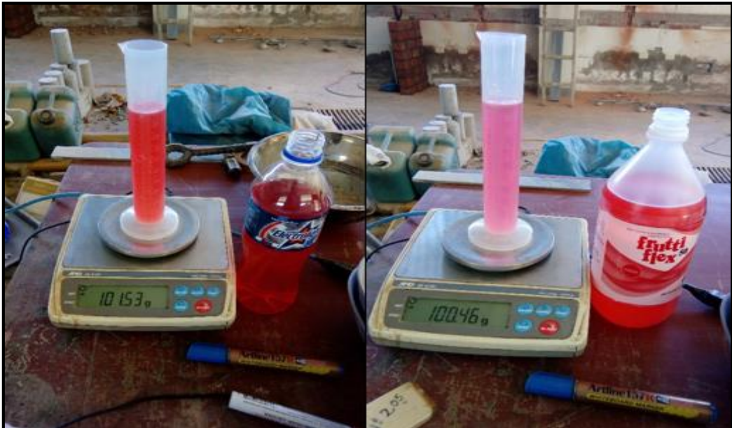
Figura 222. Ensayo de densidad aplicado al tinte rojo a base de suero.
