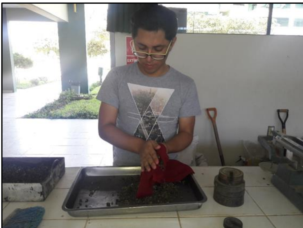
Figura 63. Secado de la superficie del confitillo saturado con el uso de una franela.
