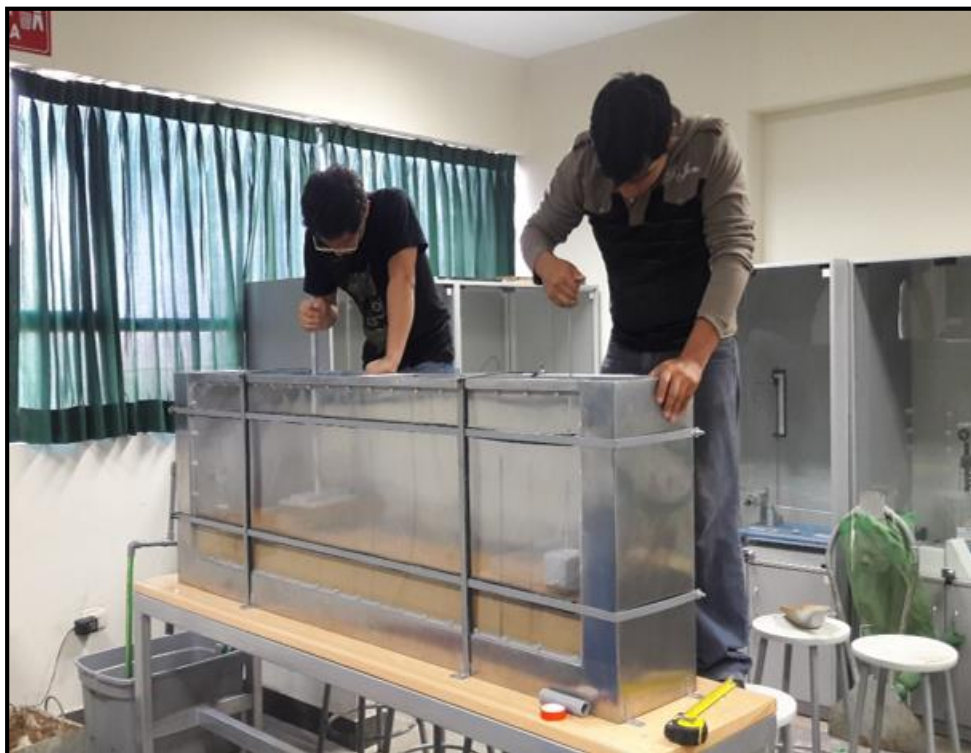
Figura 205. Compactación del material de cimentación (estrato superior: arena lavada).
