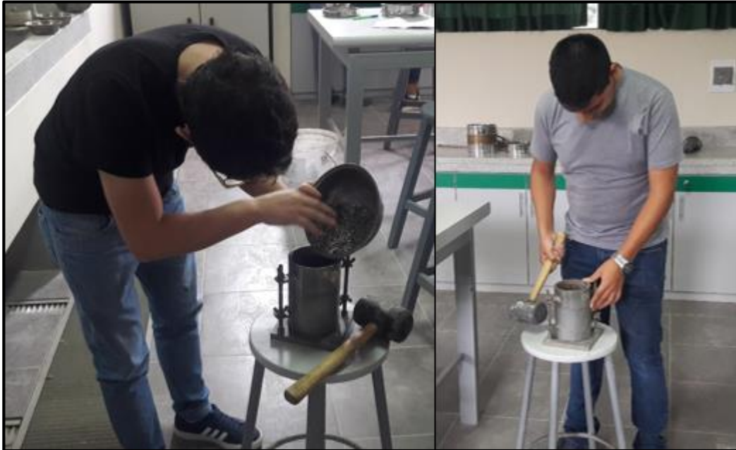
Figura 79. Colocación de la muestra (confitillo) dentro del molde cilíndrico.
