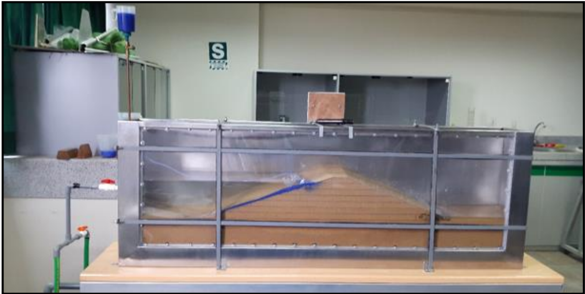
Figura 217. Intento fallido del suministro de tinte azul (diluido en agua) en el cuerpo de la presa.
