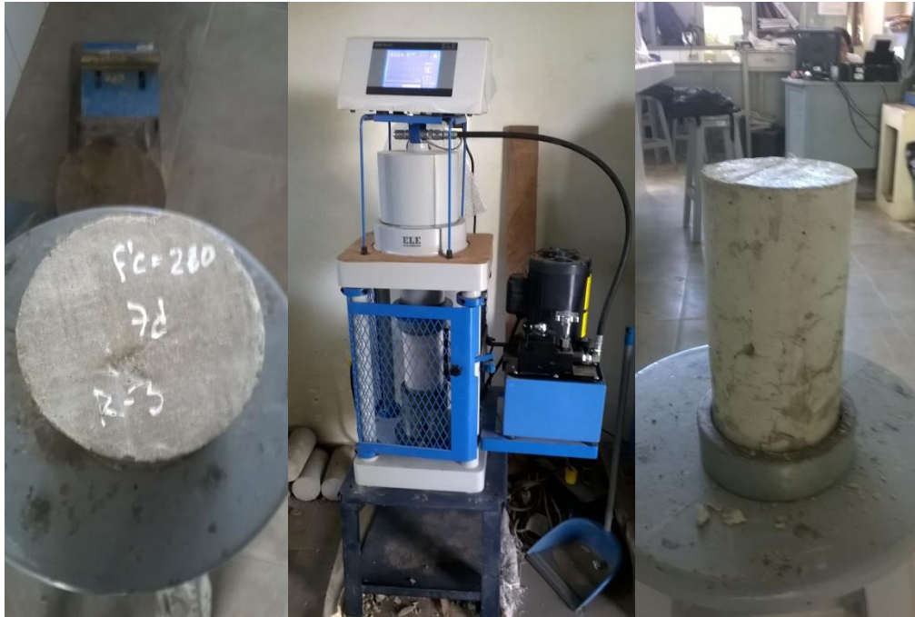
Foto 19: Codificación – Prueba de Compresión – Fisura de las Probetas.
