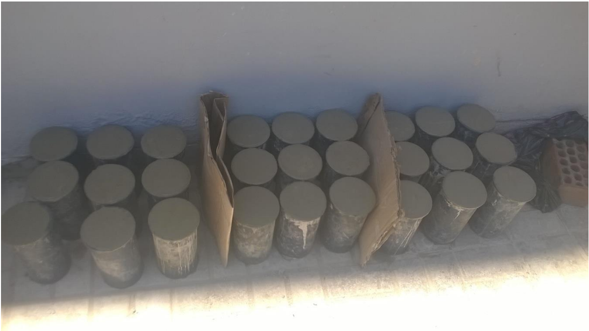
Foto16: Mezcla vaciada en los Moldes Cilíndricos.
