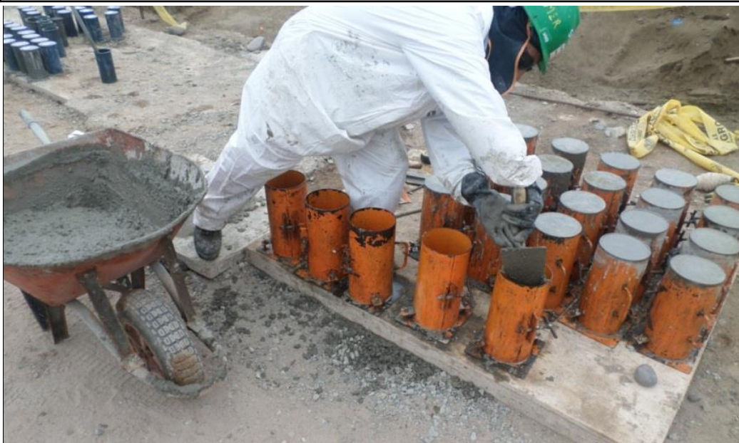
Figura 1: Llenado de probetas metálicas cilíndricas en obra.
