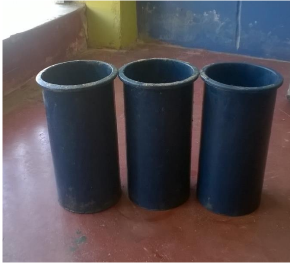
Foto 14: Moldes a Utilizar Cilíndricos 10cm * 20cm.
