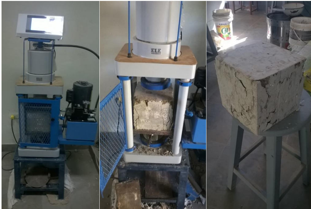
Foto 28: Fracturación de las probetas.
