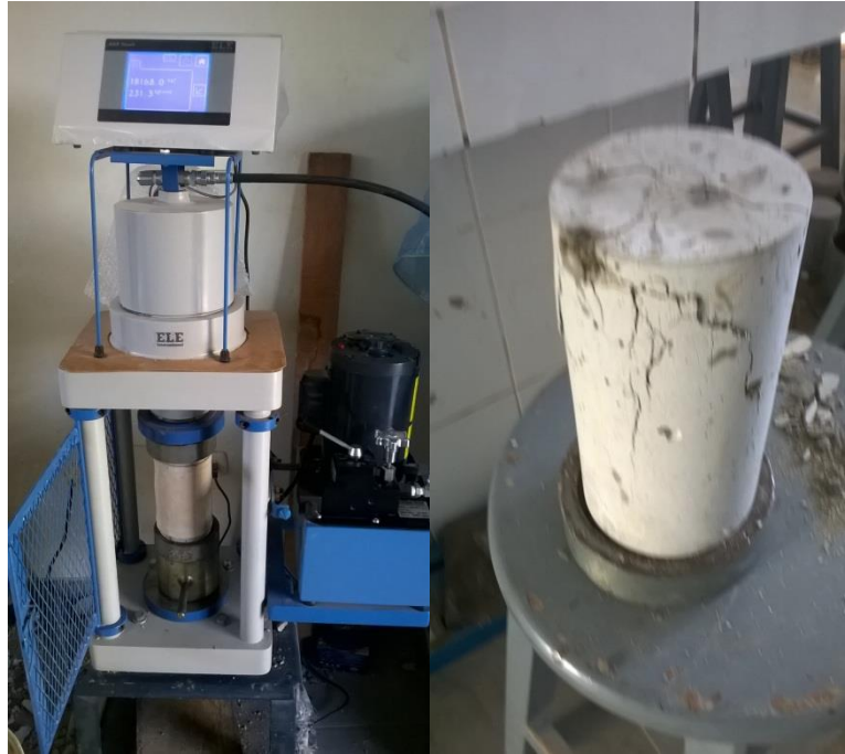
Foto 23: Ensayo a compresión – Fractura de la Probeta.
