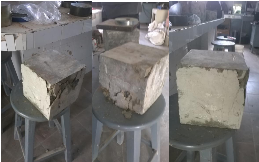
Foto 25: Fracturación de la Probeta Cúbica.
