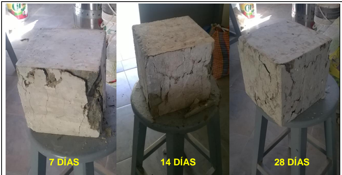
Figura 29: Proceso de Fracturación en Probetas Cúbicas vs Día de ensayo.
