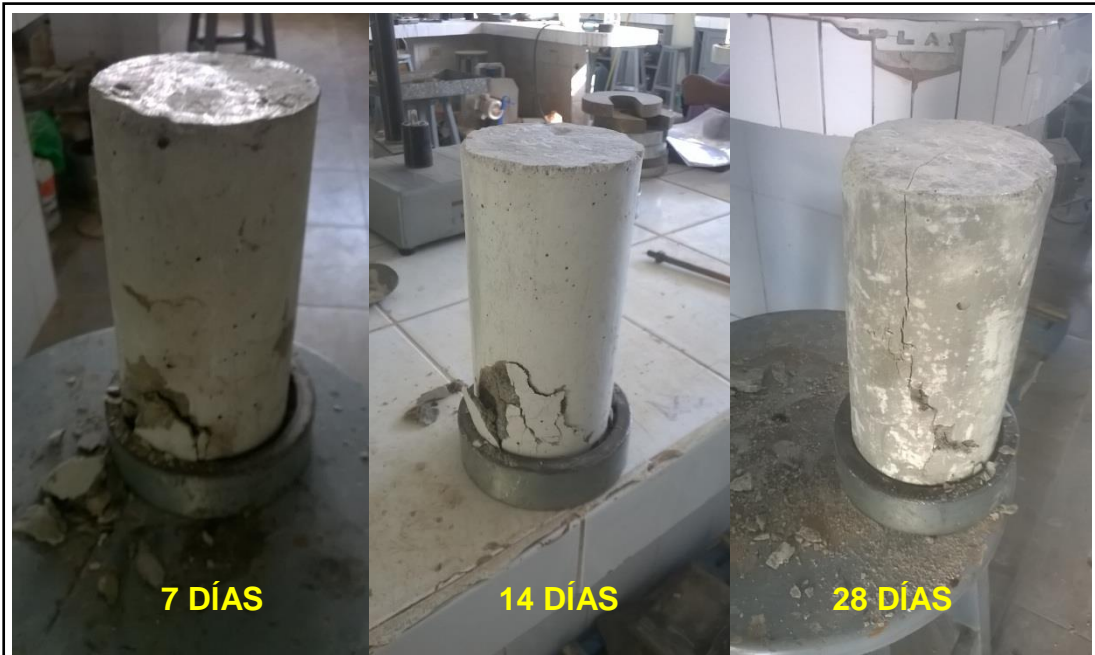
Figura 28: Proceso de Fracturación en Probetas Cilíndricas vs Día de ensayo.
