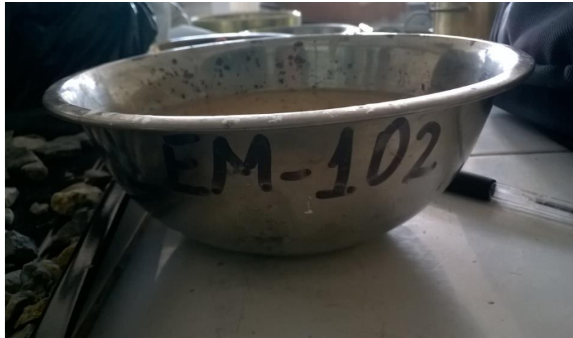
Foto 5: Muestra de Ag Fino para ensayo de Peso Especifico
