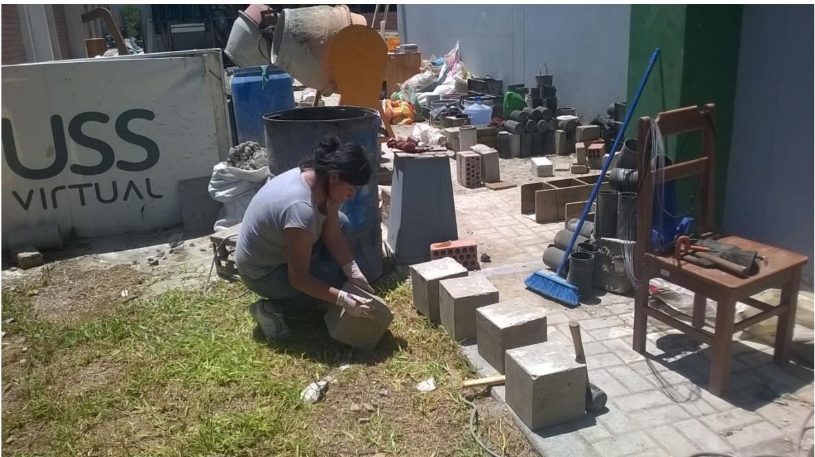
Foto 17: Etiquetado de los moldes Cúbicos.
