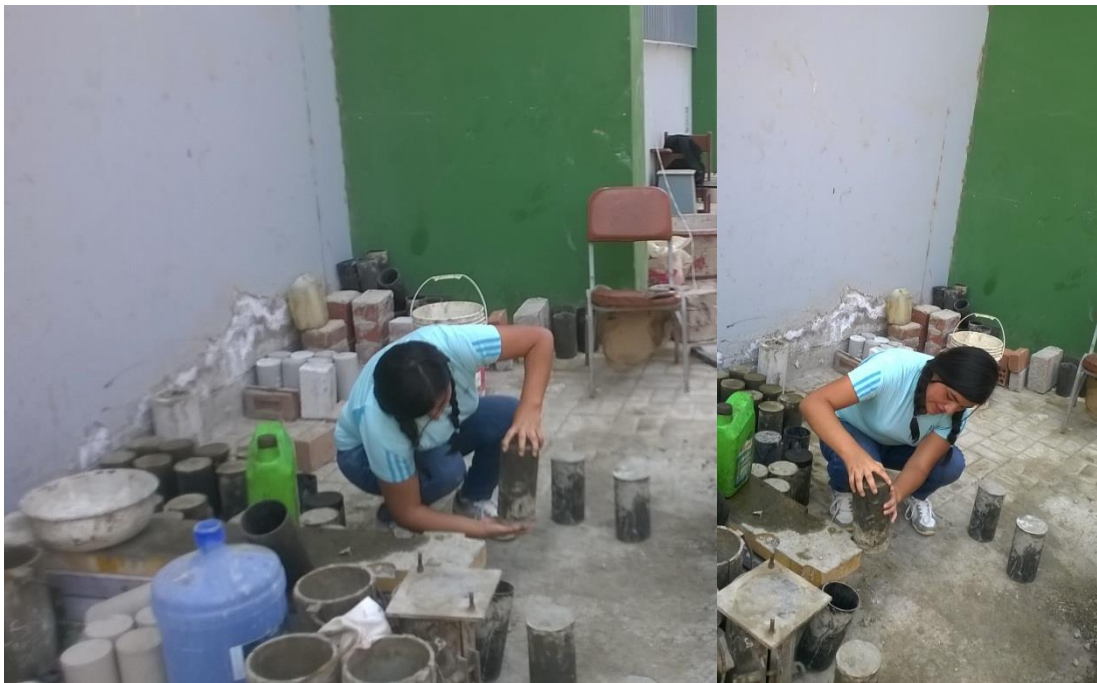
Foto 9: Desmoldado de las Probetas de Prueba.
