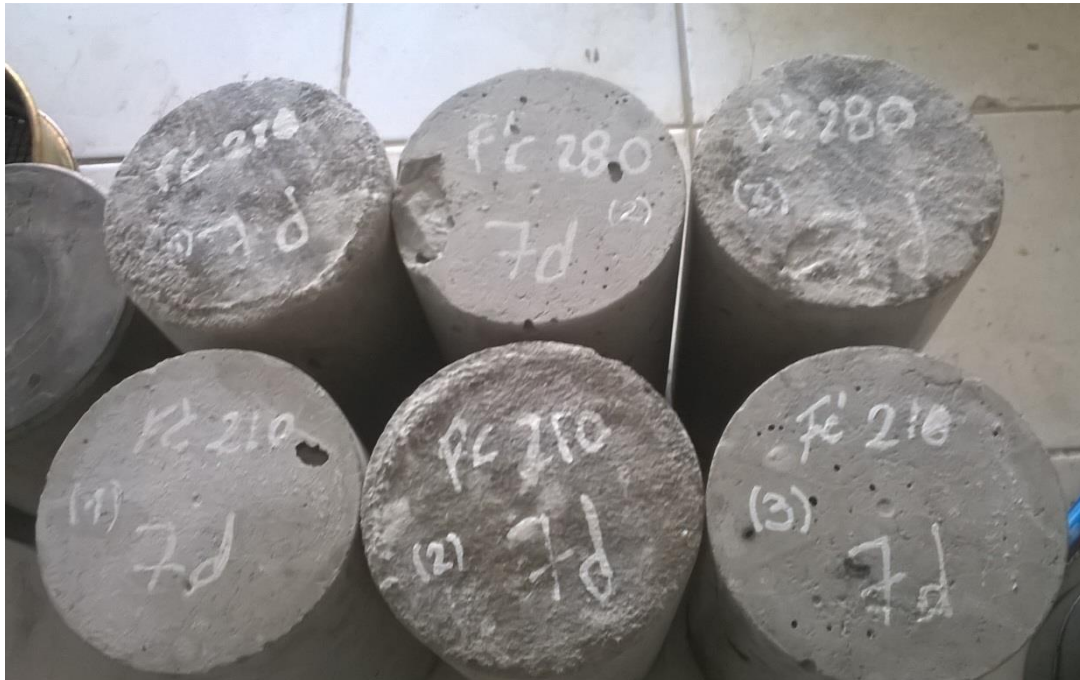
Foto 11: Comprobación de 70\% \pm 5\% de Resistencia de diseño.
