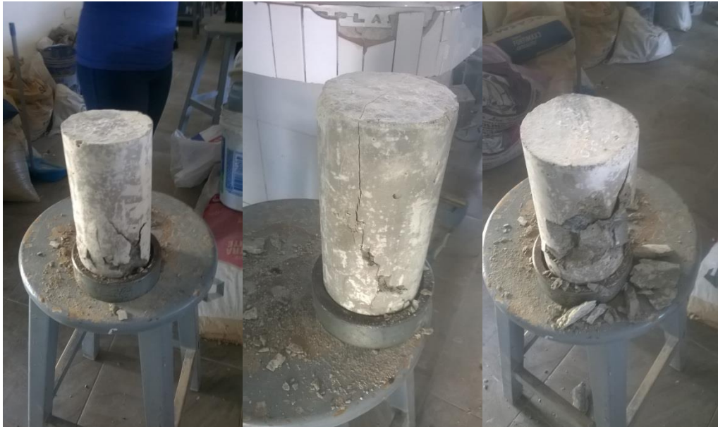
Foto 27: Fracturación de las probetas.
