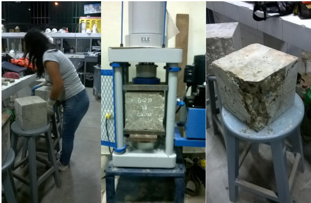
Foto 20: Selección de la cara más lisa - Prueba de Compresión – Fractura.
