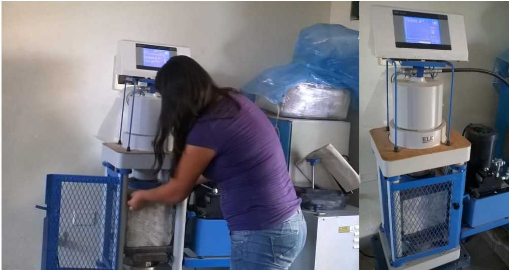
Foto 26: Verificando que las Paredes no hagan contacto con la Prensa.
