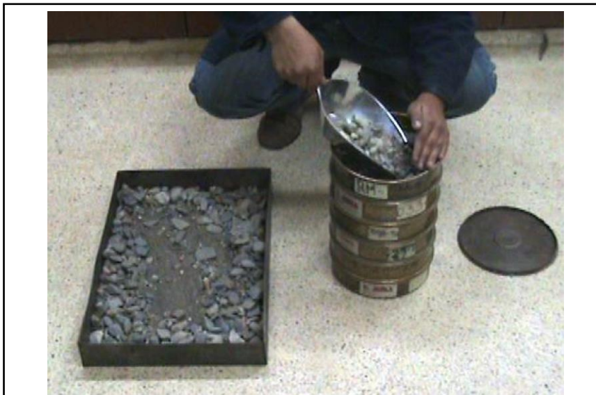
Figura 16: Colocar las muestras desde la parte superior
