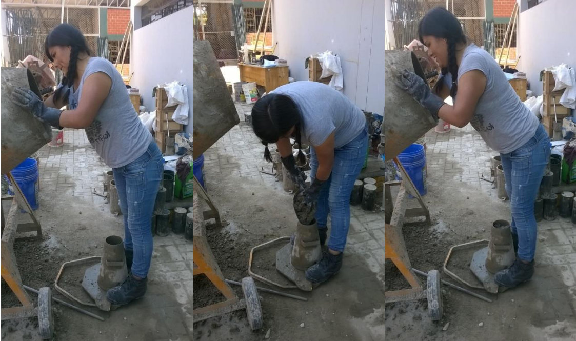
Foto 8: Ensayo para la medición del Asentamiento – Cono Abrams.
