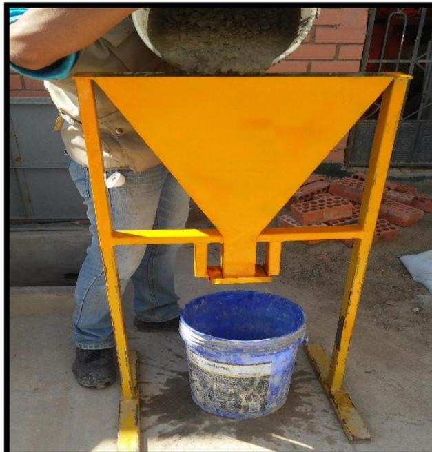
**Figura 15:** Vertido de CAC al interior del recipiente en forma de embudo.
