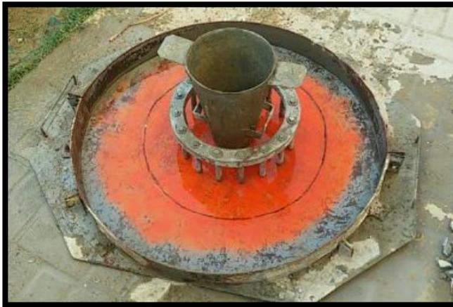
**Figura 12:** Equipo para Ensayo de J – Ring, o Anillo Japonés
