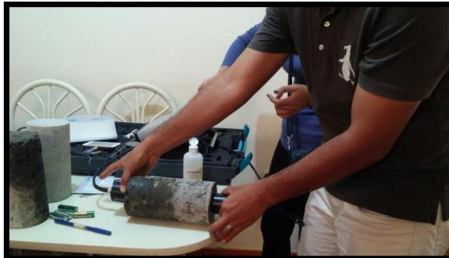
**Figura 27:** Se procede con el ensayo de Ultrasonido respectivo para el concreto.
