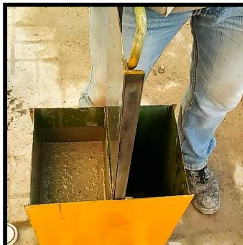
**Figura 23:** Apertura de compuerta de la caja en U, evaluación de capacidad de paso.
