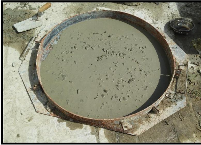
**Figura 10:** CAC probado en Ensayo de Extensibilidad de Flujo
