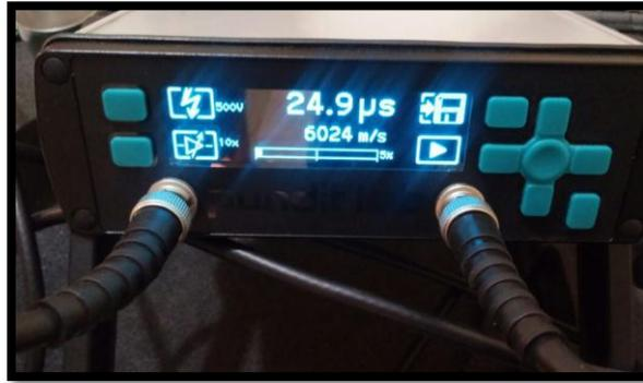
**Figura 31:** Resultado de velocidad (m/s) y tiempo (microsegundos) de probeta B-1 de 280 kg/cm<sup>2</sup>. Trabajado con ag. Grueso de ¾".
