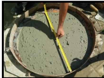
**Figura 11:** Se tomó las medidas de la extensibilidad en forma transversal y longitudinal.
