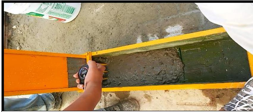
**Figura 19:** Toma de tiempo con cronómetro para 40 cm de canal, evaluación de capacidad de relleno.
