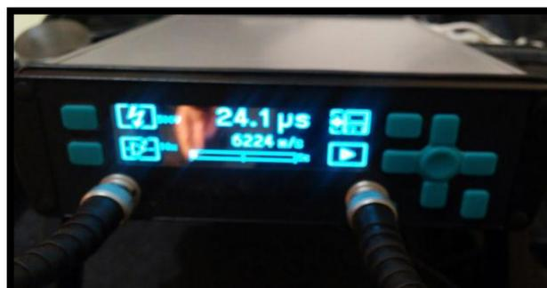
**Figura 30:** Resultado de velocidad (m/s) y tiempo (microsegundos) de probeta de 500 kg/cm<sup>2</sup> trabajado con ag. Grueso de 3/4".
