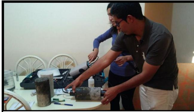
**Figura 28:** Procedimiento de detección de ondas de sonido para el concreto.
