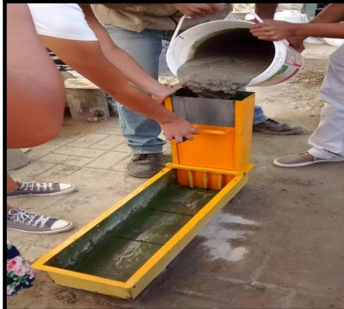
**Figura 17:** Vertido de CAC al interior de la columna de la caja en sentido vertical.
