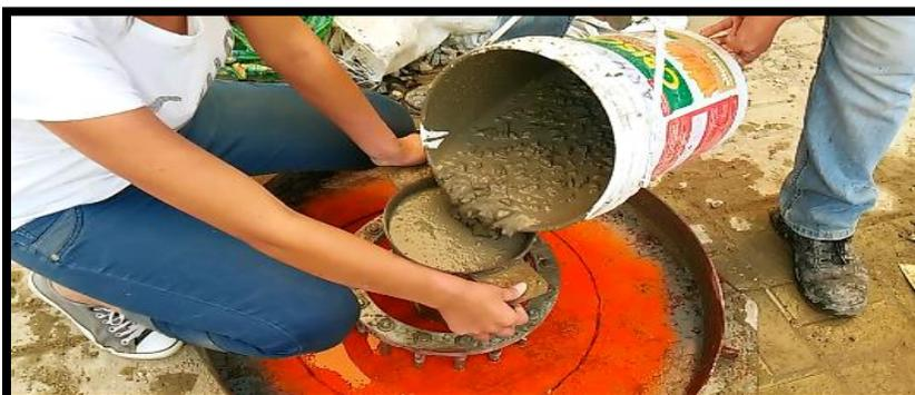
**Figura 13:** CAC vertido al interior de Cono de Abrams para desarrollo de ensayo.
