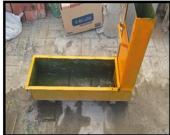
**Figura 16:** Caja “L” en diferentes ángulos comprendida por una columna vertical y un canal horizontal.
