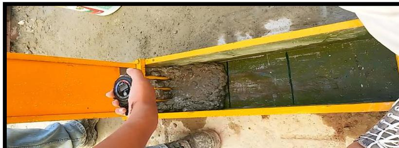
**Figura 18:** Toma de tiempo con cronometro para 20 cm de canal, evaluación de capacidad de relleno.
