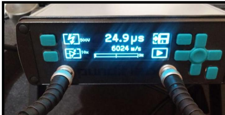
**Figura 32:** Resultado de velocidad (m/s) y tiempo (microsegundos) de probeta B-2 de 280 kg/cm<sup>2</sup> trabajado con ag. Grueso de ¾".
