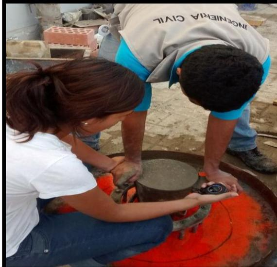
**Figura 14:** El CAC se deja reposar por unos segundos para luego retirar en Cono para observar la capacidad de paso y relleno con la que trabaja.
