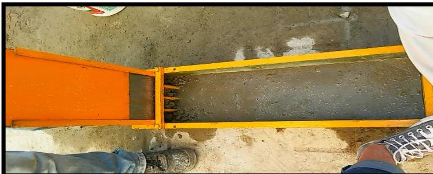
**Figura 20:** Visualización de CAC vertido en todo el tramo del canal, se procede a verificar después la relación de bloqueo tomando medidas en ambos extremos de la caja.
