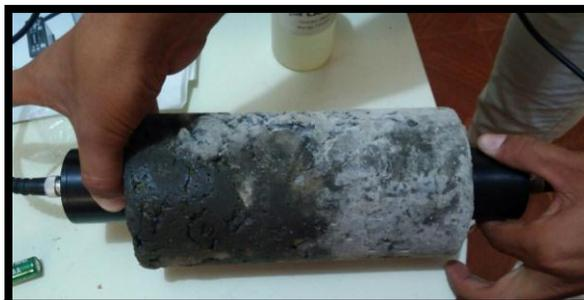
**Figura 29:** Probeta de CAC con  $f'c = 500$  kg/cm<sup>2</sup> pasando por la prueba de ultrasonido.
