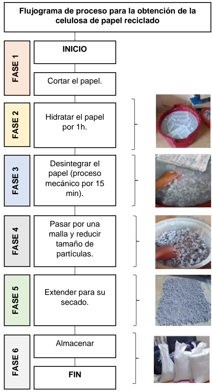
Fig. 5. Flujograma de proceso para la obtención de la celulosa de papel reciclado.
