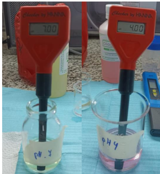
Figura 1: Calibración del pH metro digital marca HANNA modelo HI 98310 con las soluciones de calibración.
