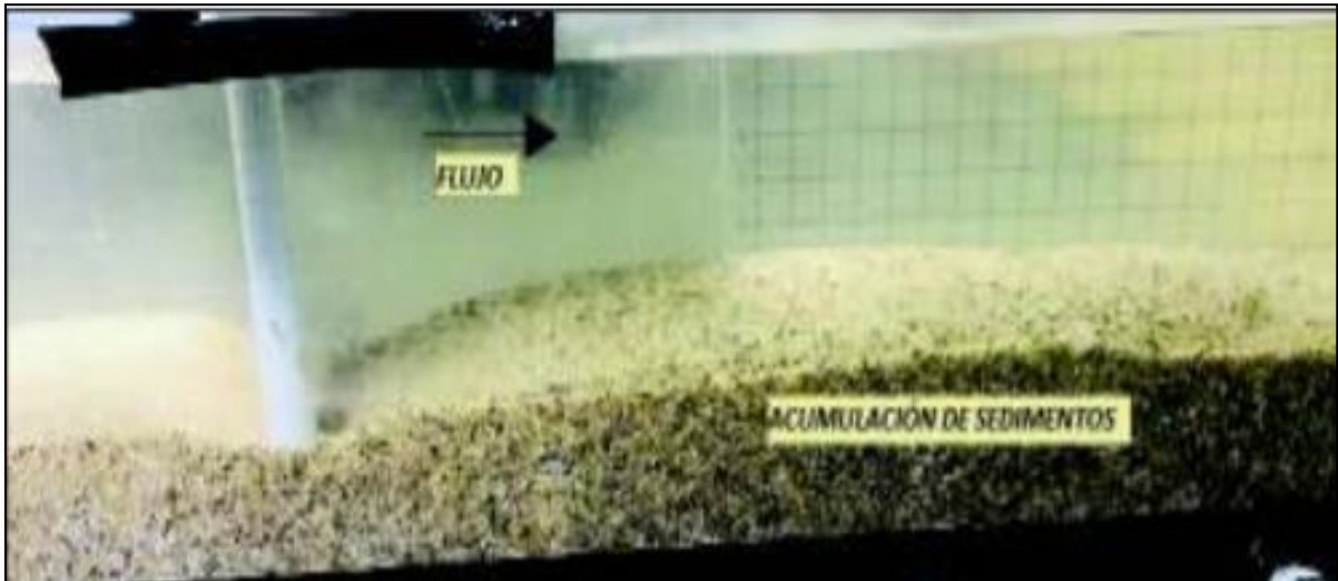
Figura 5 Acopio y acumulación de sedimentos aguas abajo en los límites del pilar. [27]
