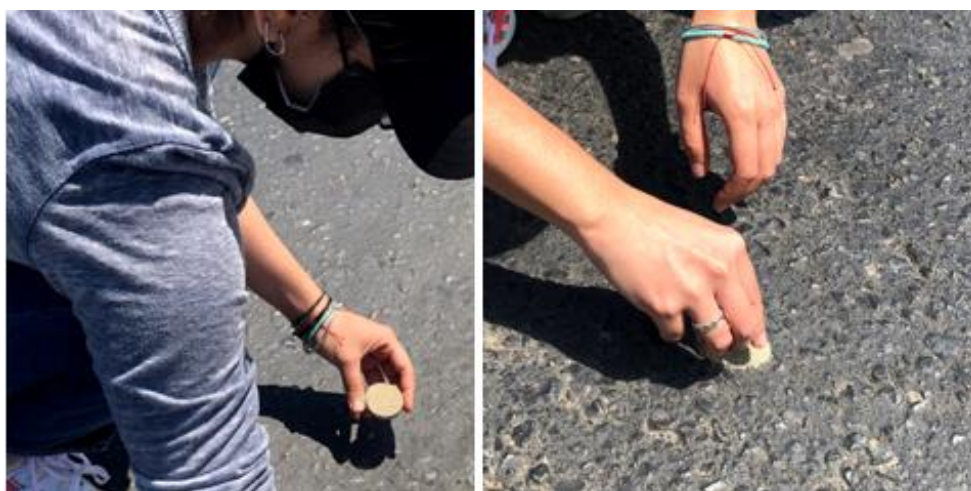
Fig. 26. Paso 2 del ensayo del círculo de arena
