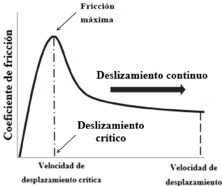
Fig. 12. La relación entre la fricción del pavimento y la velocidad de deslizamiento. [67]
