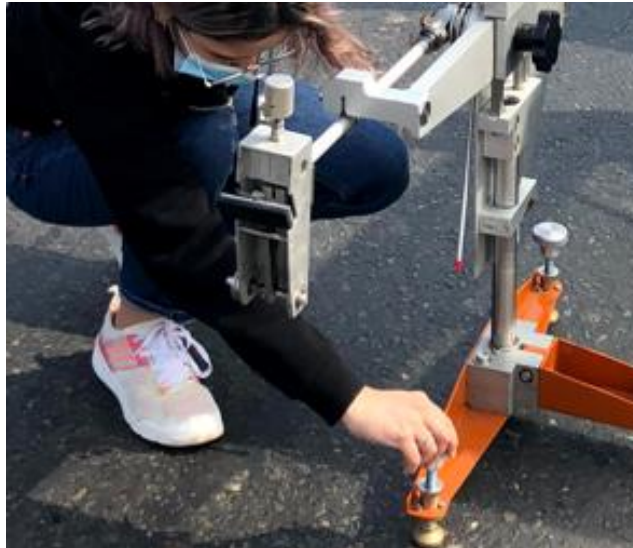
Fig. 19. Paso 1 del ensayo del Péndulo británico TRRL
