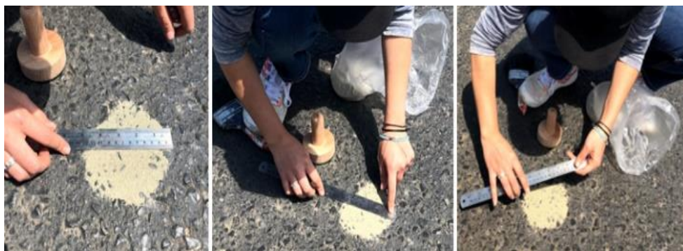
Fig. 28. Paso 4 del ensayo del círculo de arena
