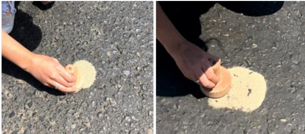
Fig. 27. Paso 3 del ensayo del círculo de arena
