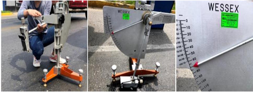
Fig. 23. Paso 5 del ensayo del Péndulo británico TRRL
