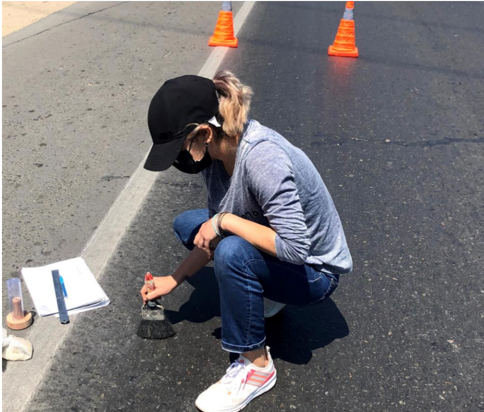
Fig. 25. Paso 1 del ensayo del círculo de arena
