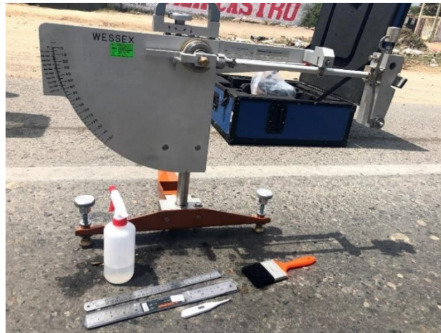
Fig. 18. Péndulo británico TRRL y equipo secundario
