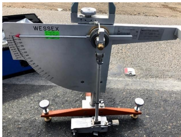
Fig. 20. Paso 2 del ensayo del Péndulo británico TRRL
