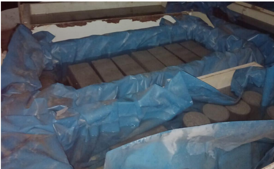
Figura .24 Curado de cilindros y vigas
