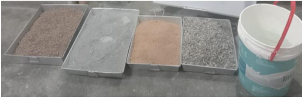
Fig. 12. Diseño de Mezcla del Concreto Patrón
