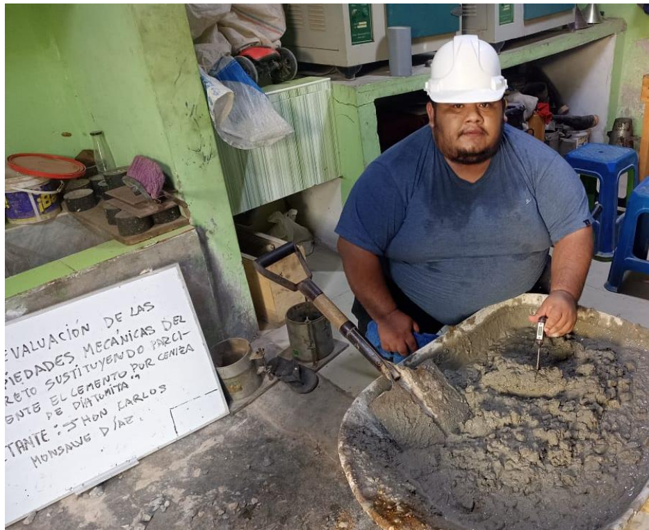
FOTO 12: Temperatura de concreto concreto patrón.
