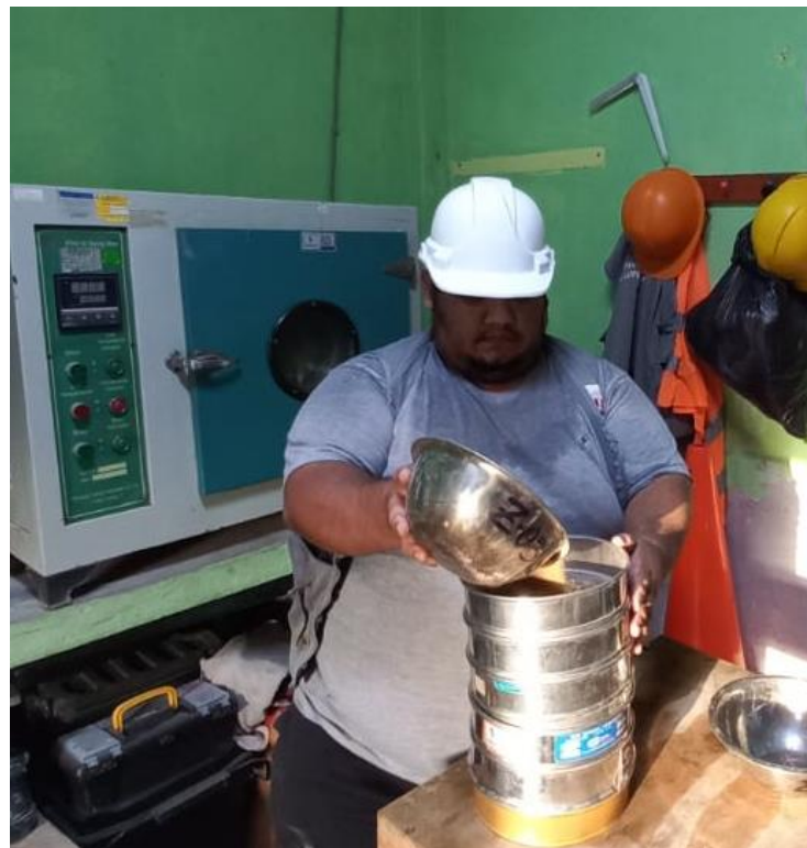
FOTO 04: Tamizado de agregado fino.
