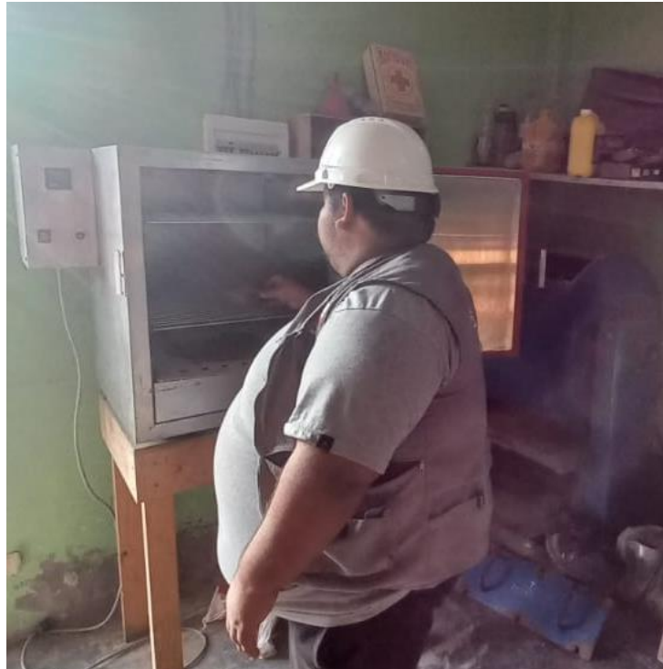
FOTO 05: Muestras al horno para contenido de humedad.
