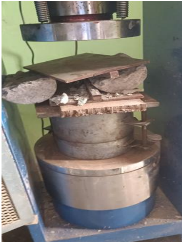
FOTO 23: Roturas para la resistencia a la tracción.
