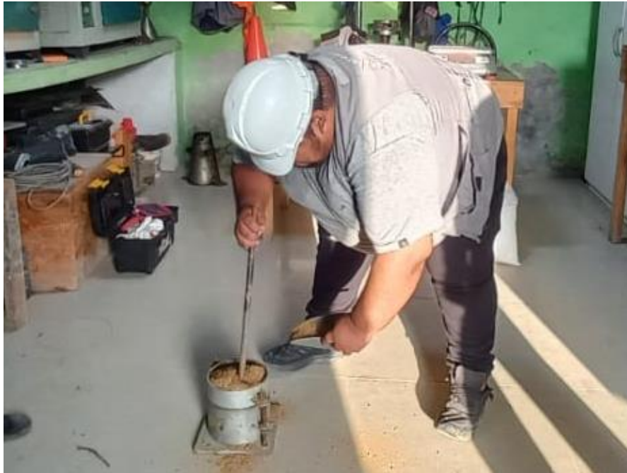
FOTO 07: Peso unitario suelto y compactado del agregado fino.
