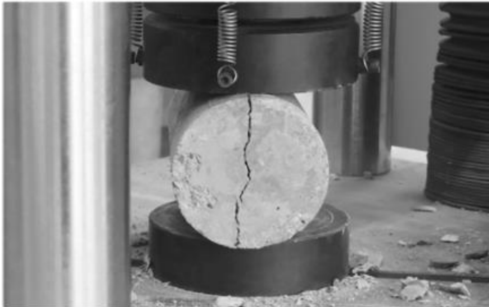
Fig. 2. Ensayo de Tracción en probeta cilíndrica. [55]
