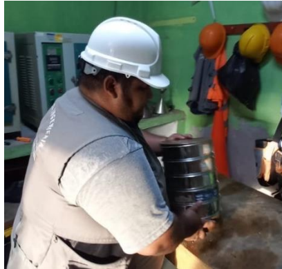
Fig. 9. Tamizado de los áridos pétreos
