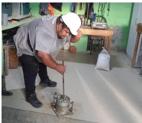
Fig. 10. Realización del peso unitario compactado del árido
