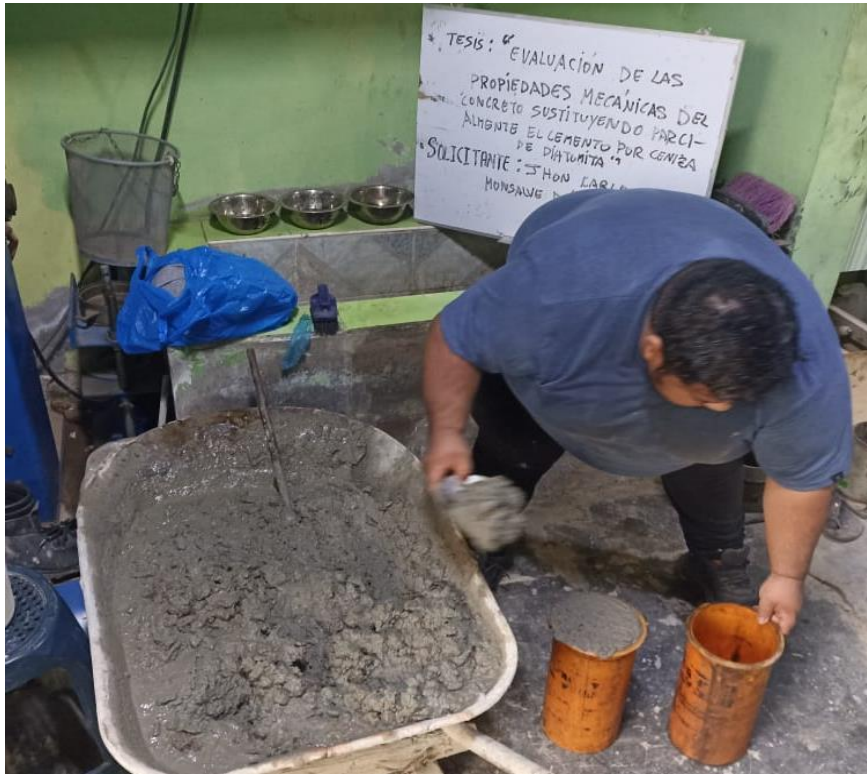
FOTO 15: Llenado de probetas cilíndricas.
