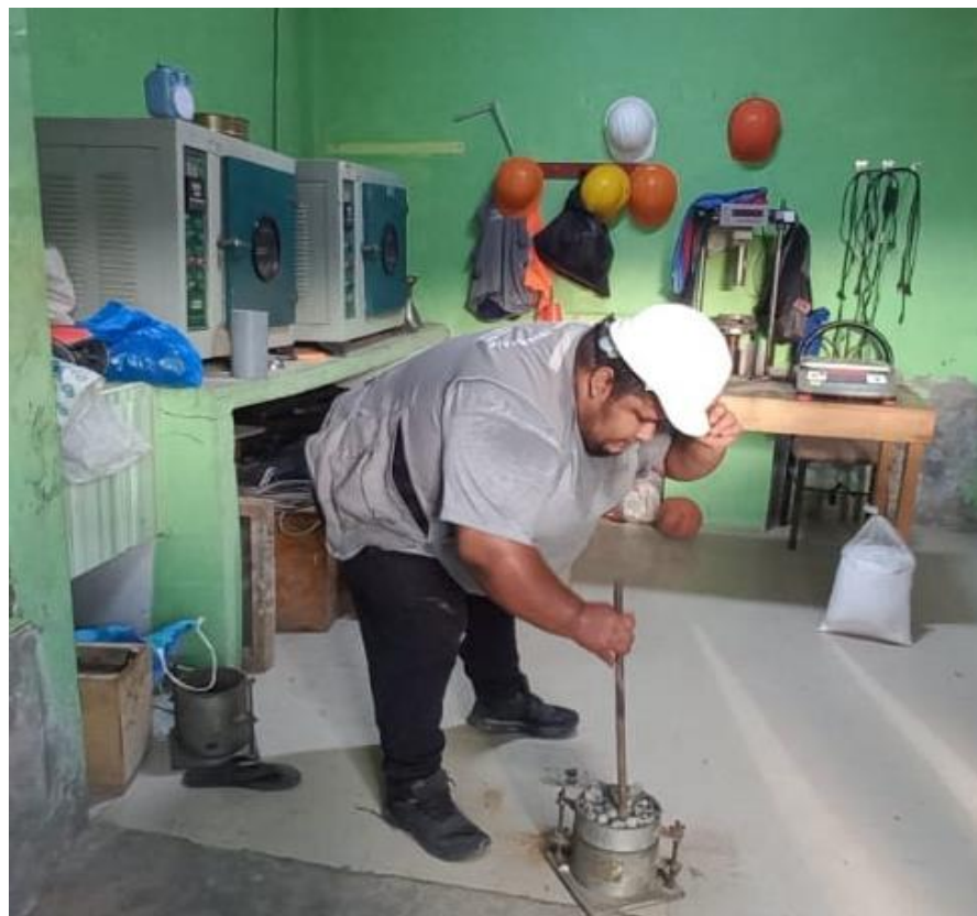
FOTO 08: Peso unitario suelto y compactado del agregado grueso.
