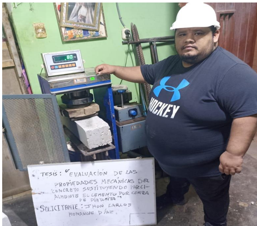
FOTO 22: Roturas de ensayos prismáticos.
