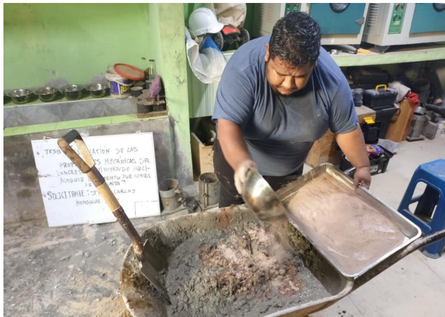
FOTO 14: Mezcla de concreto con la adición de ceniza de diatomita.
