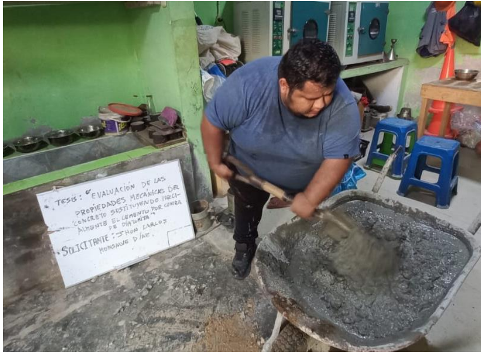
FOTO 11: Preparación de mezcla para concreto patrón.
