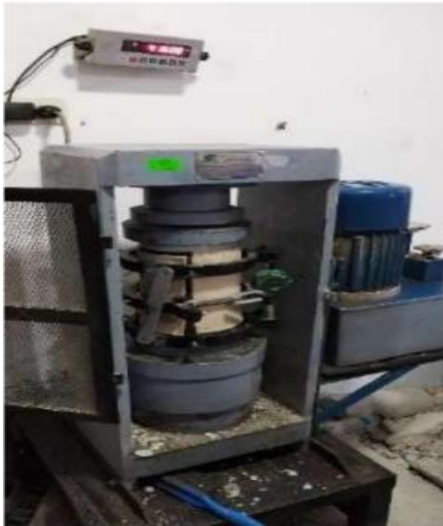
FOTO 25: Roturas modulo elástico.
