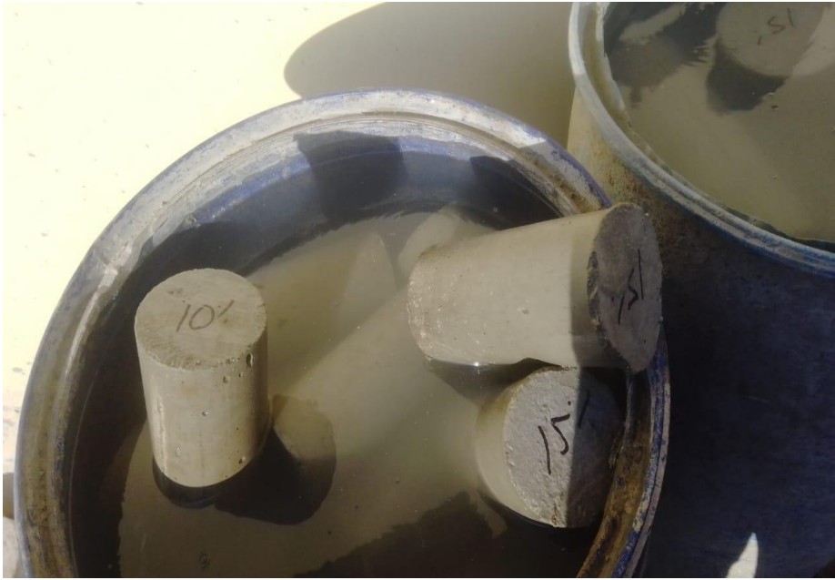
FOTO 17: Curado de probetas.
