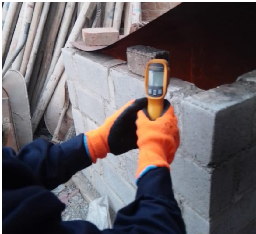
FOTO 28: Verificación de temperatura.
