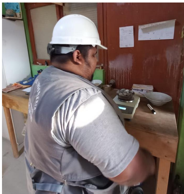
FOTO 06: Toma de muestras de agregado
