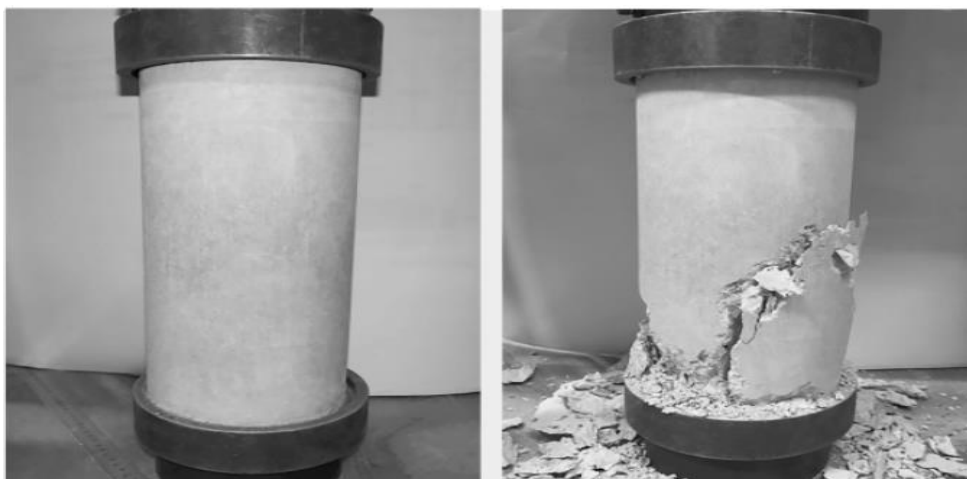
Fig. 1. Ensayo de compresión axial en cilindros estándar. [54].
