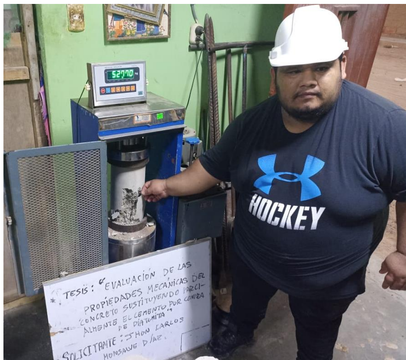
FOTO 20: Roturas de ensayos cilíndricos.
