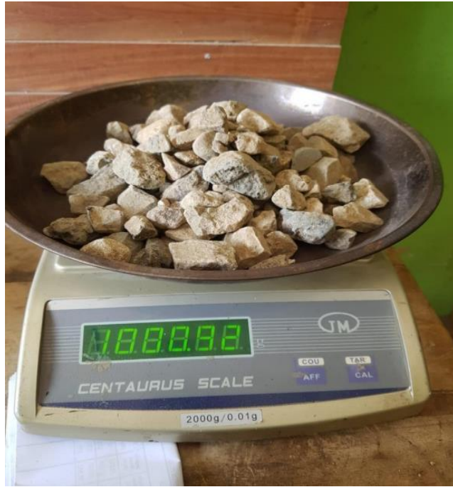
FOTO 03: Agregado grueso para granulometría.
