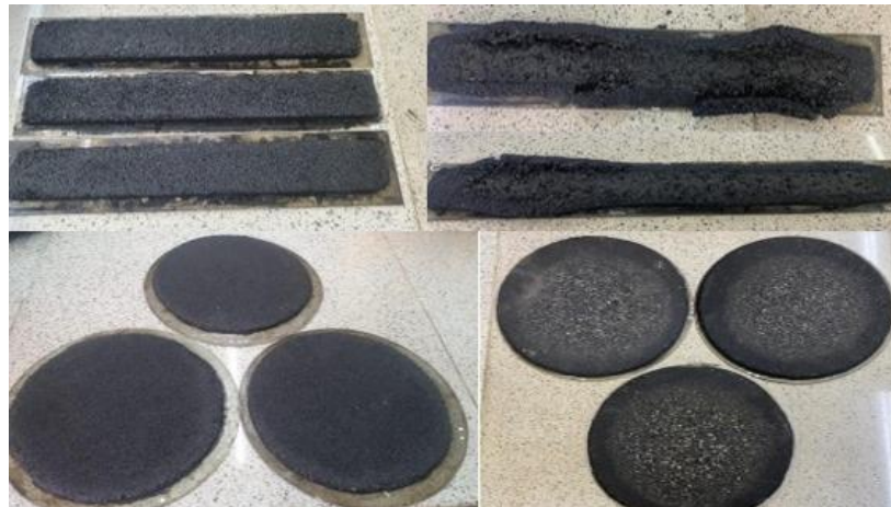
Fig. 34. Especímenes de la mezcla luego de ser sometida a ensayos.
