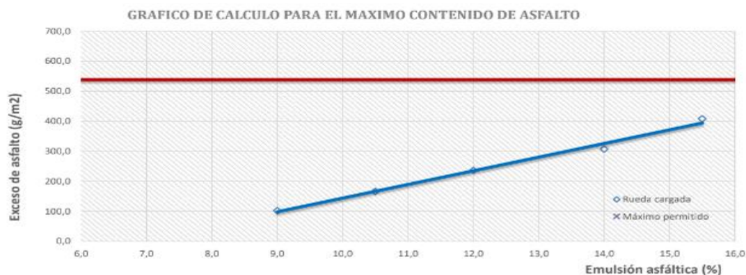
Fig. 8. Resultados de ensayo LWT con mezcla patrón.
