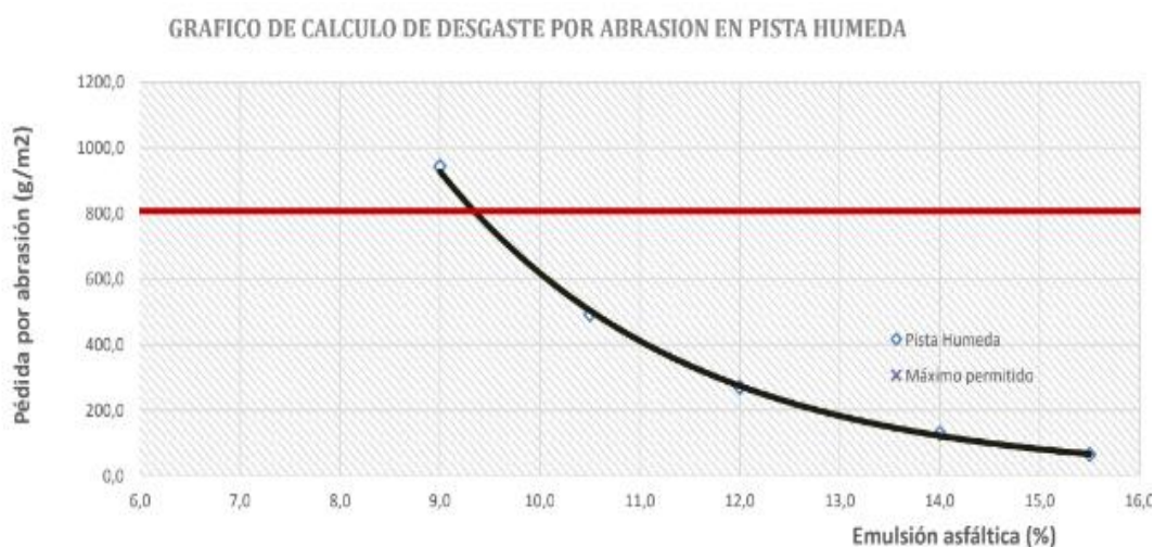
Fig. 9. Resultados del ensayo WTAT de la mezcla patrón.
