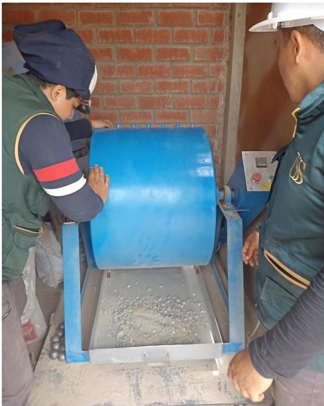
**Anexo 23– Incorporación del 5% de caucho a la mezcla de micropavimento.**
