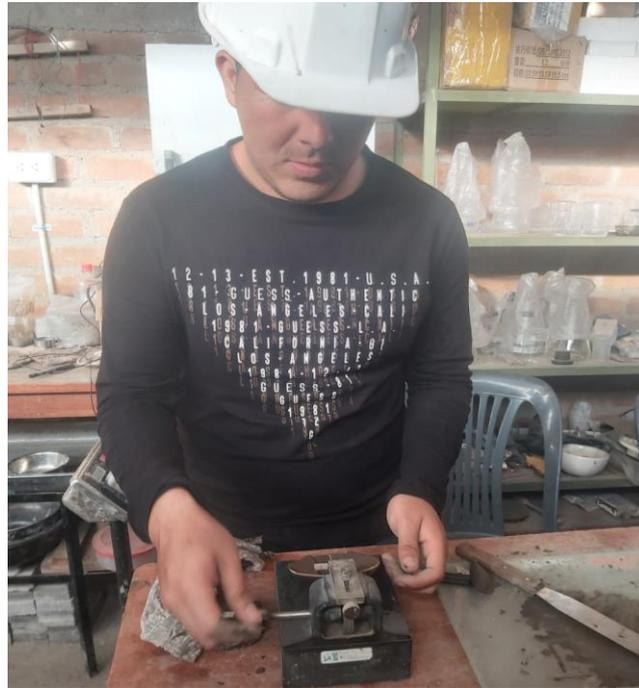
**Fig.14.** Realización de ensayo para límites.
