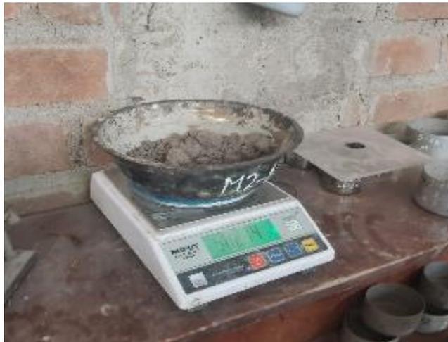
**Fig.16.** Realización de ensayo de contenido de humedad.
