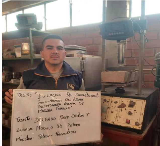
**Fig.24.** Realización de ensayo a flexión de unidades de adobe.
