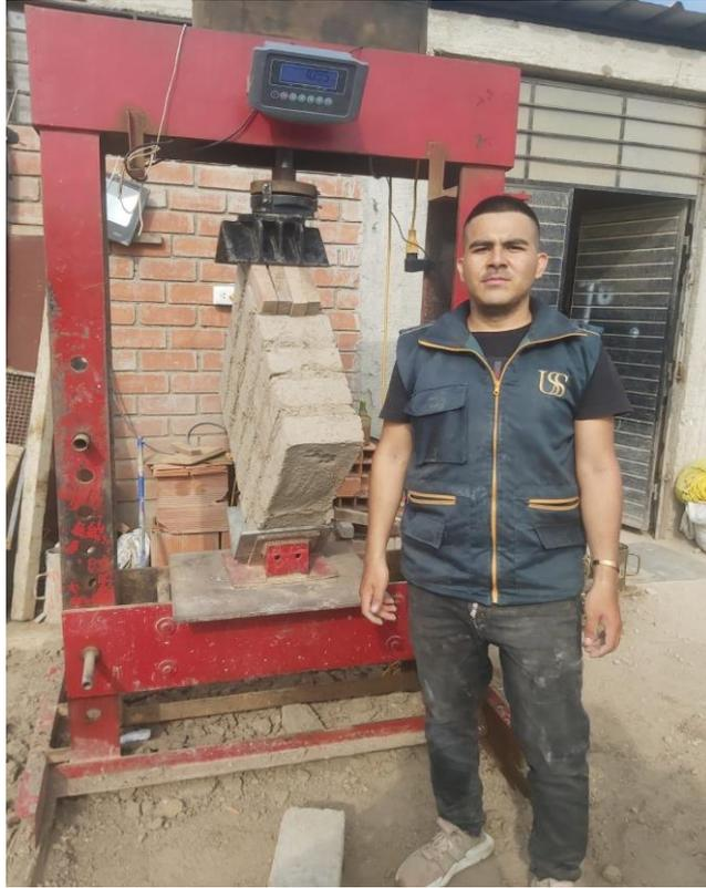
**Fotografía 17: Realización de ensayo de compresión diagonal en muretes.**
