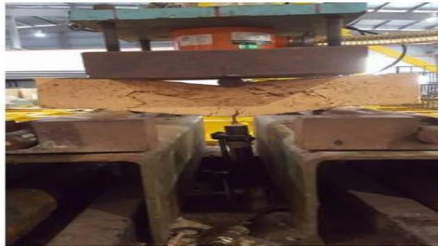
**Fig.5.** Configuración de prueba de resistencia a la flexión. [32]
