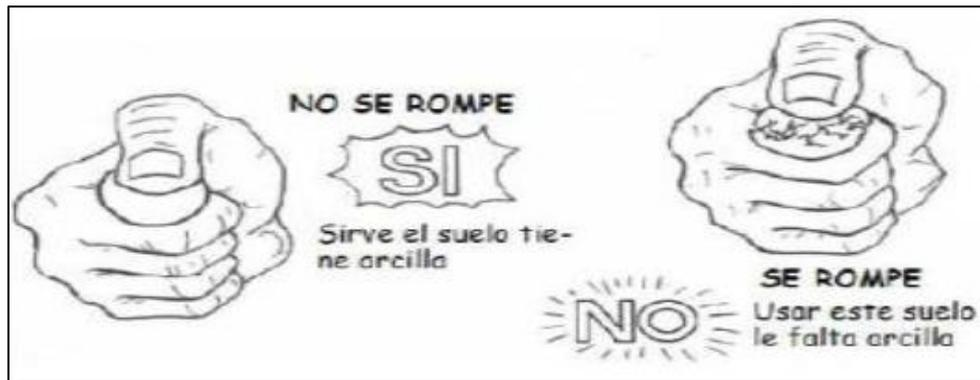
**Fig.2.** Ensayo de resistencia seco. [30]
