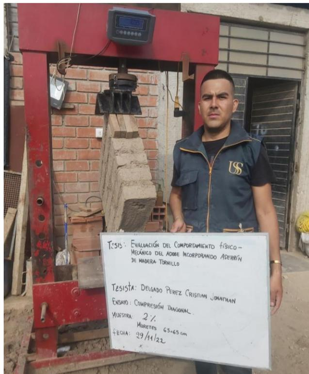
**Fig.26.** Realización de ensayo de compresión diagonal.
