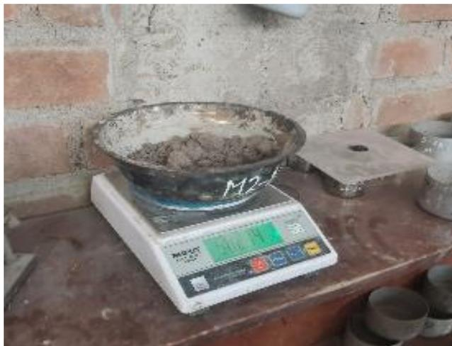
**Fotografía 6: Realización de ensayo de contenido de humedad.**
