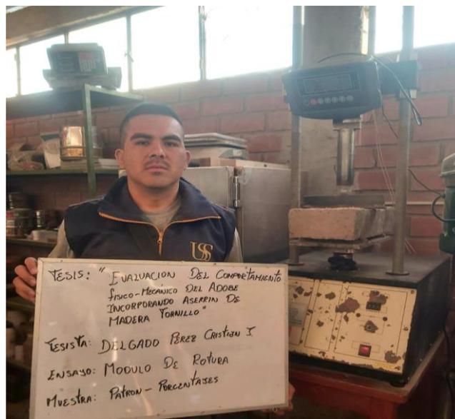
**Fotografía 14: Realización de ensayo a flexión de unidades de adobe.**
