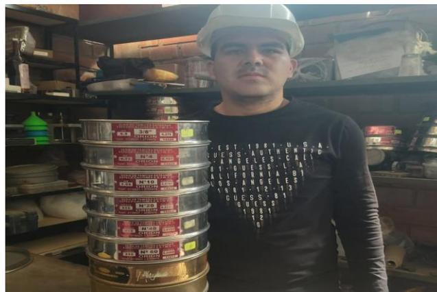
**Fig.11.** Realización de ensayo de granulometría.
