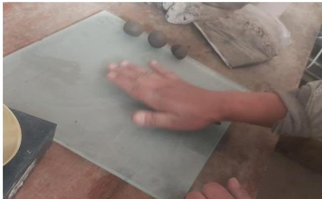
**Fig.13.** Realización de esferas para determinar presencia de arcilla.
