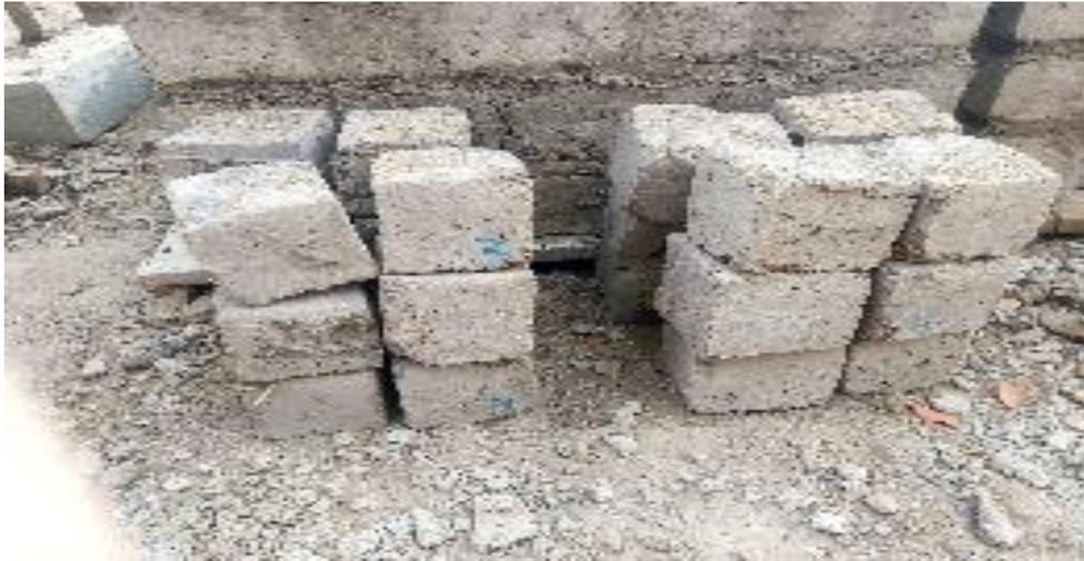
**Fig.23.** Unidades de adobe para resistencia a la compresión.
