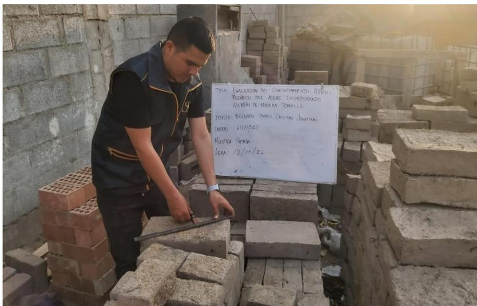
**Fig.19.** Toma de medidas para ensayo de alabeo.
