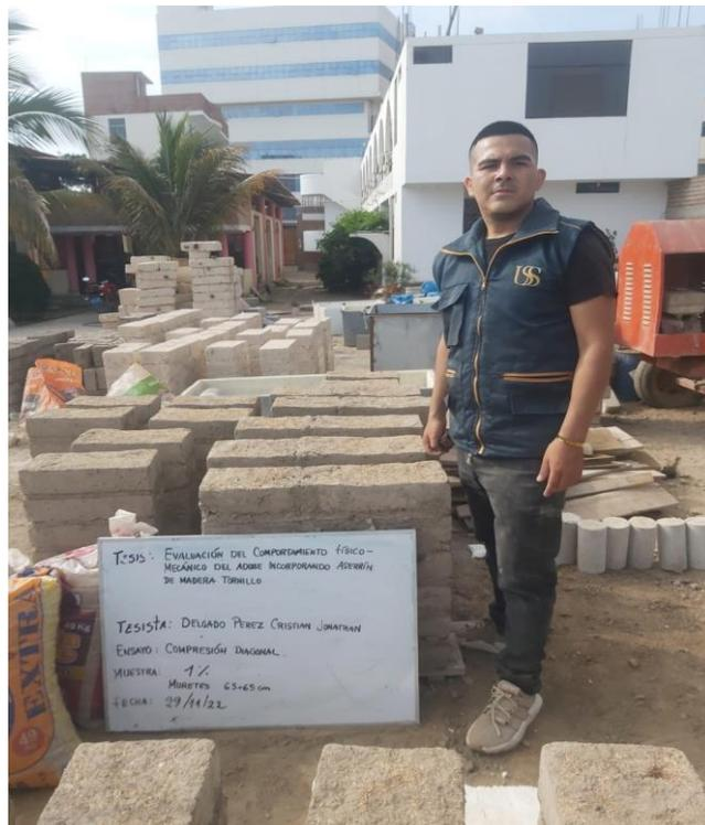
Fotografía 16: Evidencia de muestras de muretes en estado de secado.
