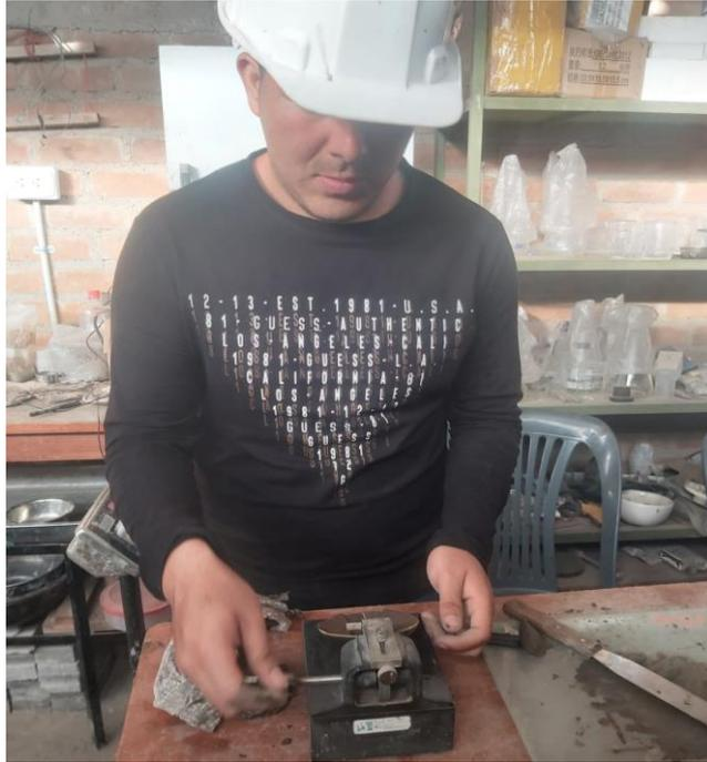
**Fotografía 5: Realización de ensayo para límites de Atterberg**
