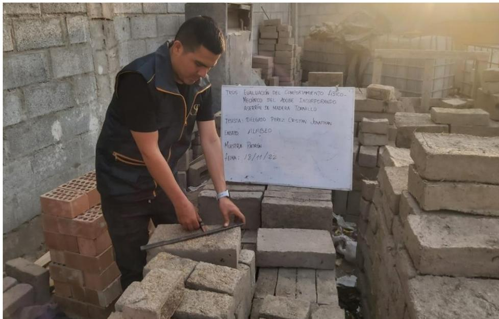
**Fotografía 10: Toma de medidas para ensayo de alabeo**
