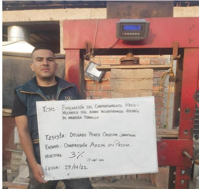
Fotografía 15: Rotura de compresión de prismas.
