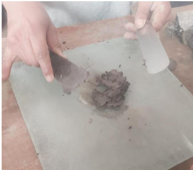
**Fig.12.** Preparación de muestra para prueba de cinta de barro.
