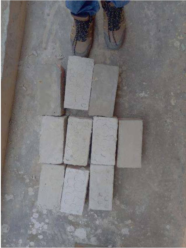
Refrentado de unidades de albañilería
