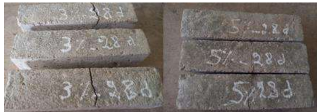
Ensayo de resistencia a la flexión en vigas a la edad de 28 días
