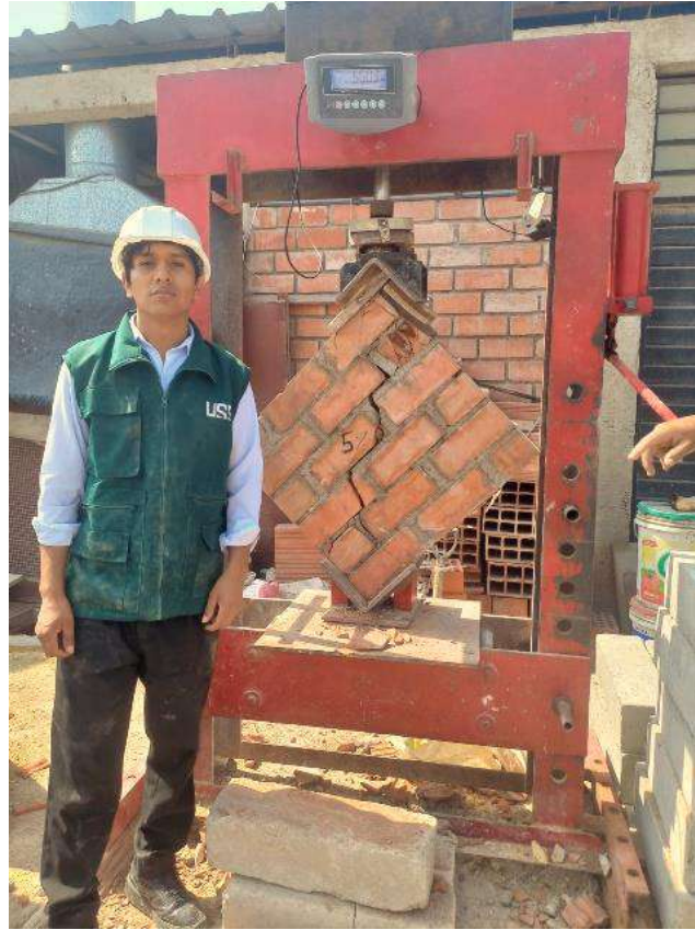
Rotura de muretes de albañilería
