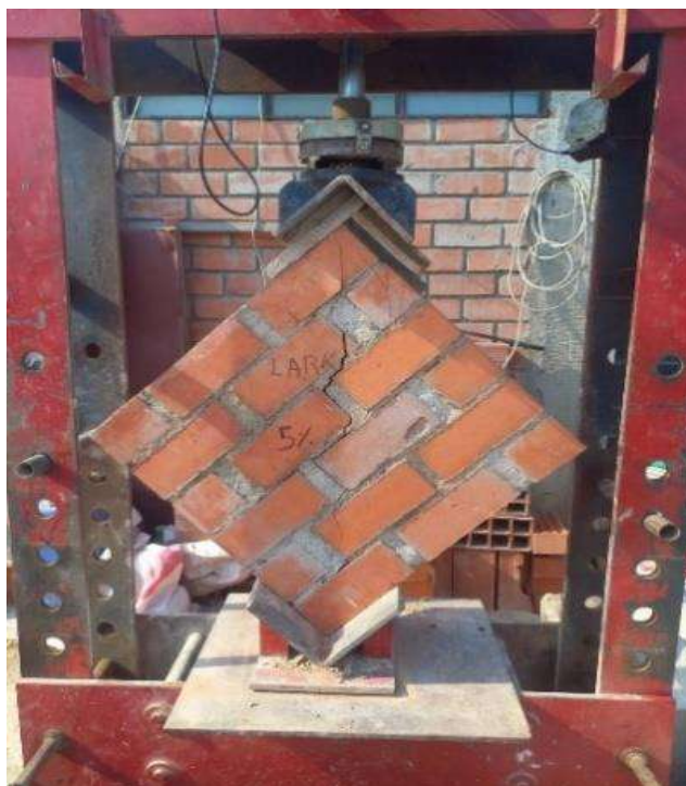
Fig. 24. Muretes ensayados a compresión diagonal.
