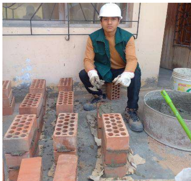
Ensayo de resistencia a compresión de pilas de albañilería
