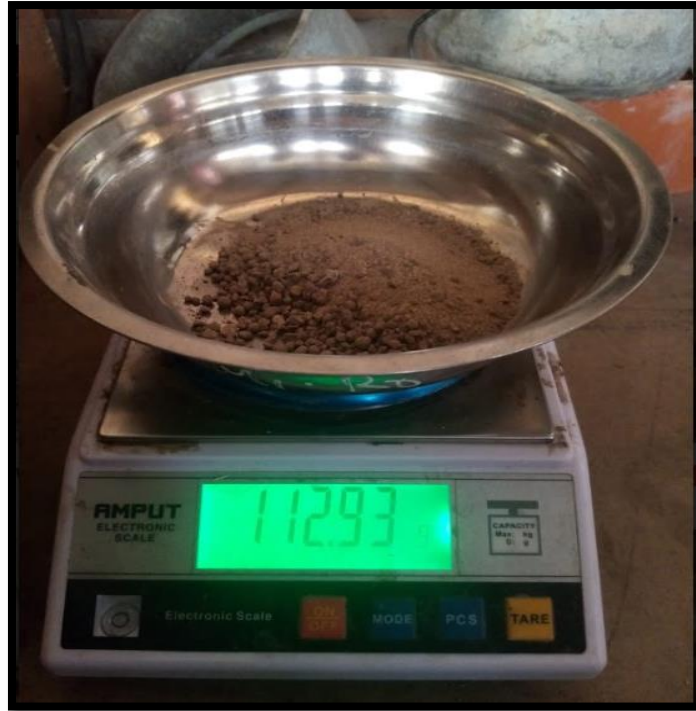
Imagen 9: Muestra de suelo para ensayo de granulometría.
