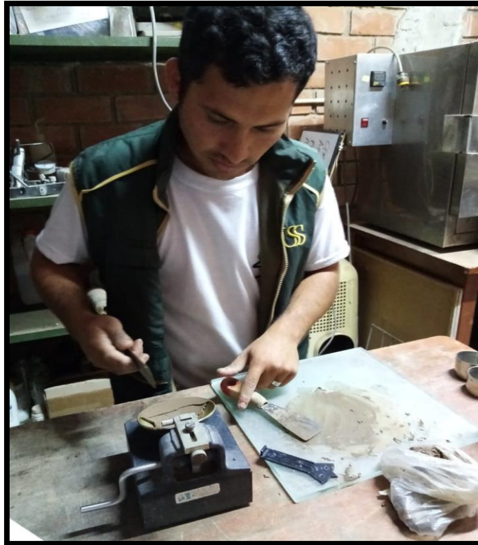
Imagen 15: Ensayo de límite líquido haciendo uso de la Copa de Casagrande en intervalos entre 15 y 35 golpes.
