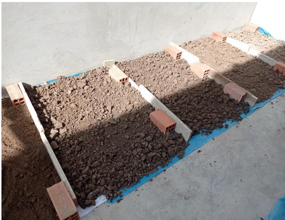
Imagen 4: Recolección, trituration y secado de la muestra de suelo
