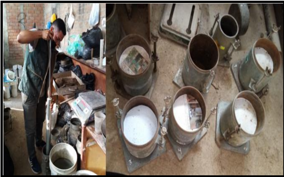
Imagen 26: Se realiza el compactado en los 3 niveles del ensayo de CBR.
