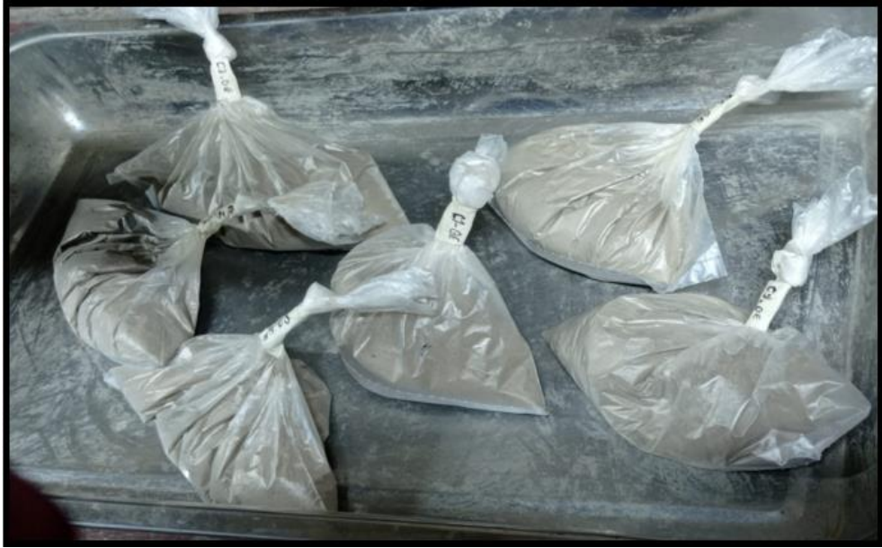
Imagen 13: Preparación de muestras de suelo de cada calicata para realizar ensayos de límites de Atterberg.
