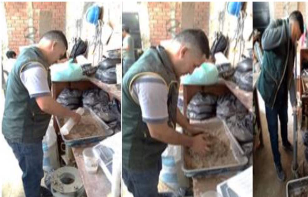
Imagen 22: Se combina 500ml de agua con la proporción de suelo patrón 2500 g, después se realiza la saturación hasta obtener una muestra uniforme y el ensayo Proctor.
