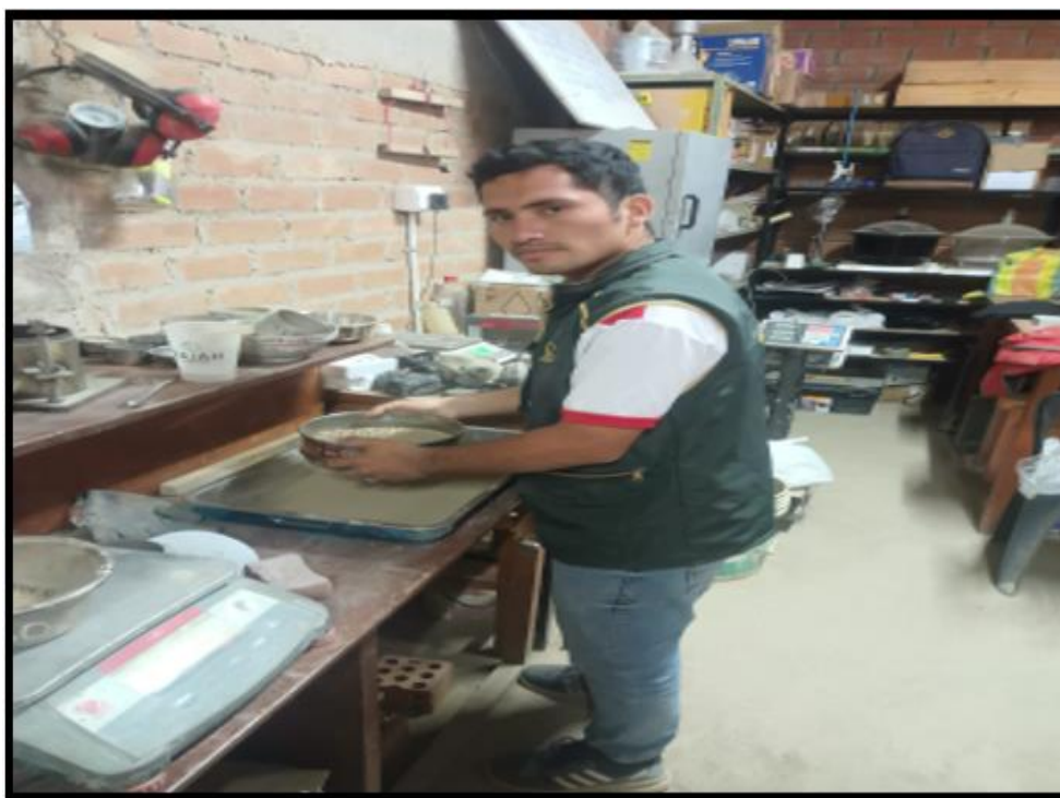
Imagen 12: Tamizado en la malla N°40 para el límite plástico.
