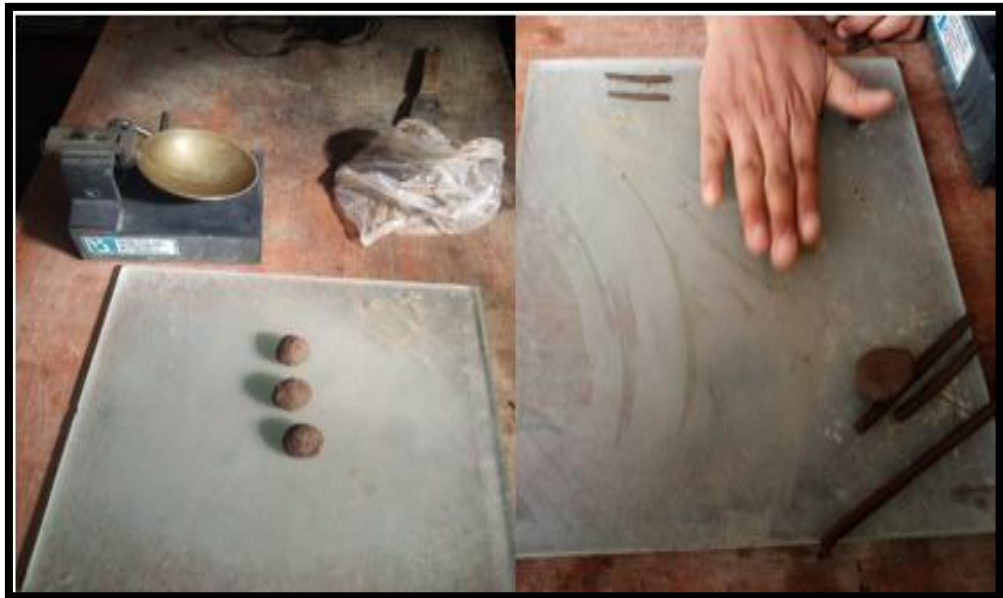
Imagen 18: Ensayo del límite plástico.
