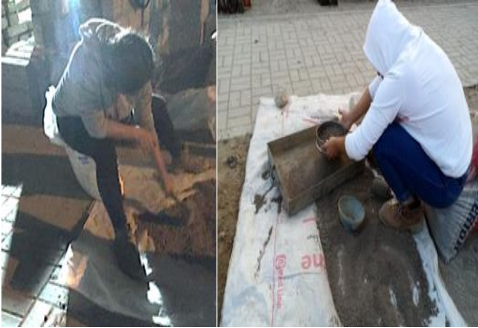
Imagen 5: Se realiza el triturado de la muestra para posteriormente pasar por la malla N°4.
