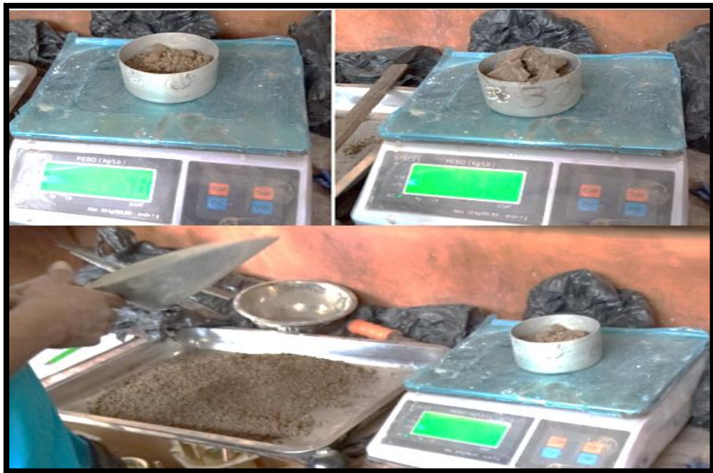
Imagen 24: Se realiza el peso de la muestra en 3 niveles (centro, medio y final) del Proctor para luego colocarlos en el horno.
