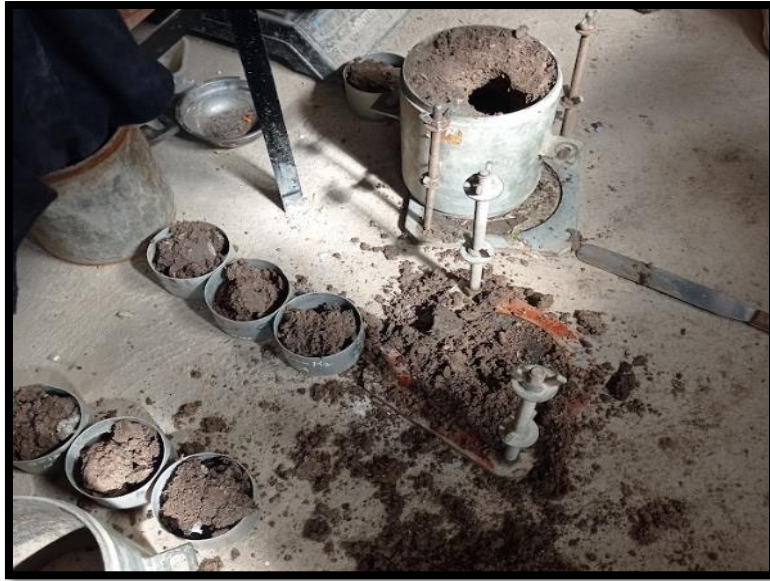
Imagen 31: Una vez saturadas se toma 3 muestras (inicio, medio y final), se coloca en taras para luego pesar y llevar horno.
