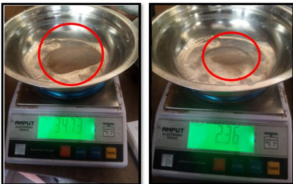
Imagen 11: Una vez realizada el zarandeo procede a pesarse en una balanza gramera el suelo retenido que va quedando en cada malla respectiva.
