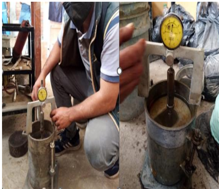
Imagen 28: Se coloca la carga en el molde del ensayo de CBR
