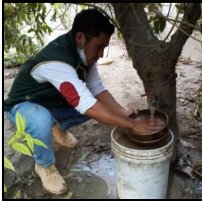
Imagen 7: Lavado de muestra por la malla N°200 después de salir del horno, para luego volver a ingresar al horno por 24 hrs y posteriormente realizar el ensayo de granulometría.
