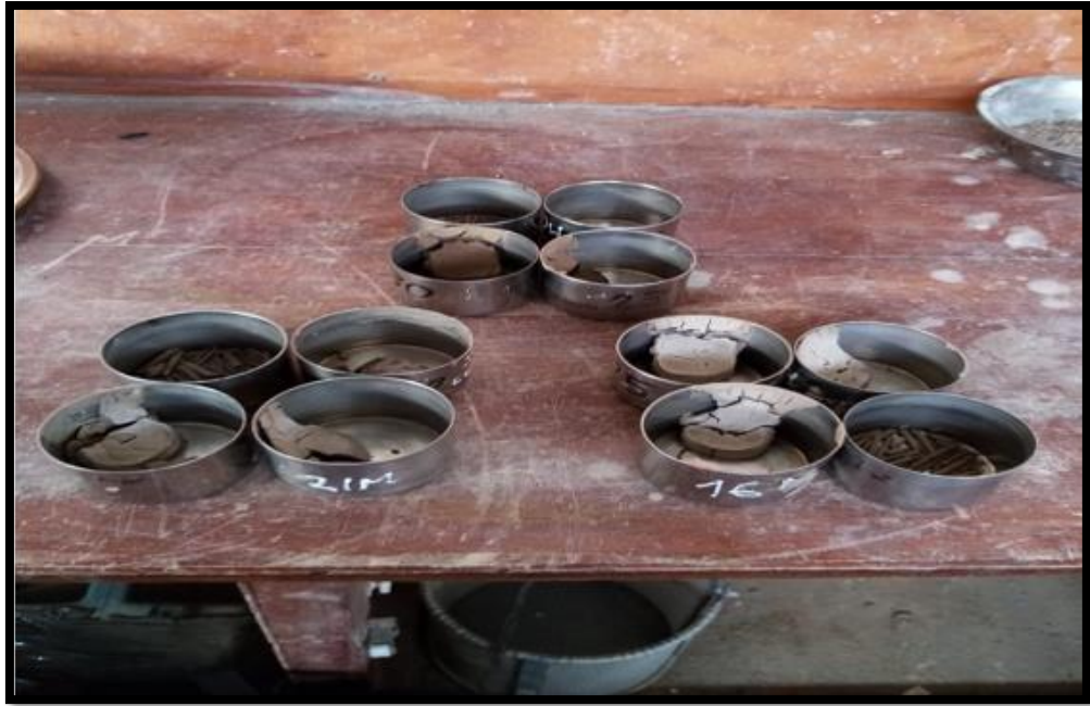
Imagen 19: Muestras retiradas del horno tanto del ensayo límite líquido y ensayo límite plástico y posteriormente se procede a pesar.
