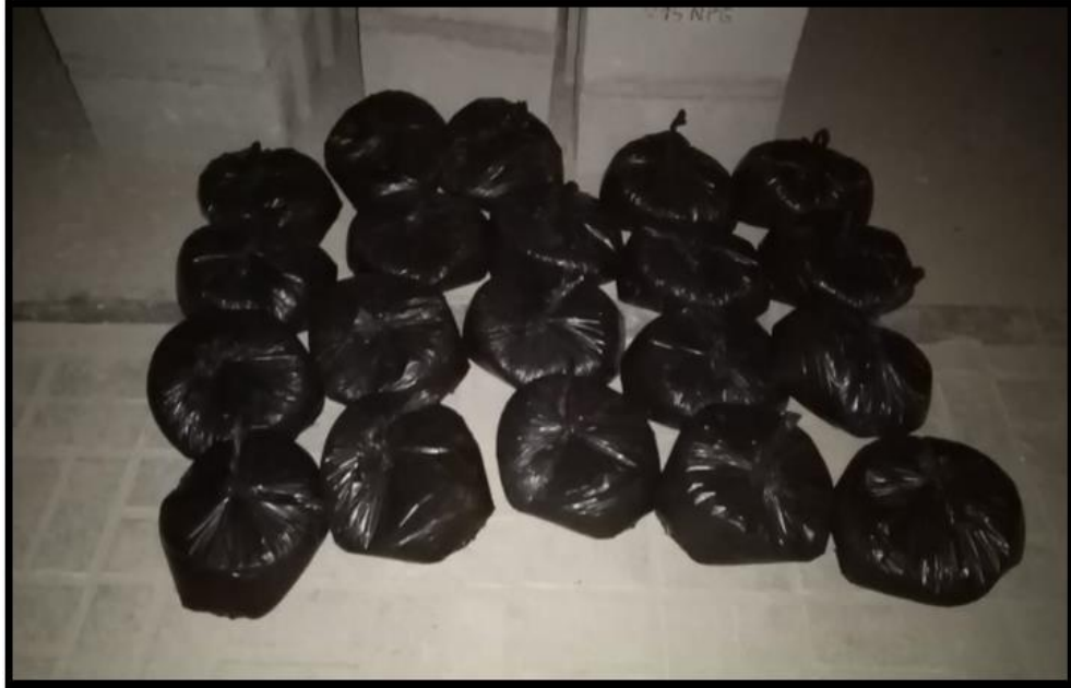
Imagen 21: Muestras de suelo embolsadas para realizar ensayos de CBR y Proctor.
