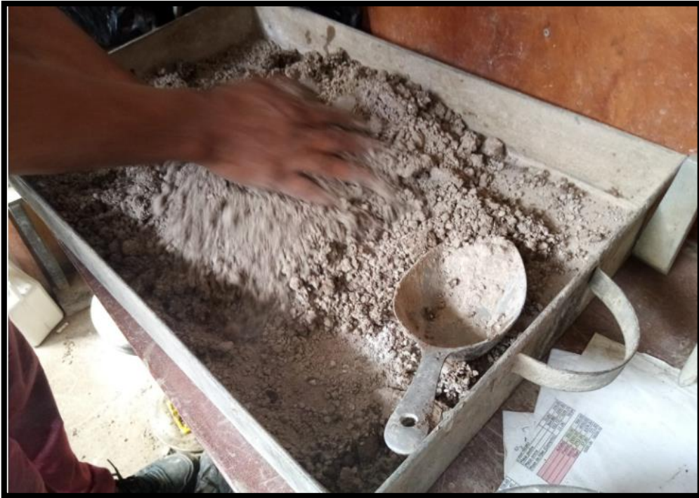
Imagen 25: Se realiza el mezclado haciendo uso de la muestra con su respectivo porcentaje de la cal y agua.
