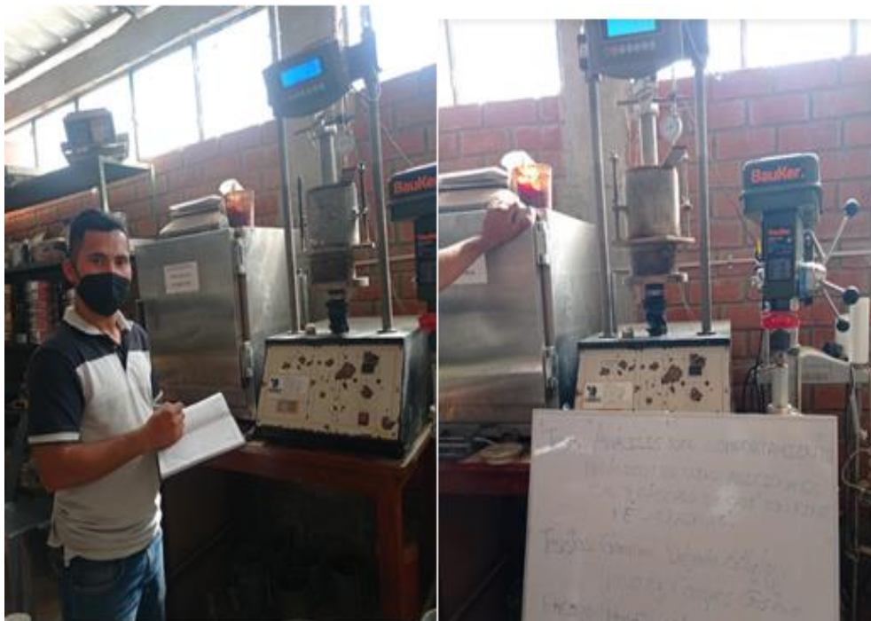
Imagen 30: Se realiza el ensayo de pistón de penetración mediante la prensa CBR y tomar las lecturas de la curva.
