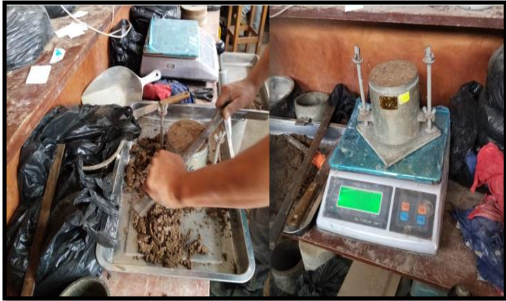
Imagen 23: Una vez realizada la compactación se procede a nivelar la muestra a la altura del molde y posteriormente se pesa.
