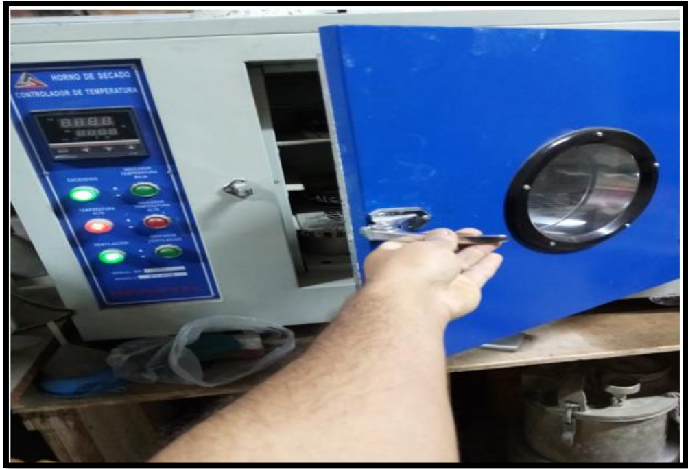
Imagen 17: Posteriormente de los ensayos del límite líquido se procede a colocar al horno.
