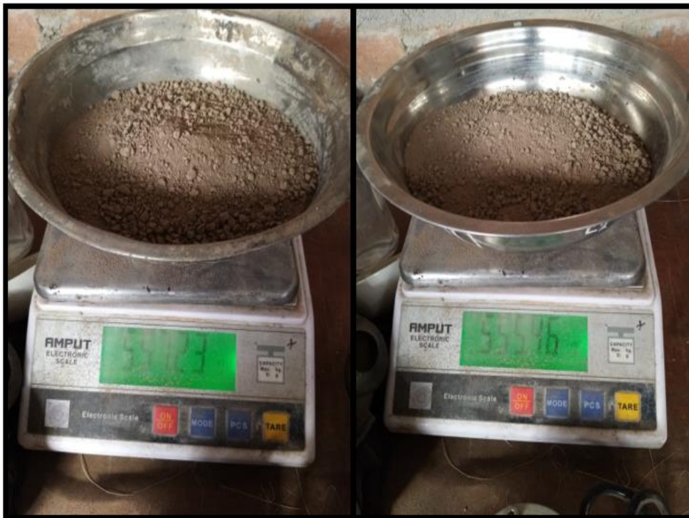
Imagen 6: Pesado de muestras de suelo, 500g más tara para luego ser llevado al horno.
