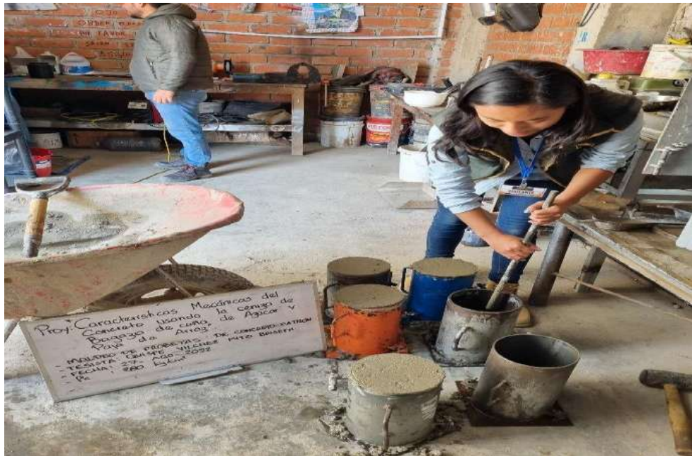
Fot 15. Elaboración de muestras cilíndricas
