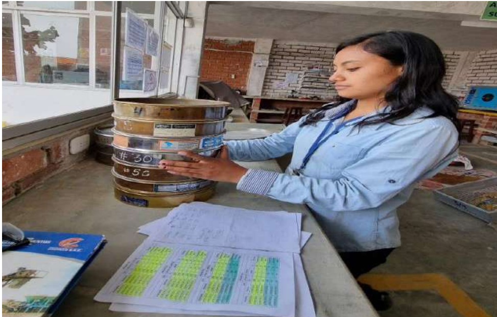
Fig. 17 Tamizado del agregado fino
