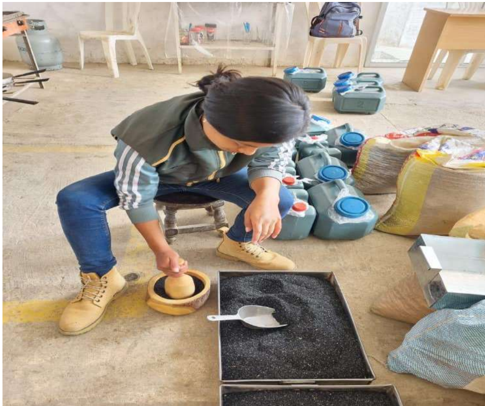
Fot 4. Trituración de las cenizas CBCA y PA
