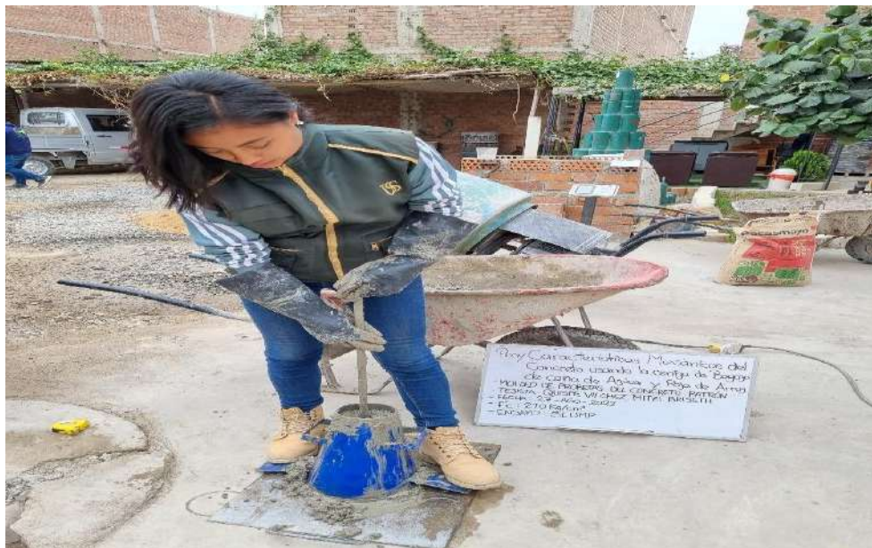
Fig. 21 Ensayo Slump del concreto patrón
