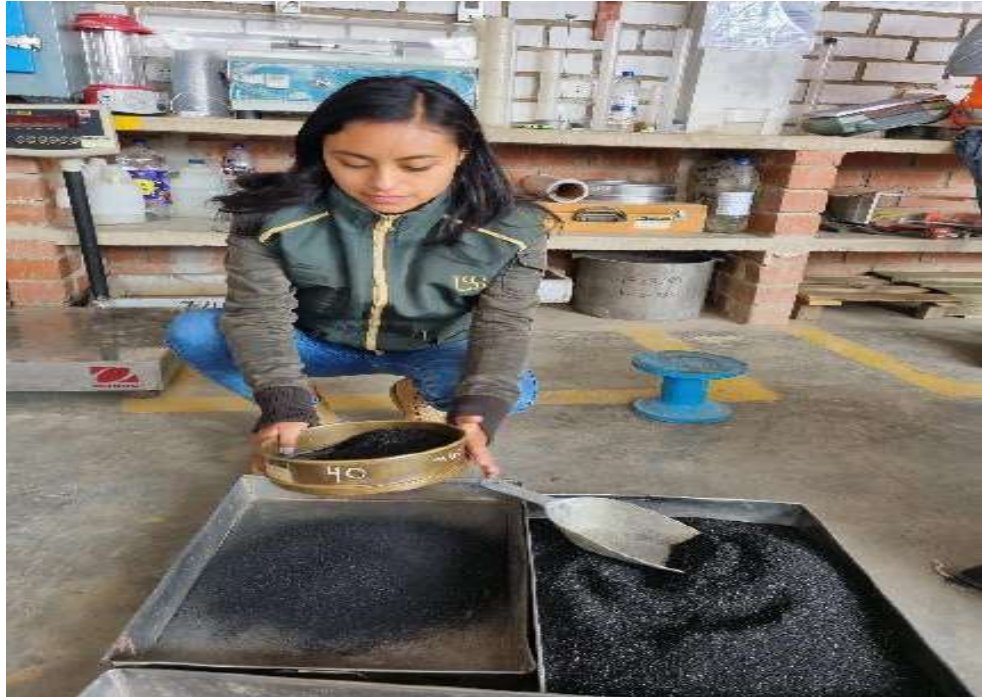
Fot 5. Tamizado por la malla N° 40 de las cenizas de CBCA y PA
