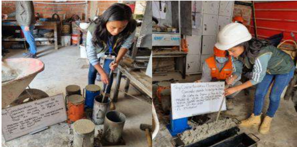
Fig. 22 Moldeo de probetas y vigas de concreto
