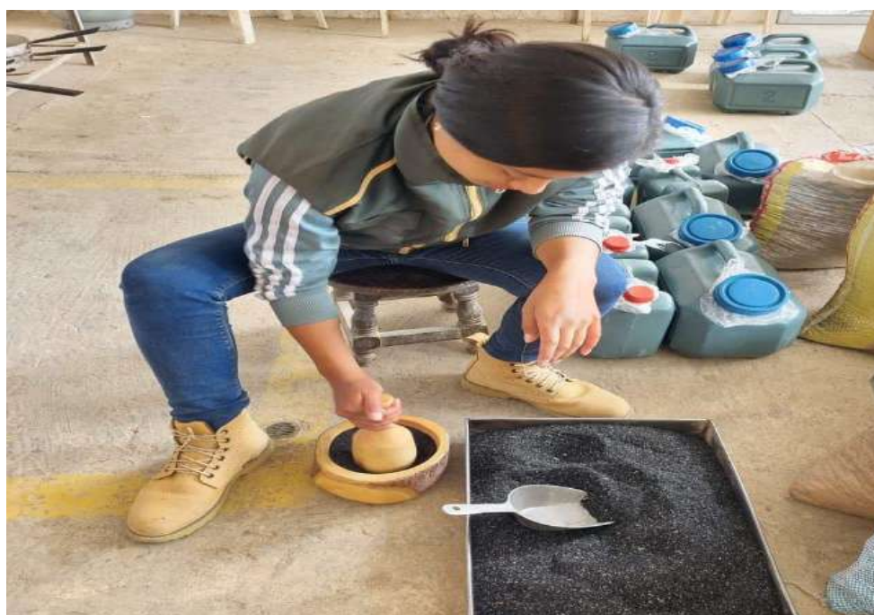
Fig. 15 Trituración de ceniza de paja de arroz
