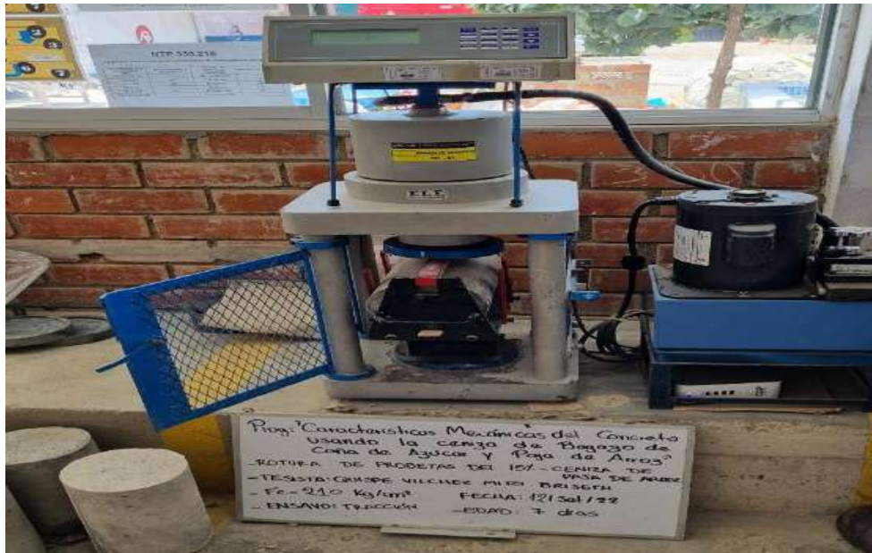
Fig. 26 Ensayo de resistencia a la tracción
