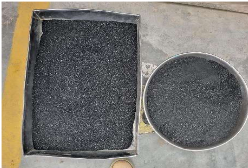
Fot 6. Producto final de la ceniza CBCA y PA
