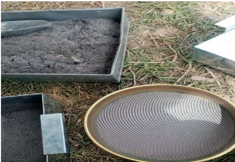
Fig. 11 Tamizado de la ceniza de CBCA por la malla N° 40
