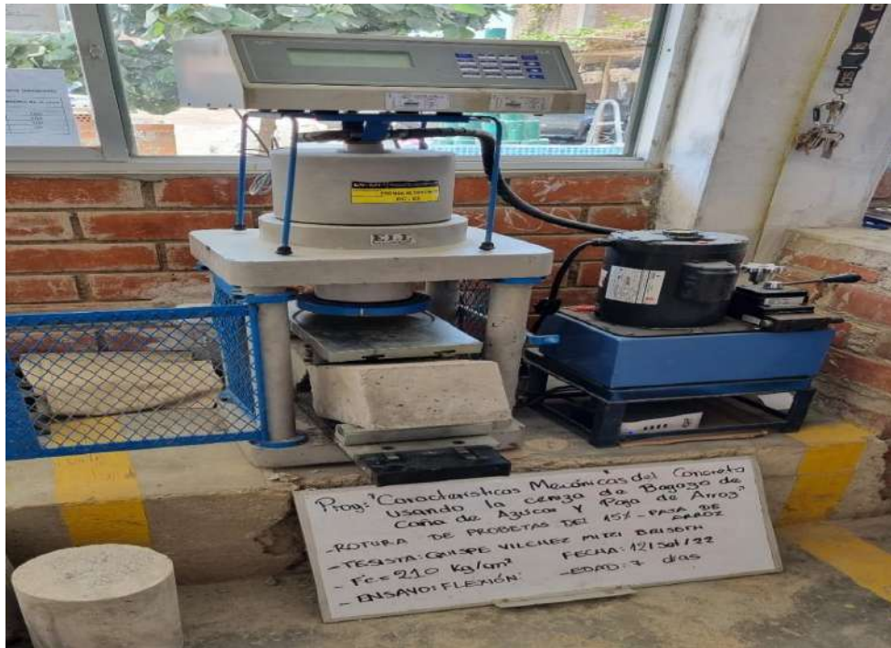
Fig. 25 Prueba de esfuerzo para determinar la resistencia a la flexión
