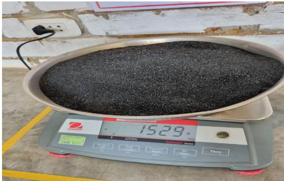
Fot 7. Peso de la ceniza bagazo de caña de azúcar
