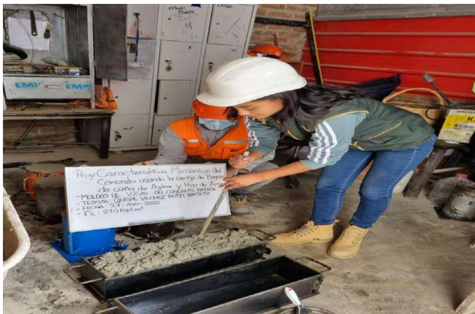
Fot 14. Elaboración de muestras prismáticas
