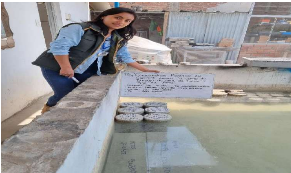
Fig. 23 Curado de probetas cilíndricas y vigas de concreto
