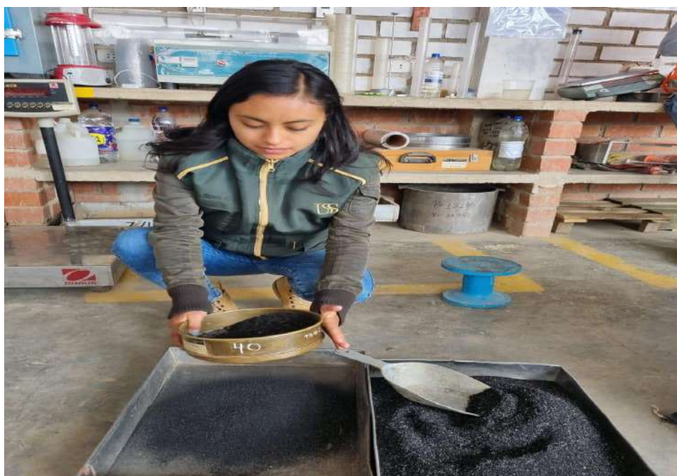
Fig. 16 Tamizado de ceniza de paja de arroz
