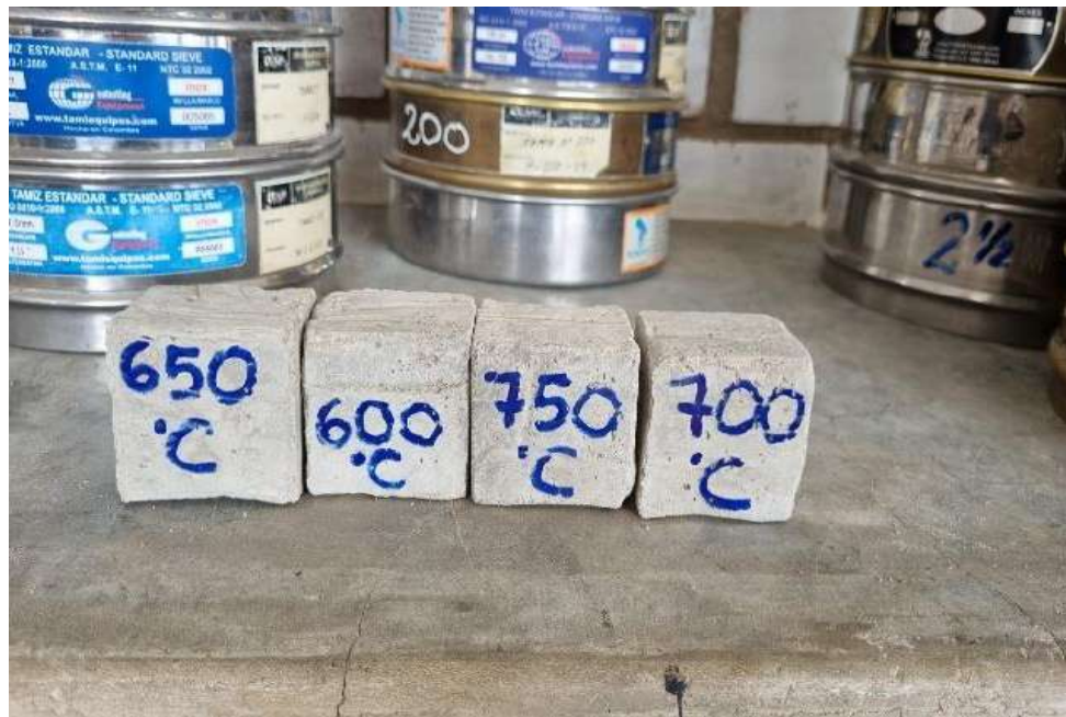
Fot 10. Cubos de 5x5cm para obtener la temperatura óptima
