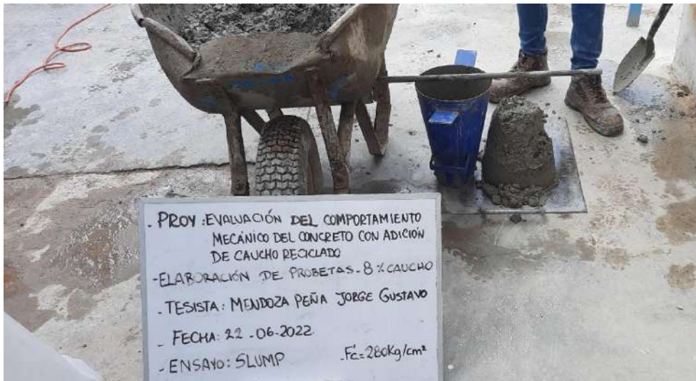
Fig. 27. Ensayo de asentamiento del concreto.
