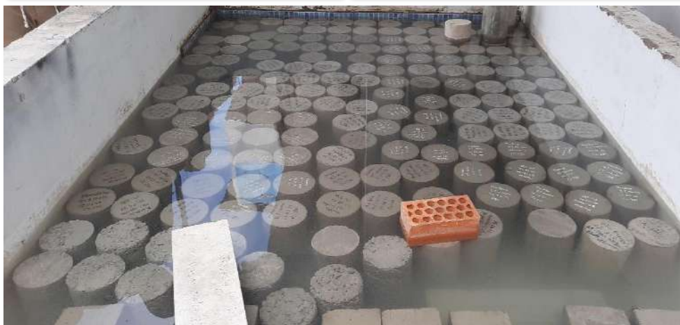
Fotografía 97: Moldeo y curado de probetas cilíndricas y vigas.
