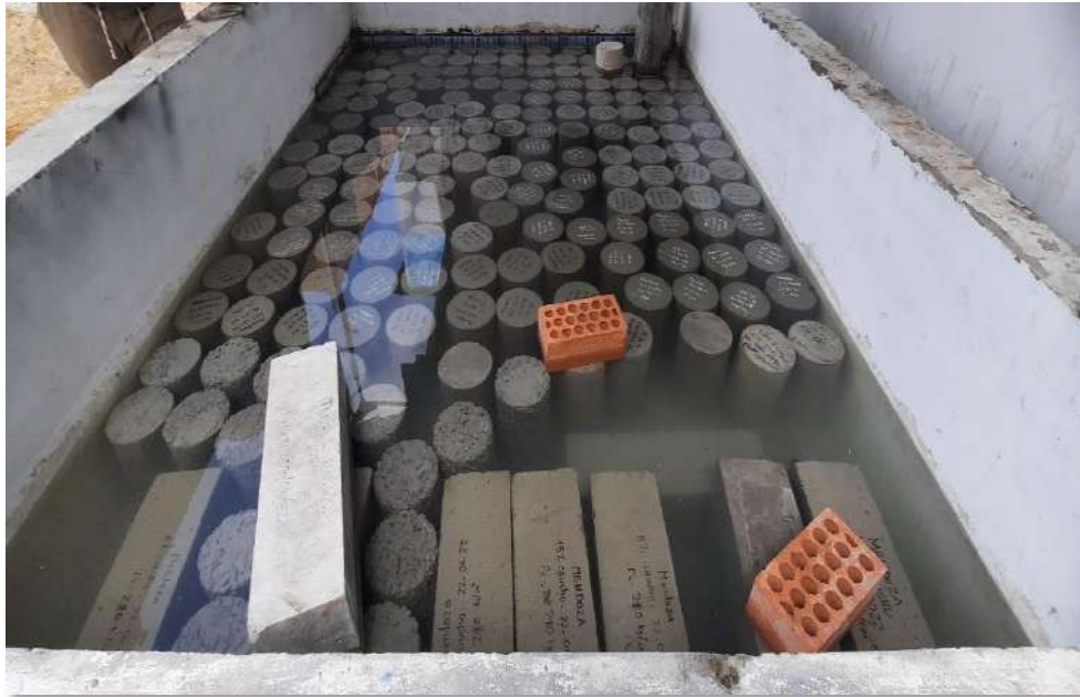
Fig. 28. Elaboración y curado de probetas cilíndricas de concreto.
