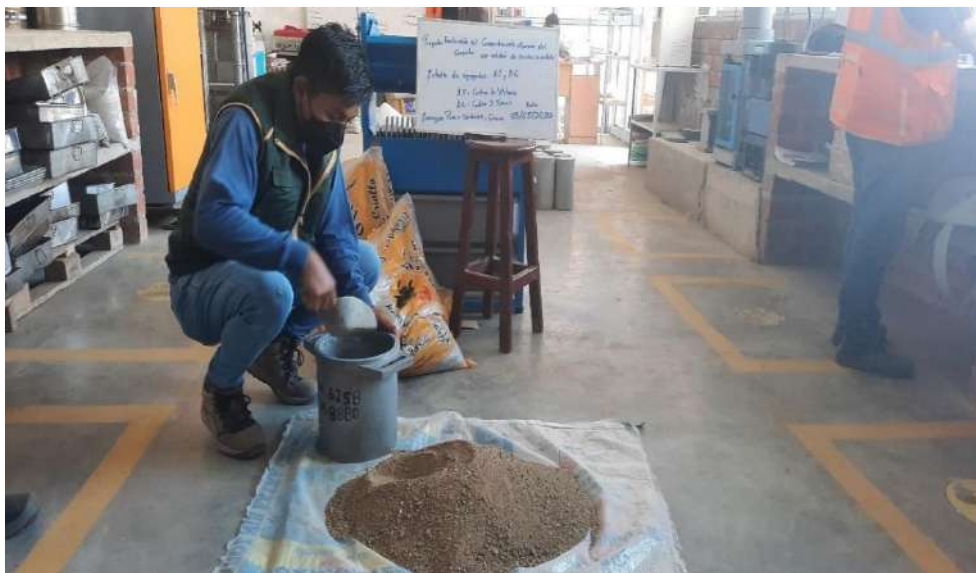
Fig. 19. Vaciado del agregado fino al molde metálico.
