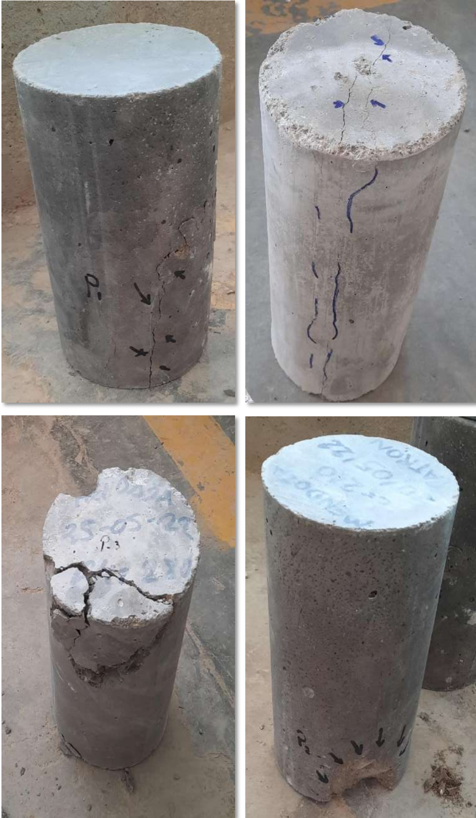
Fotografía 387: Tipos de fallas en los testigos de concreto.
