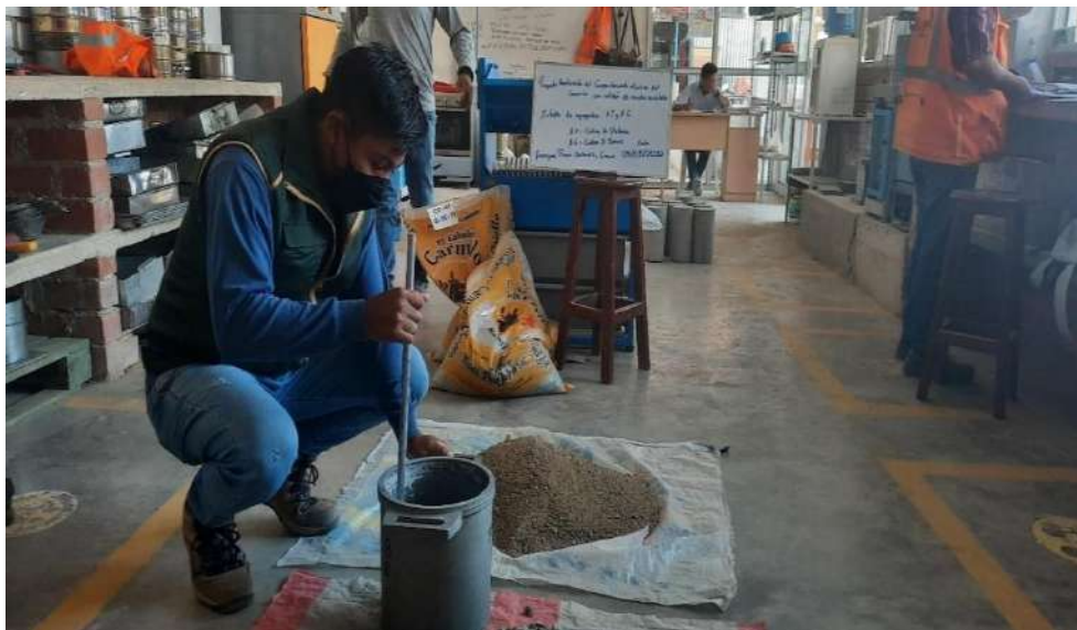
Fig. 20. Vaciado del agregado grueso al molde metálico.
