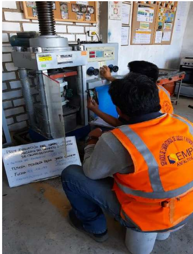
Fig. 32. Ensayos de módulo de elasticidad del concreto.
