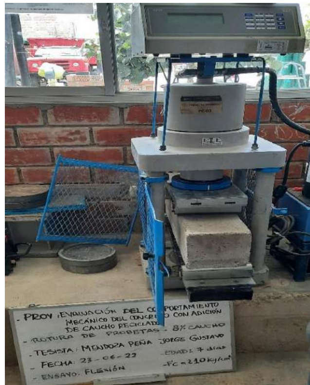
Fig. 31. Ensayo de resistencia a la flexión del concreto.
