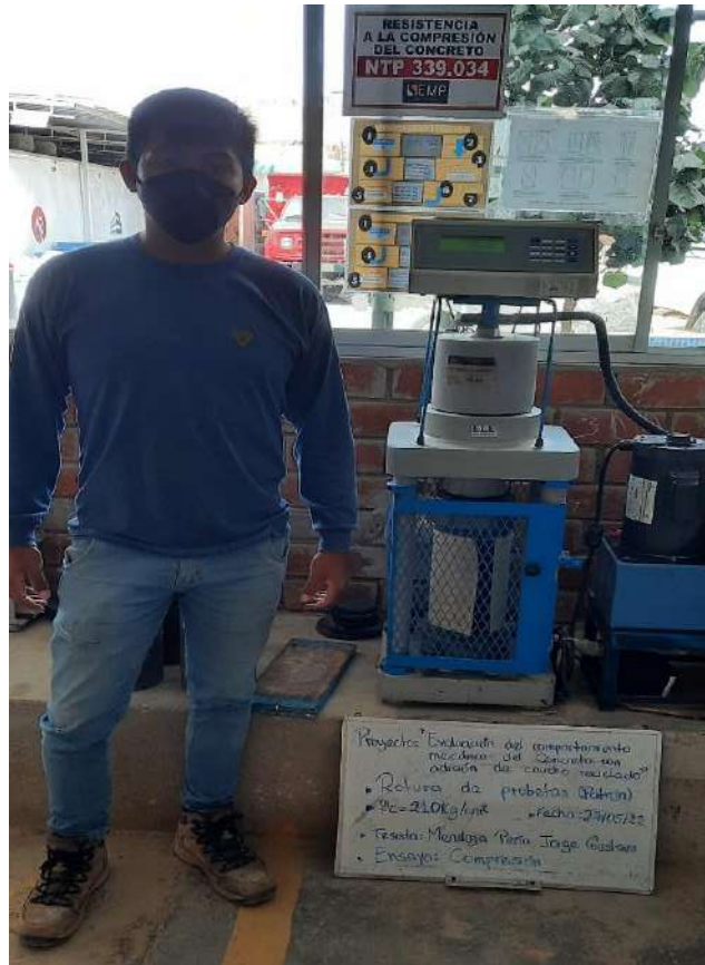
Fig. 29. Ensayo de resistencia a la compresión del concreto.
