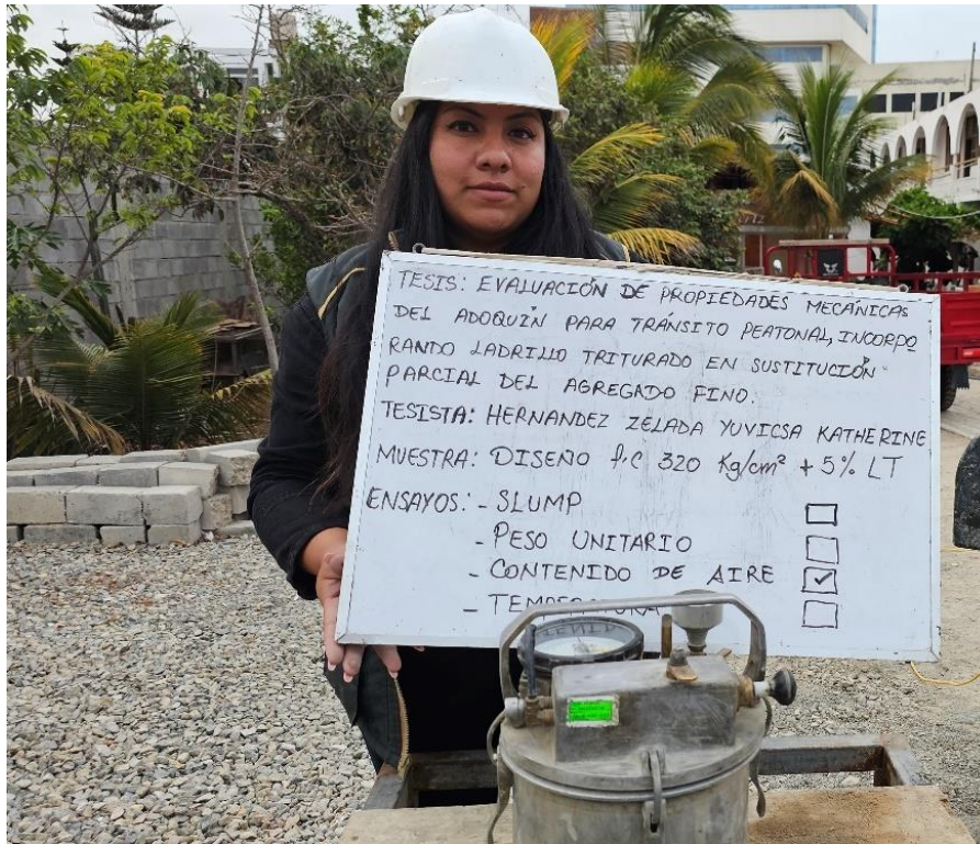
Contenido de aire de la mezcla de concreto para adoquines
