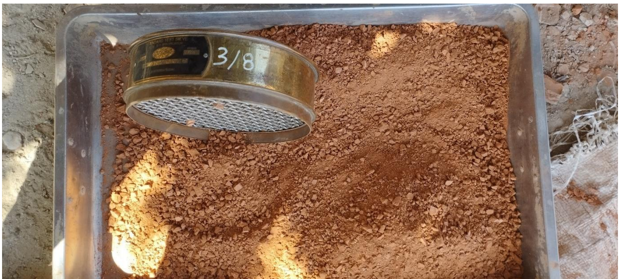
Tamizado de ladrillo triturado
