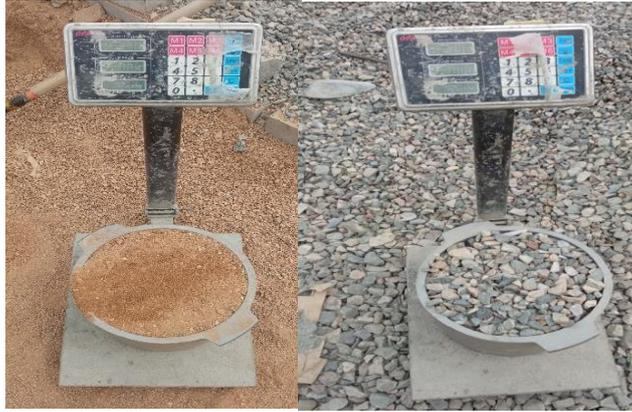
**Fig.21.** Peso Unitario de los agregados
