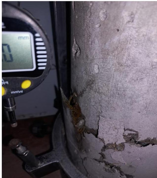
**Fig.35.** Muestras ensayas del módulo elástico.
