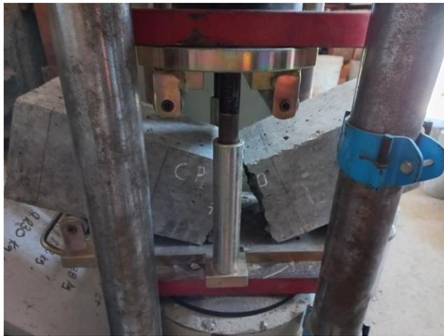
**Fig.33.**Muestra ensayada a flexión
