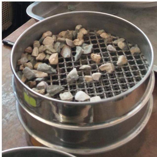
**Fig.20.** Granulometría de agregado grueso
