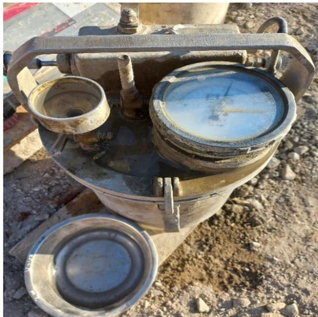
**Fig.27.** Contenido de aire del concreto
