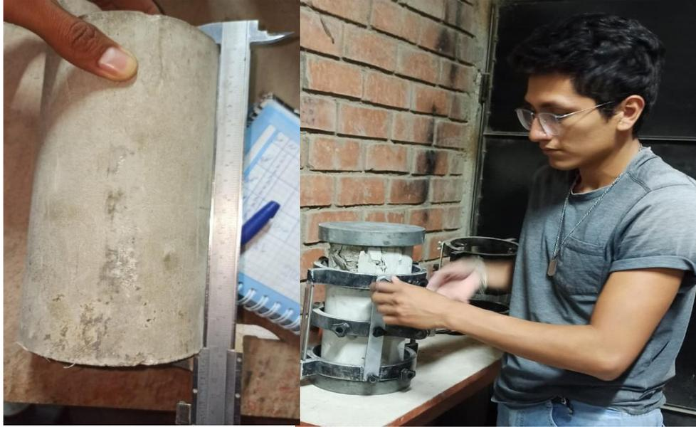
**Fig.28.** Medición y colocación de placas en el concreto para ensayar a la compresión
