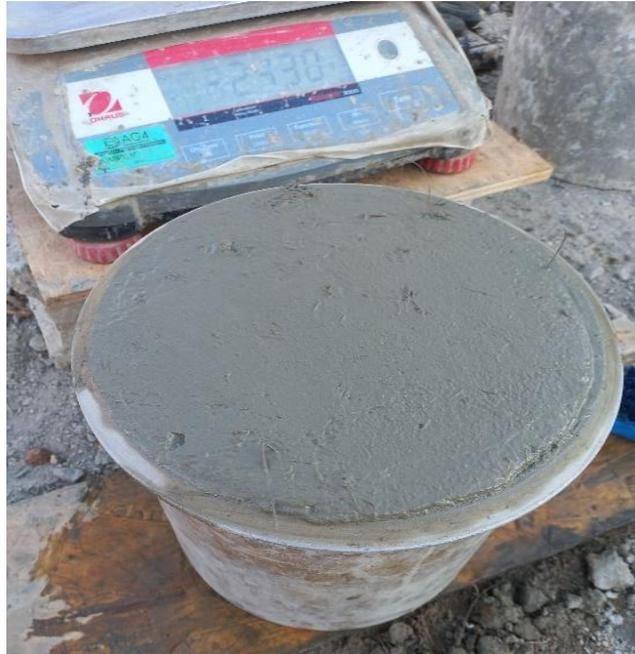
**Fig.26.** Peso unitario del concreto fresco
