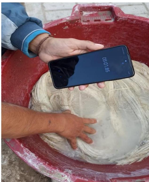
**Fig.18.** Tratamiento con cal de la Fibra de Sisal con Cal
