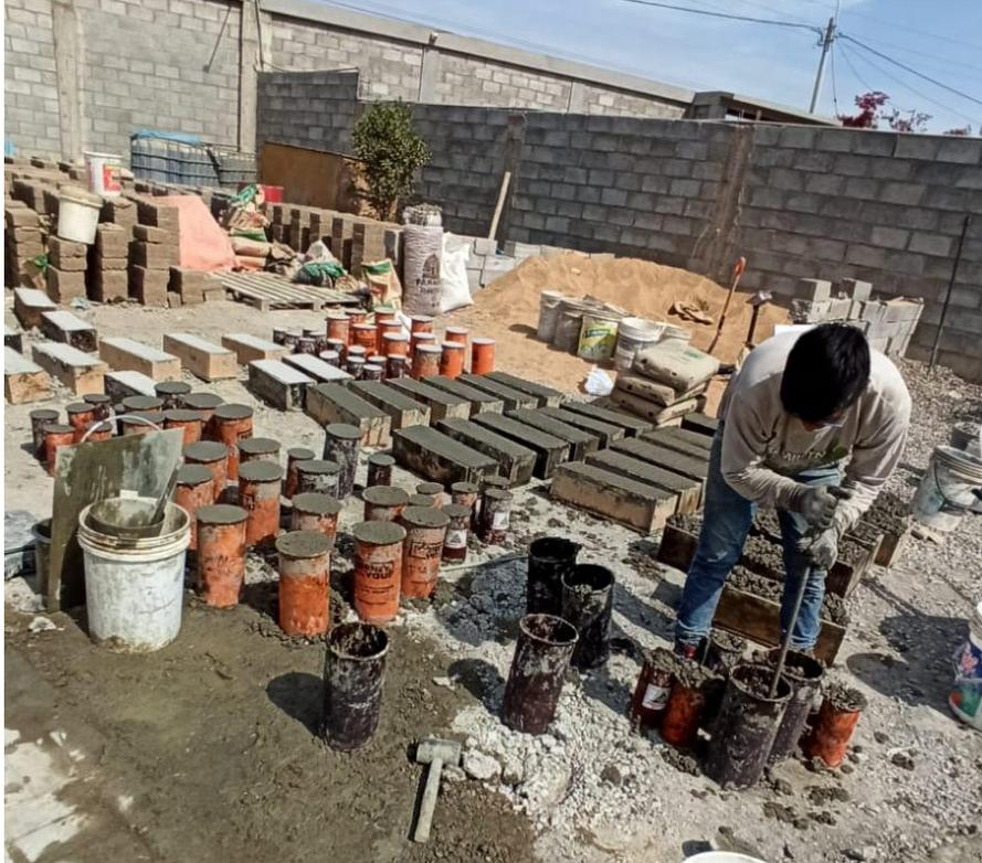
Foto 9: Testigos experimentales en el laboratorio.
