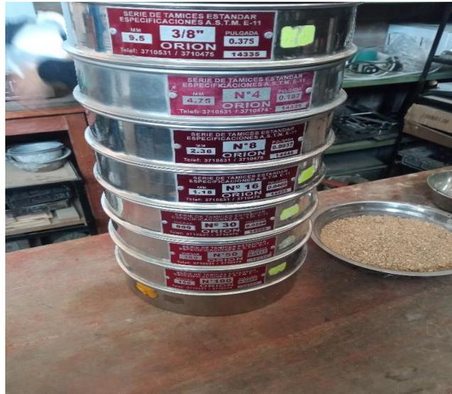
**Fig.19.** Granulometría de agregado fino
