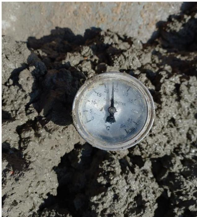
**Fig.25.** Ensayo de temperatura del concreto fresco
