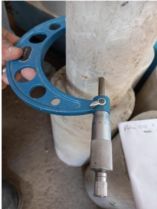
Foto 13: Medición de diámetro de probetas.
