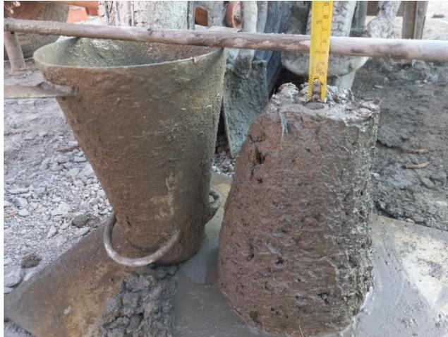
**Fig.24.** Prueba de Slump
