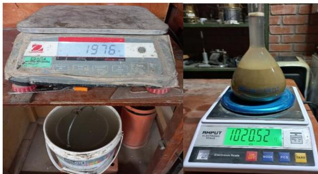
**Fig.23.** Muestra de los agregados para colocarlos al horno
