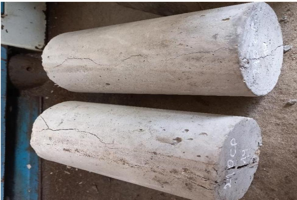
**Fig.31.** Muestras ensayadas a tracción
