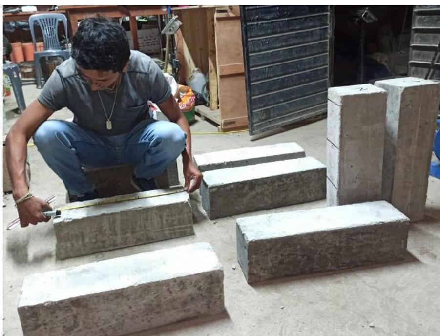
Foto 16: Toma de dimensiones de testigos prismáticos de testigos experimentales.
