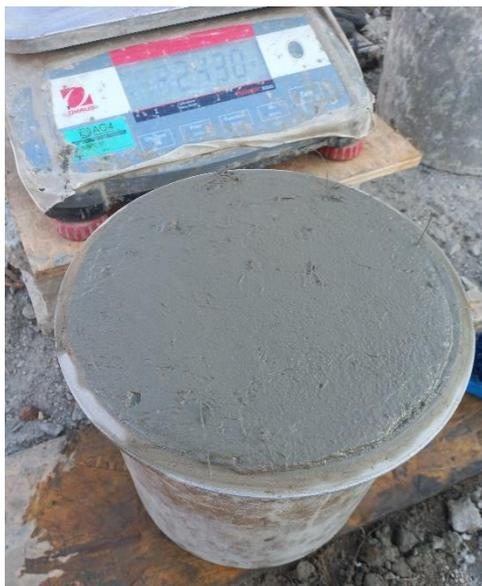
Foto 12: Pesado de las probetas en estado fresco de concreto experimental.
