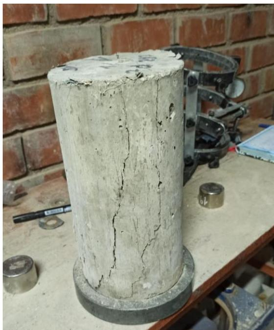
Foto 15: Fisuración del cooncreto experimental en ensayo de compresión.
