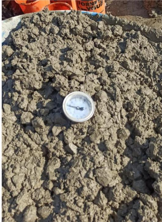
Foto 11: Ensayo de asentamiento control de temperatura de concreto experimental.
