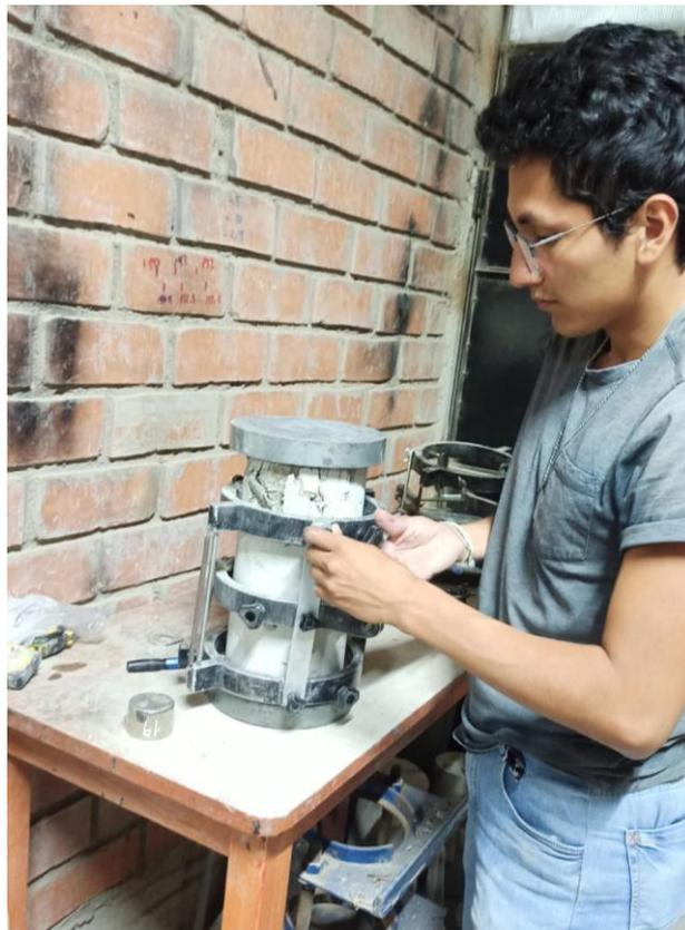
Foto 14: Desmontando equipos de ensayo de compresión de la probeta.
