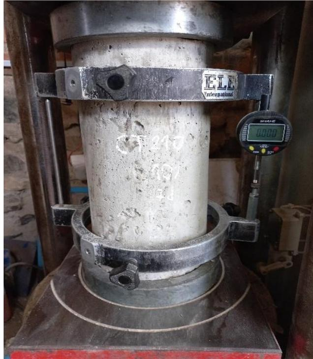
**Fig.34.** Colocación de la probeta para determinar el módulo elástico del concreto
