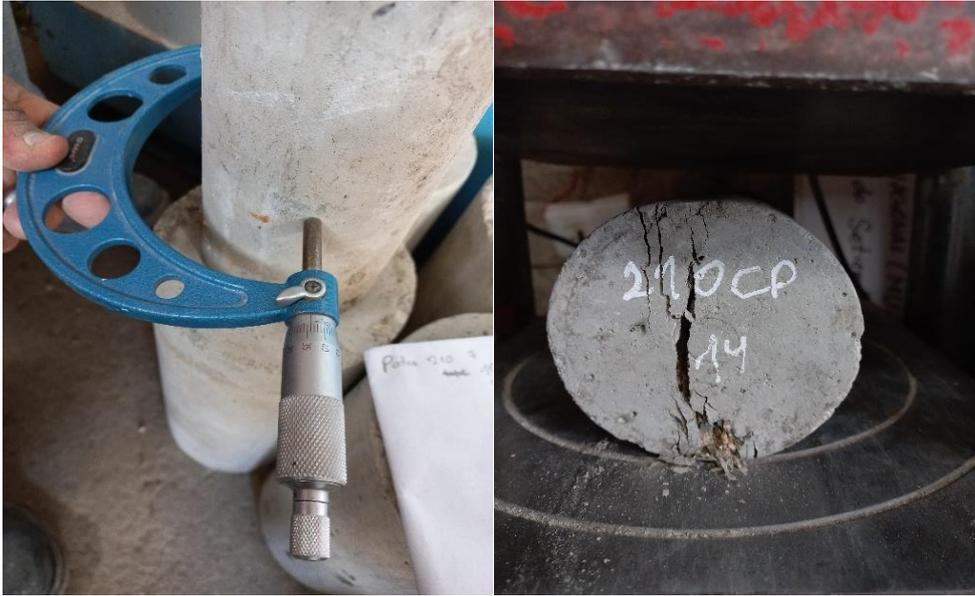
**Fig.30.** Medición del concreto y ensayo a la tracción
