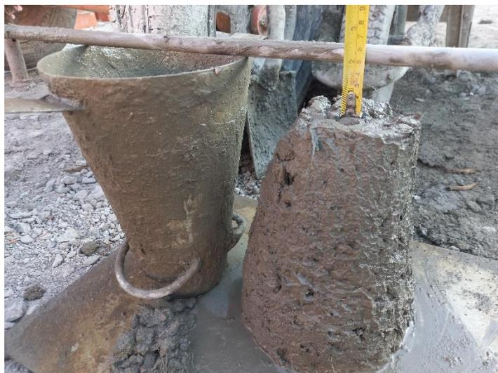
Foto 10: Ensayo de asentamiento SLUMP de concreto experimental.
