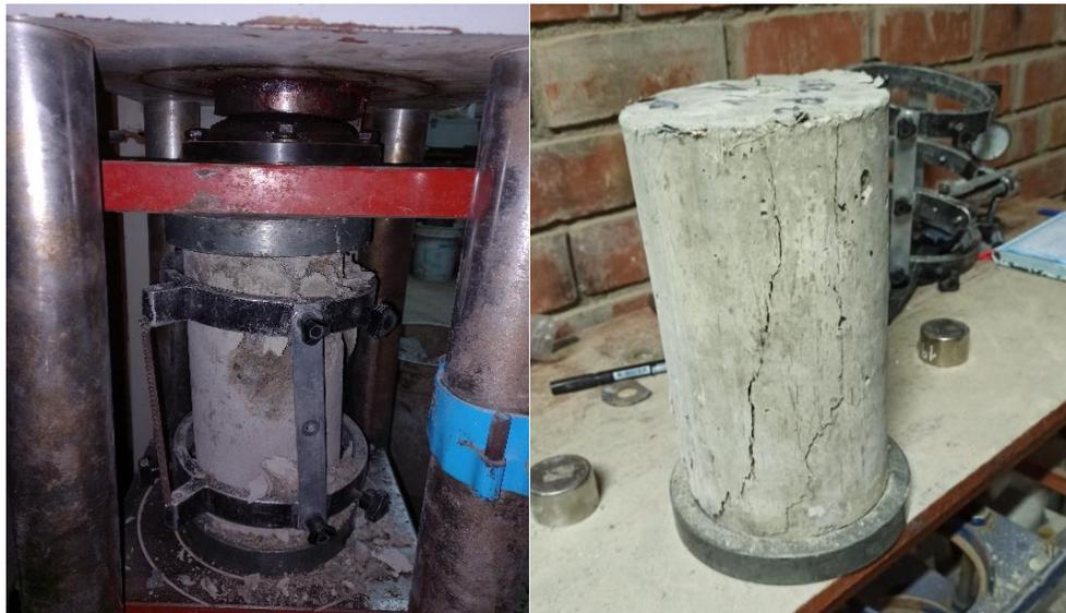
**Fig.29.** Muestras de concreto después de ensayar a compresión
