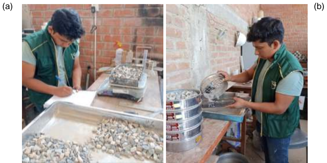
Fig. 3: (a), (b), Granulometría del árido grueso
