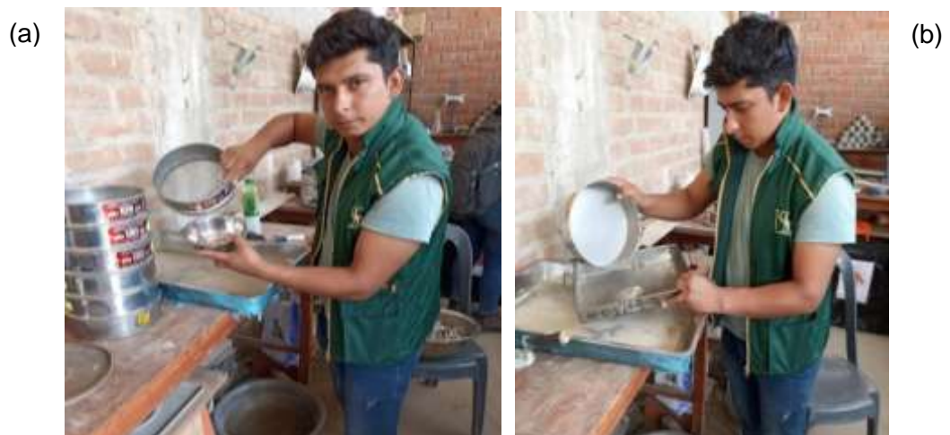
Fig. 2: (a), (b), Granulometría del árido fino
