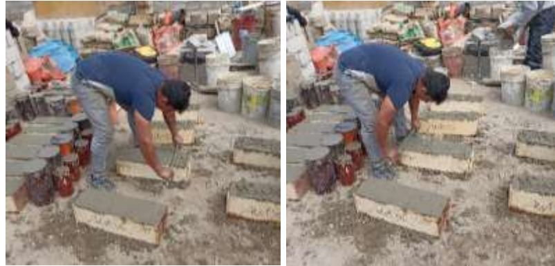
Fig. 12: (a), (b), Vaciado de mezcla en lo moldes
