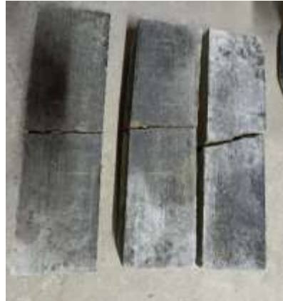
Fig. 18 testigo después del ensayo a flexión
