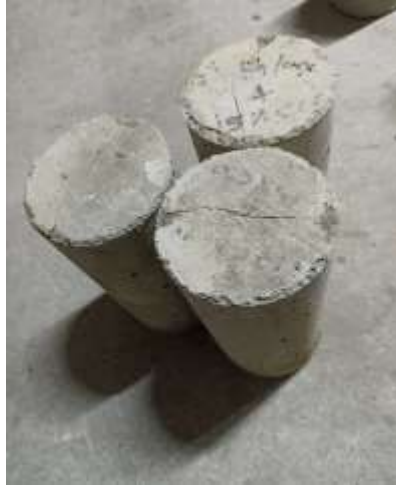
Fig. 21: muestra después de haber sido sometida al ensayo elasticidad
