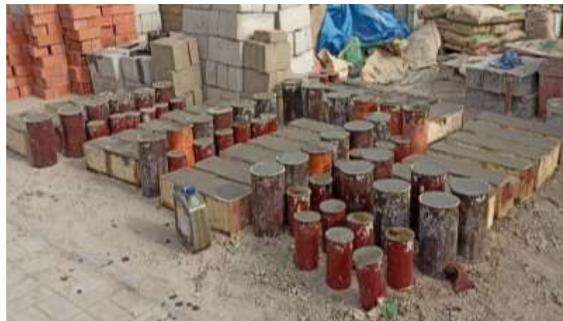
Fig. 13: Vaciado de la mezcla
