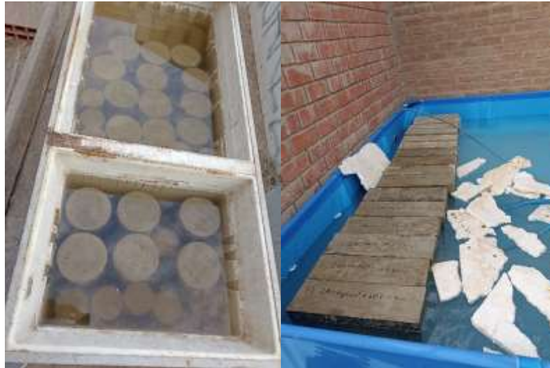
Fig. 15: (a) Cilíndricas, (b) Rectangulares, Curado de la muestra
