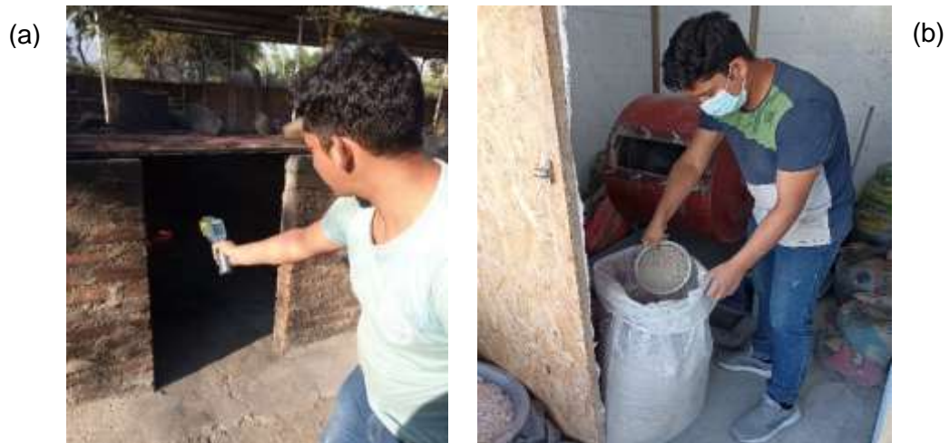
Fig. 1: (a) Quemado de la cascara de café, (b) Obtención de la puzolana
