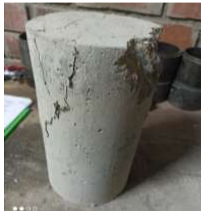
Fig. 16: Muestra después de haber sido sometido a cargas verticales
