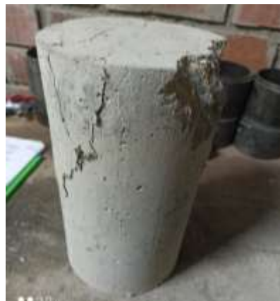
Fig. 16: Muestra después de haber sido sometido a cargas verticales
