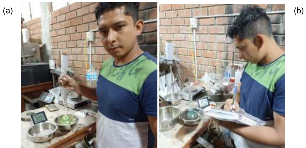
Fig. 6: (a) cemento, (b) PCC, Ensayo de peso específico a ambos materiales
