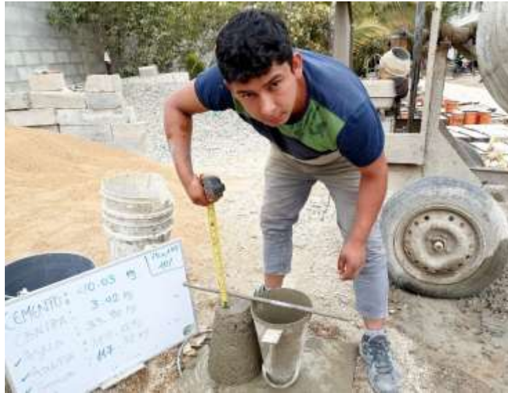
Fig. 8: Medición de asentamiento insitu.
