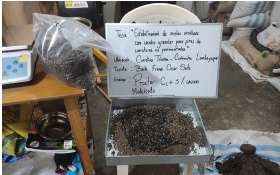
Fig. 16. Proceso de mezclado, muestra patrón + caucho granular
