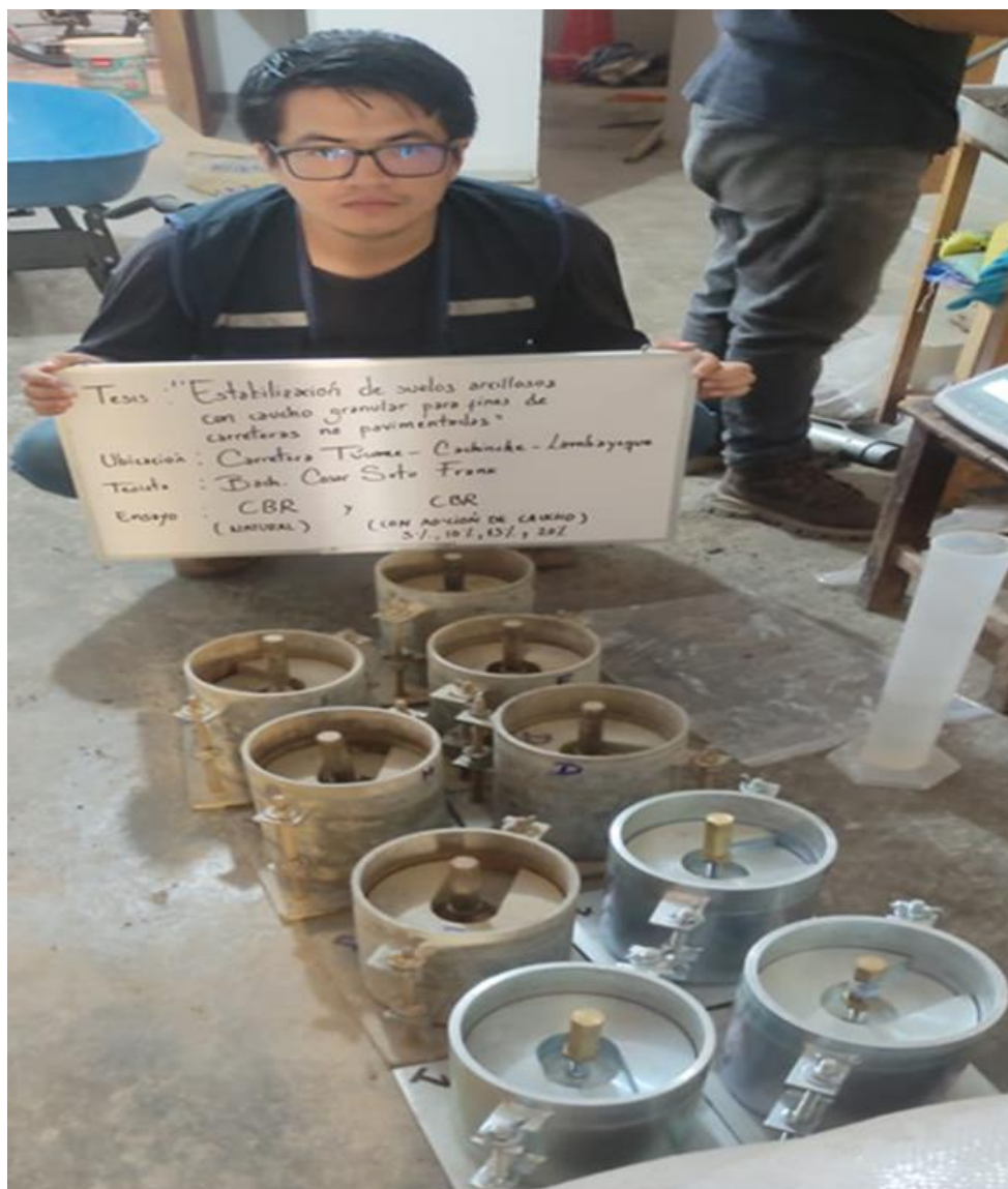
Fig. 20. CBR, muestra patrón +5% caucho granular
