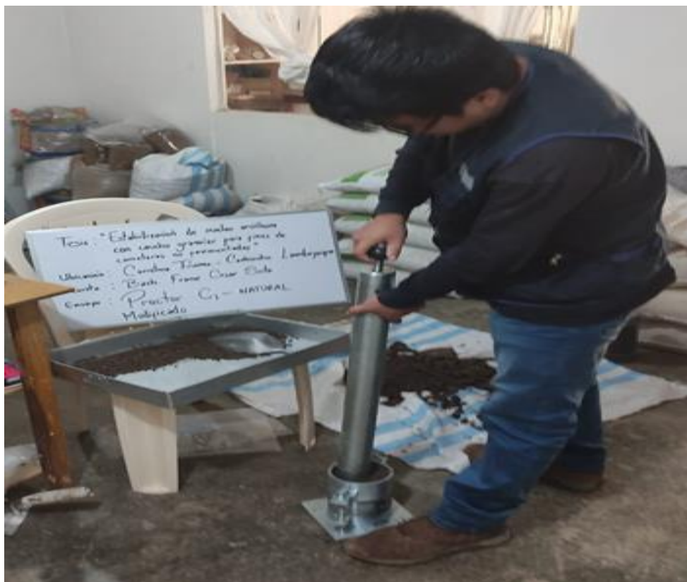
Fig. 17. Proctor modificado, compactado de la muestra
