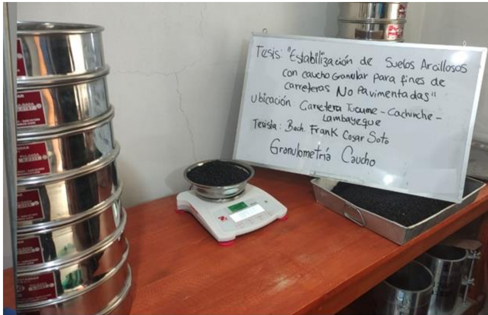
Fig. 7. Pesado caucho granular
