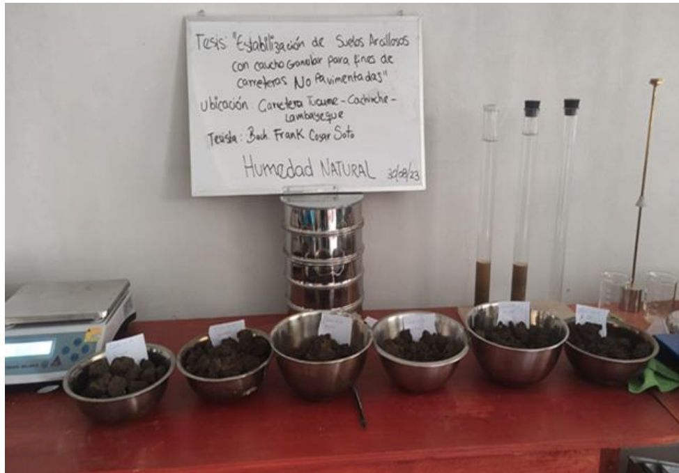
Fig. 4. Contenido humedad muestra patrón (6 calicatas)
