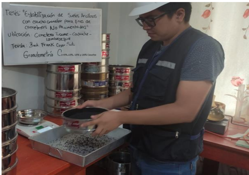
Fig. 8. Tamizado y pesado de muestras retenidas
