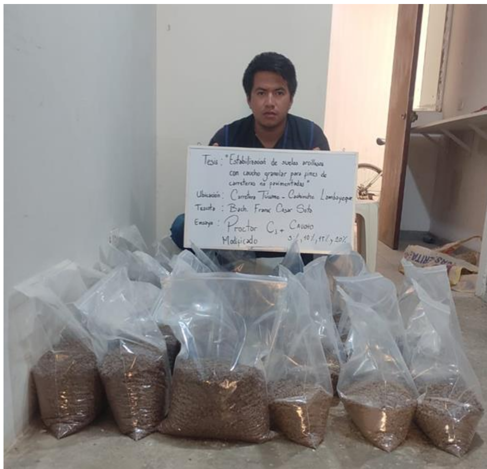
Fig. 15. Muestras listas para ensayos de Proctor Modificado
