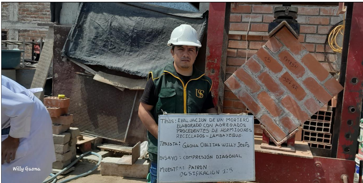
Foto N° 32: Ensayo de Compresión Diagonal en Muretes de Albañilería
