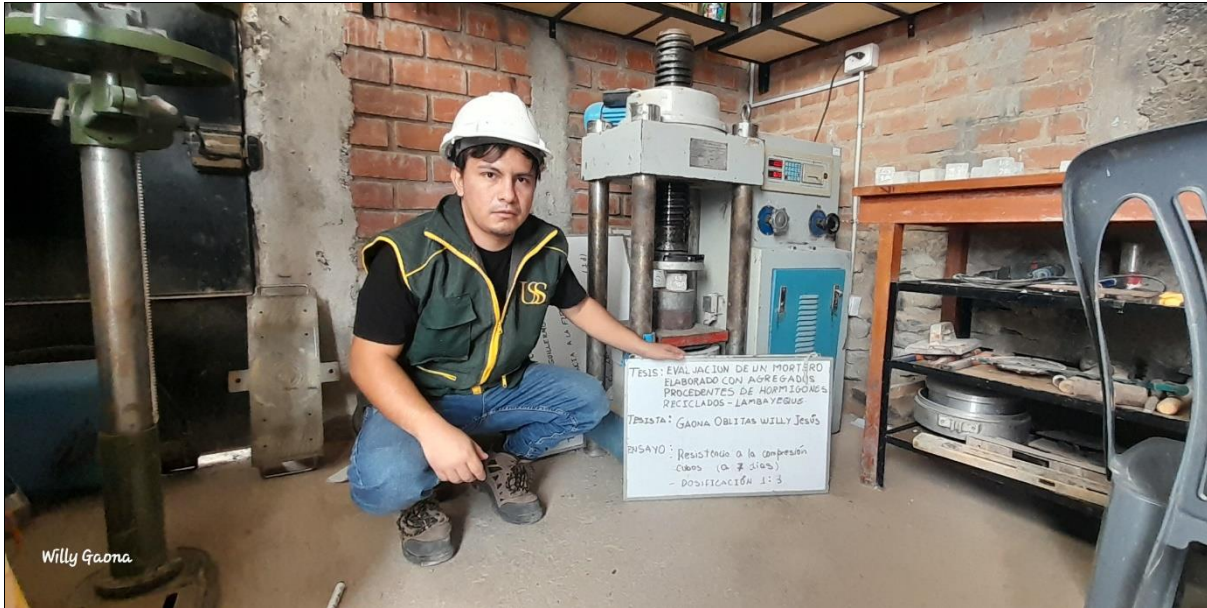
Foto N° 21: Ensayo de Resistencia a la Compresión en Especímenes de Mortero
