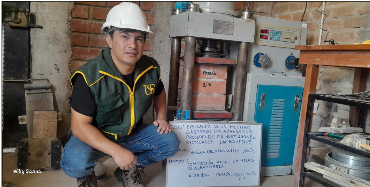
Foto N° 25: Ensayo de Resistencia a la Compresión Axial en Unidades de Albañilería
