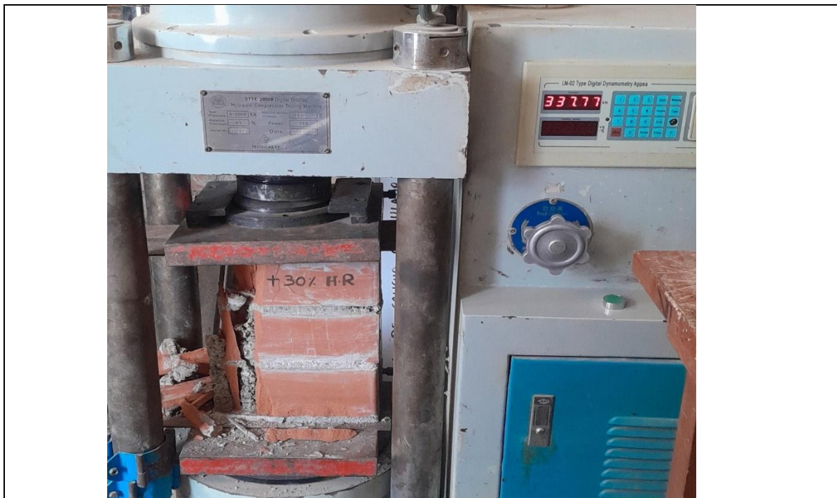
Foto N° 26: Ensayo de Resistencia a la Compresión Axial en Unidades de Albañilería, con Mortero de Hormigón Reciclado
