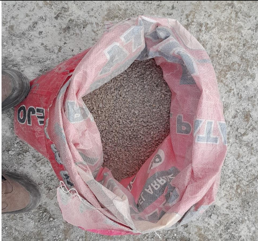
Foto N° 13: Vista de Hormigón Reciclado
