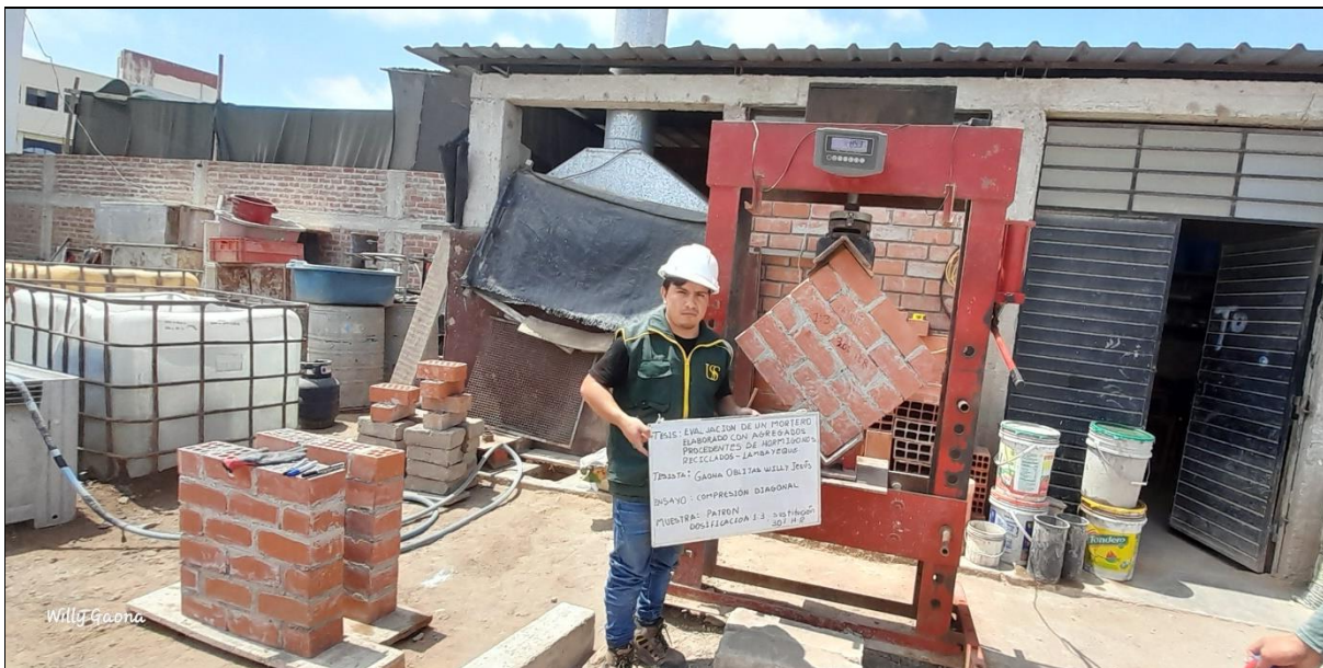
Foto N° 34: Ensayo de Compresión Diagonal en Muretes de Albañilería
