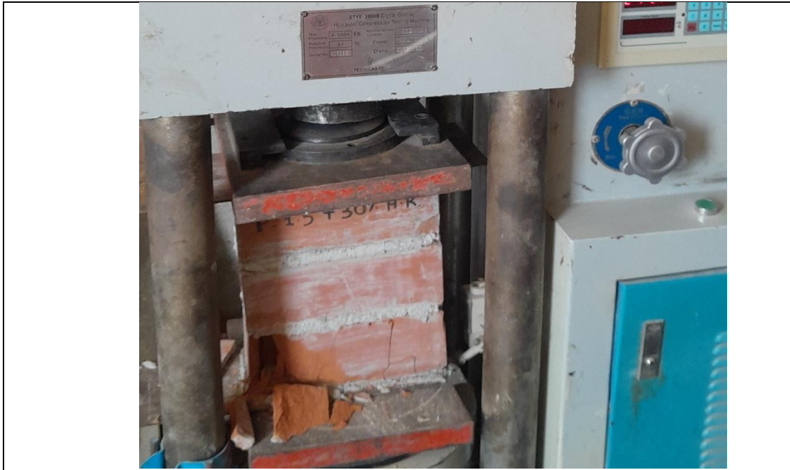
Foto N° 27: Ensayo de Resistencia a la Compresión Axial en Unidades de Albañilería, con Mortero de Hormigón Reciclado
