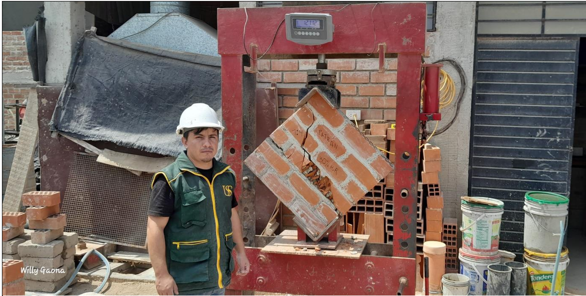
Foto N° 33: Ensayo de Compresión Diagonal en Muretes de Albañilería
