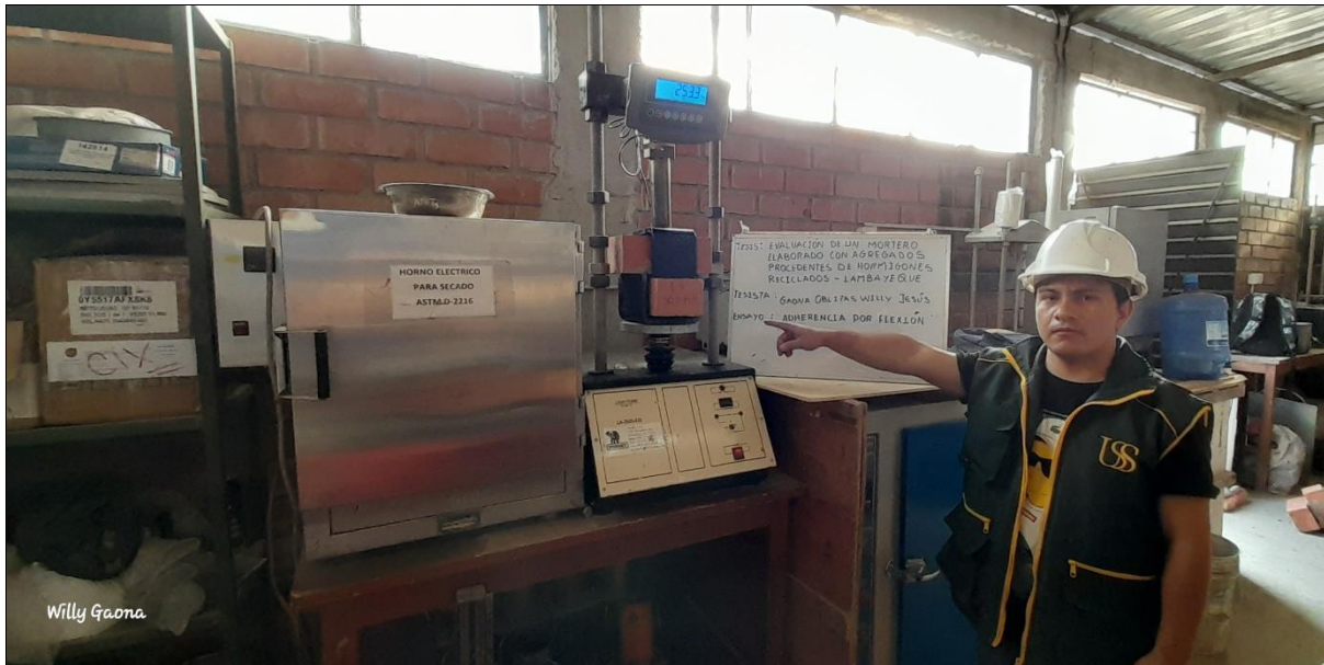
Foto N° 29: Ensayo de Resistencia a Adherencia por Flexión
