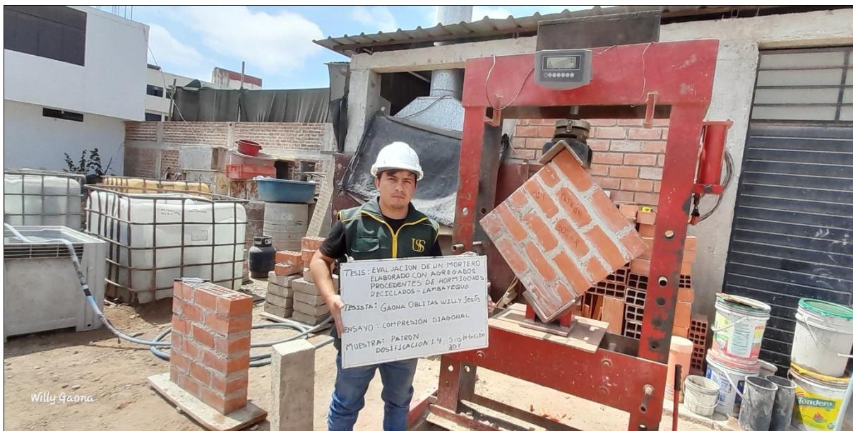
Foto N° 30: Ensayo de Compresión Diagonal en Muretes de Albañilería
