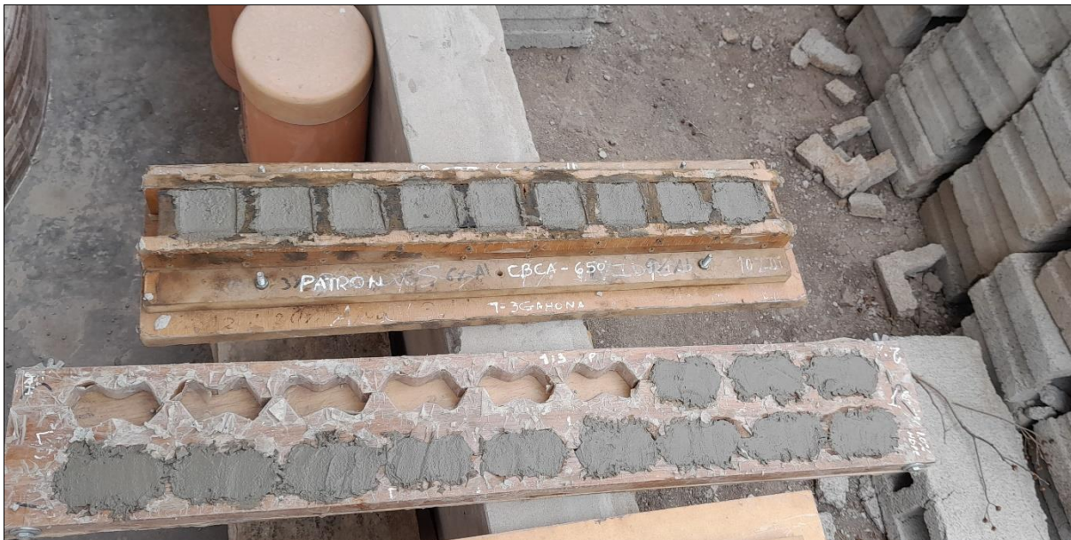
Foto N° 14: Elaboración de Especímenes de Mortero
