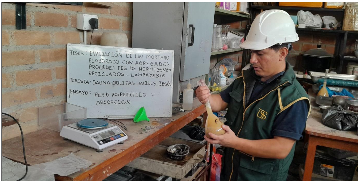
Foto N° 03: Peso Específico y Absorción Agregado Fino
