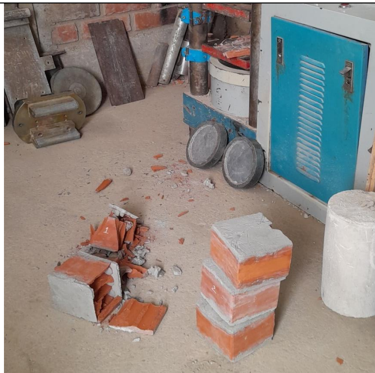
Foto N° 12: Ensayo a Compresión Axial en Unidades de Albañilería
