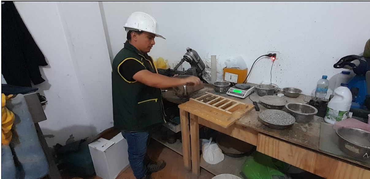
Foto N° 15: Elaboración de Especímenes de Mortero
