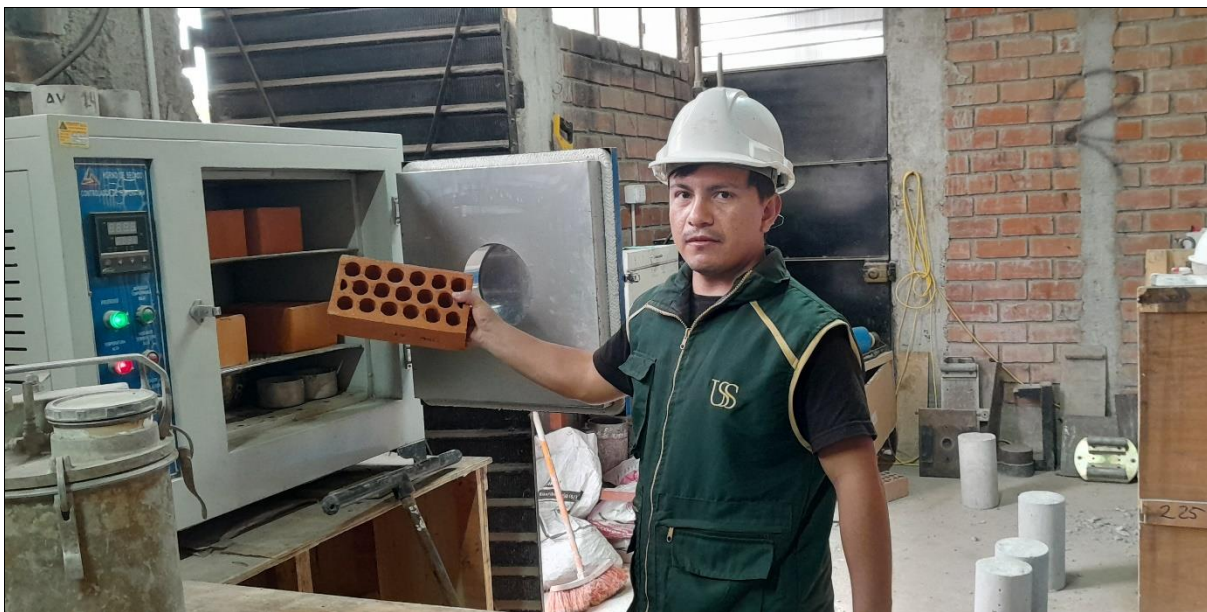
Foto N° 08: Puesta al Horno de Unidades de Albañilería para el Ensayo de Succión
