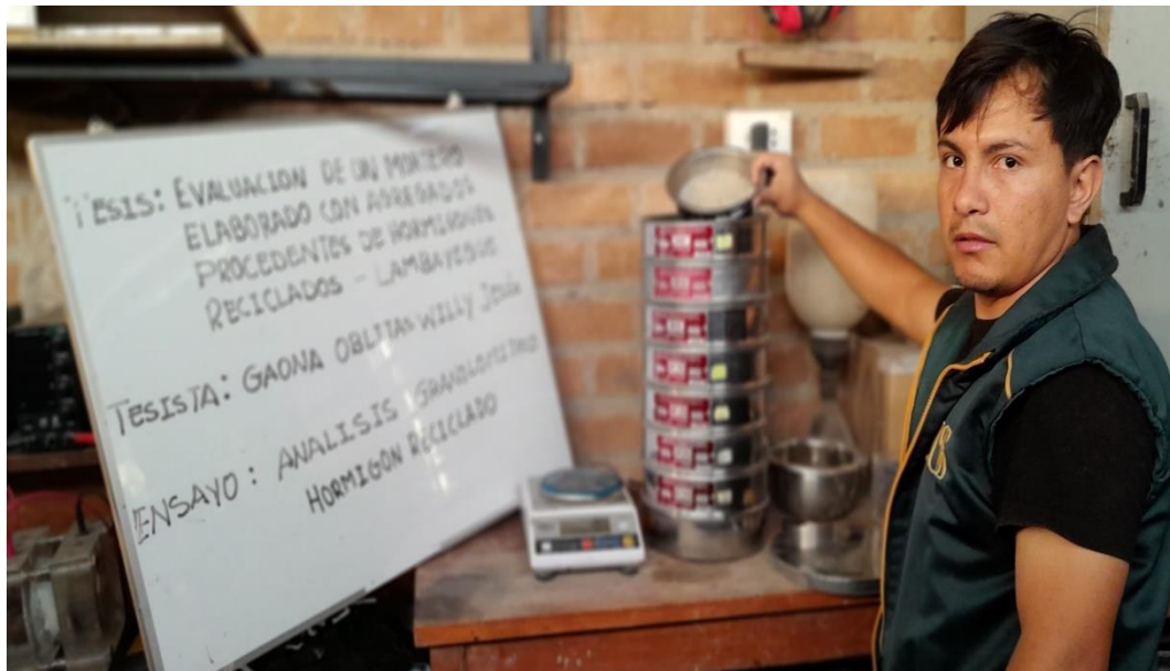
Foto N° 02: Granulometría de Agregado Fino
