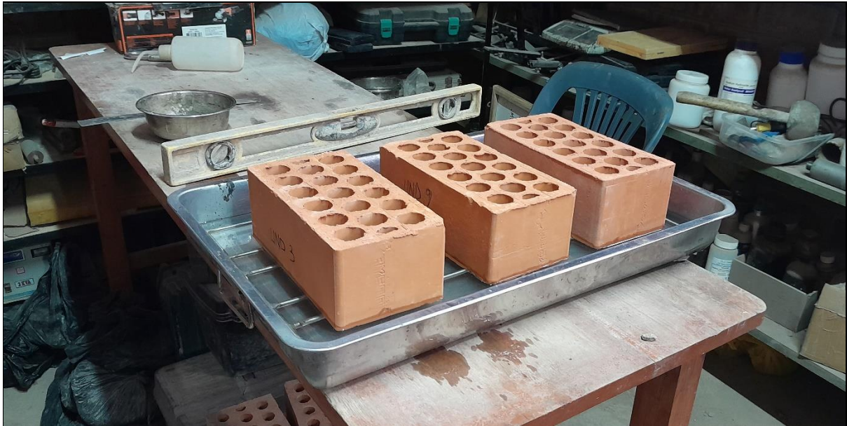
Foto N° 09: Ensayo de Porcentaje de Absorción en Unidades de Albañilería
