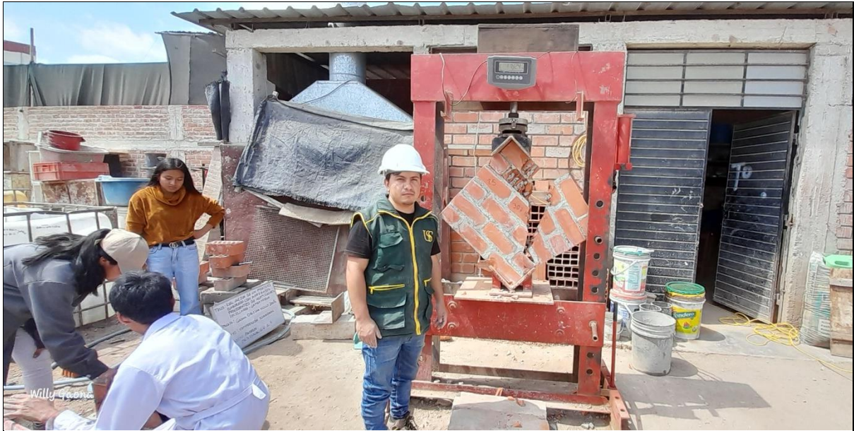
Foto N° 35: Ensayo de Compresión Diagonal en Muretes de Albañilería
