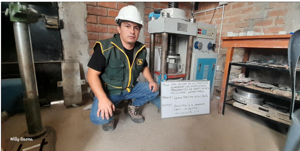
Foto N° 22: Ensayo de Resistencia a la Compresión en Especímenes de Mortero
