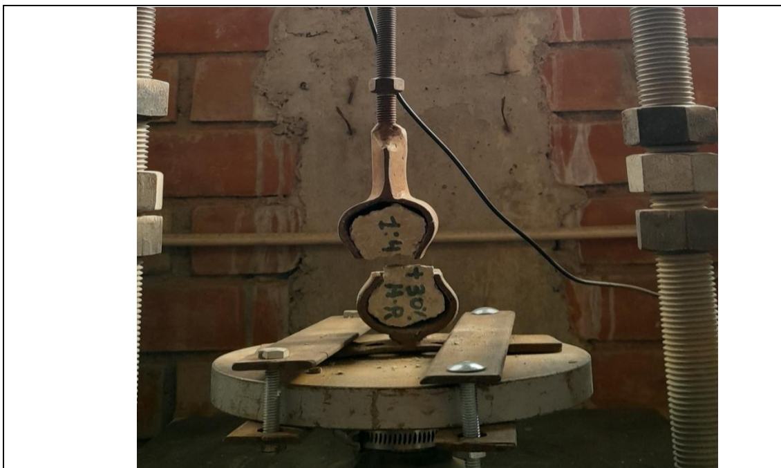
Foto N° 24: Ensayo de Resistencia a la Tracción en Especímenes de Mortero
