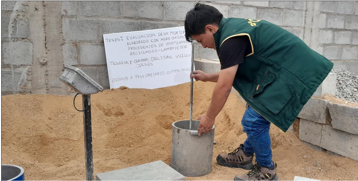
Foto N° 05: Peso Unitario Compactado de Agregado Fino
