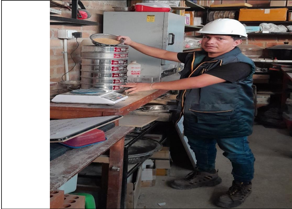
Foto N° 01: Granulometría de Agregado Fino
