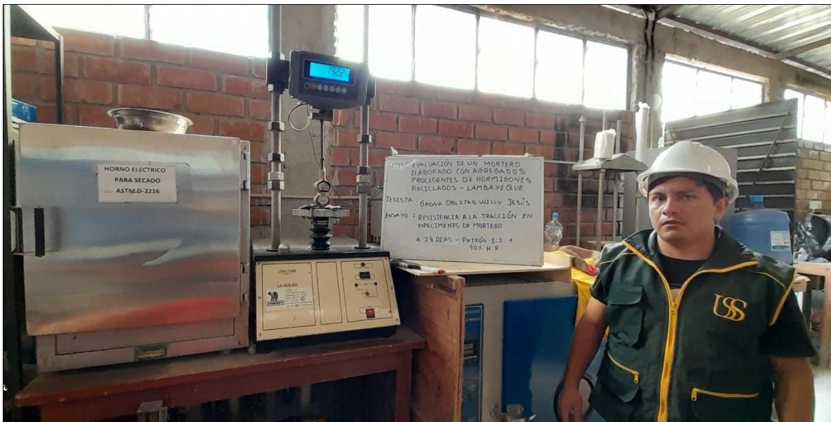
Foto N° 23: Ensayo de Resistencia a la Tracción en Especímenes de Mortero
