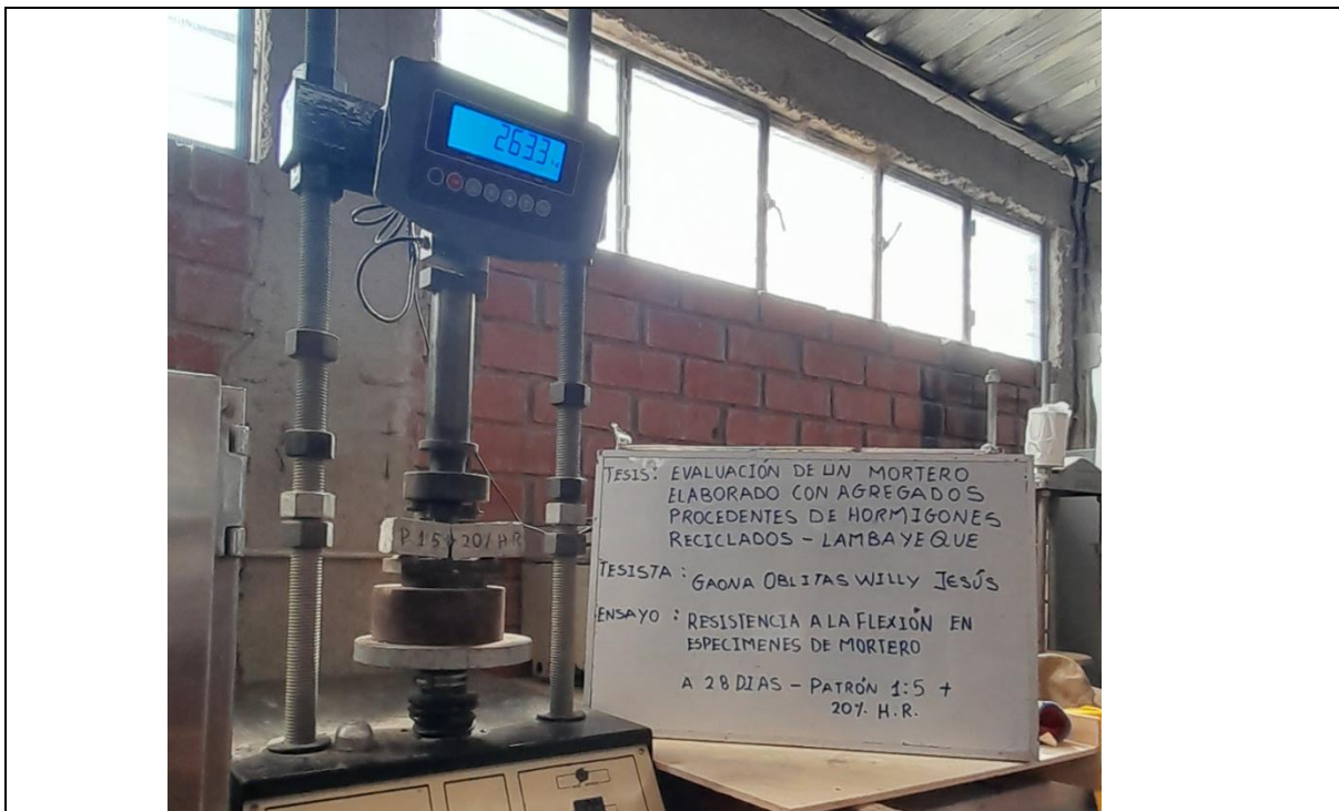
Foto N° 18: Ensayo de Resistencia a la Flexión en Especímenes de Mortero
