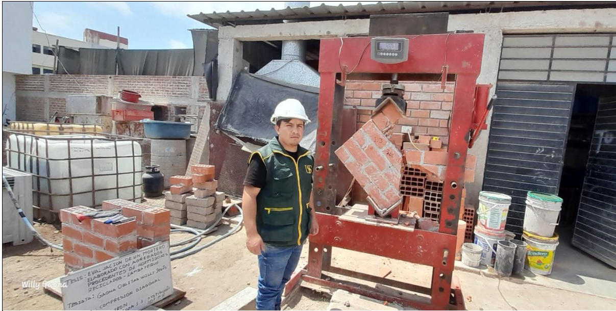
Foto N° 31: Ensayo de Compresión Diagonal en Muretes de Albañilería
