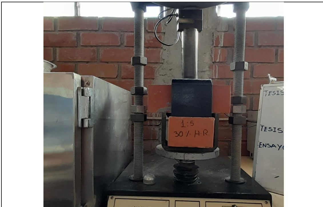
Foto N° 28: Ensayo de Resistencia a Adherencia por Flexión
