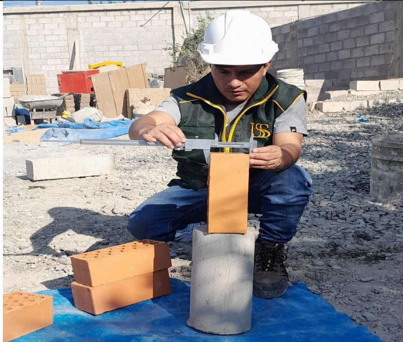
Foto N° 07: Variación Dimensional de Unidades de Albañilería
