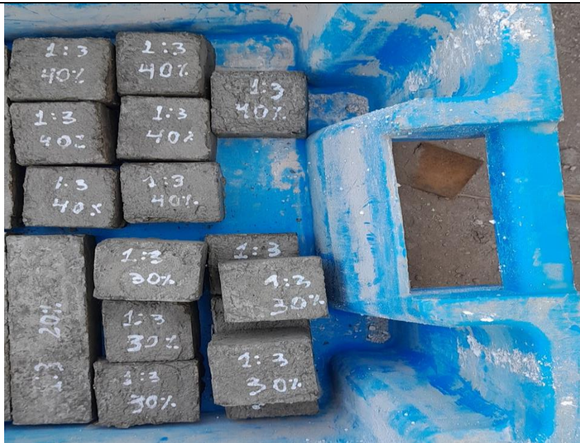
Foto N° 16: Puesta a Curado de Especímenes de Mortero
