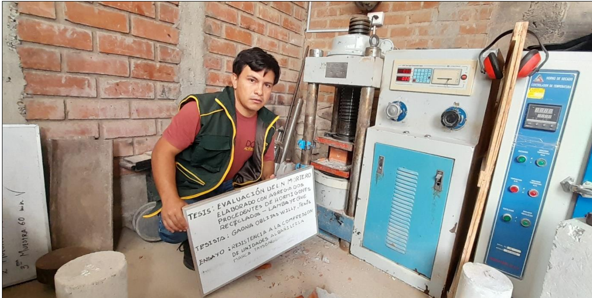
Foto N° 11: Ensayo a Compresión Axial en Unidades de Albañilería
