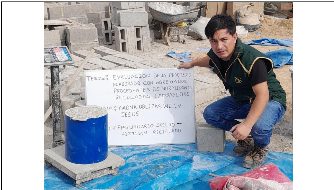
Foto N° 06: Peso Unitario Suelto de Hormigón Reciclado
