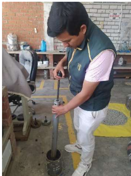
Fig. 17. Compactación del suelo.
