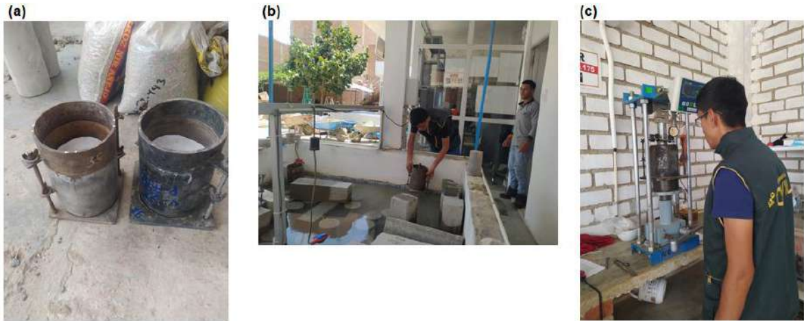
Fig. 18. Ensayo de CBR, (a) Muestras de suelo en molde, (b) Saturación de muestras, (c) Lectura de la penetración.
