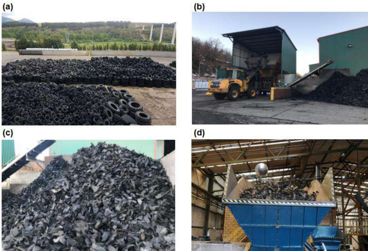
Fig. 11. Tratamiento de las fibras de caucho, (a) Zona de acopio, (b) Trituración primaria, (c) Caucho triturado, Trituración en diferentes granulometrías.
