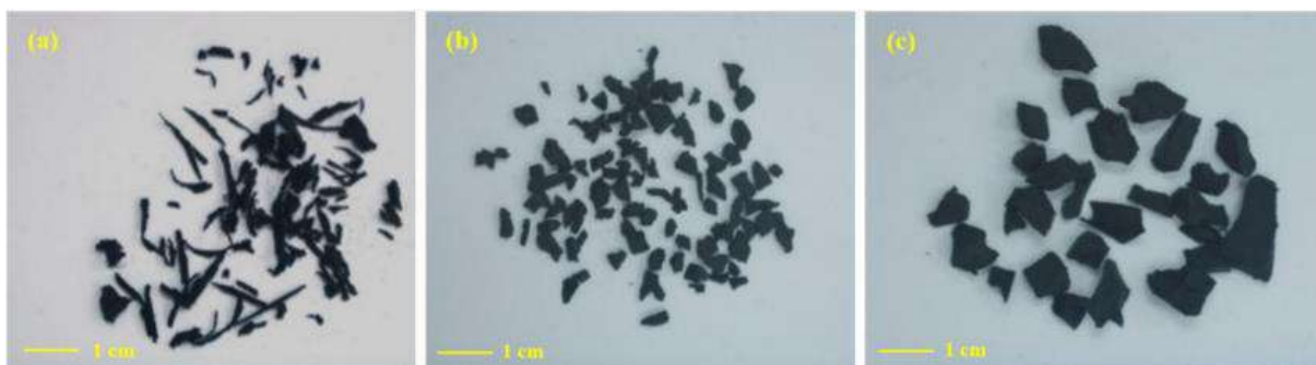
Fig. 4. (a) Agregado de caucho de fibra fina. (b) Granulado fino de caucho. (c) Agregado de caucho granular grueso [18].
