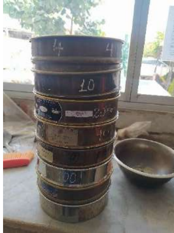
Fig. 15. Tamices usados para el análisis granulométrico.
