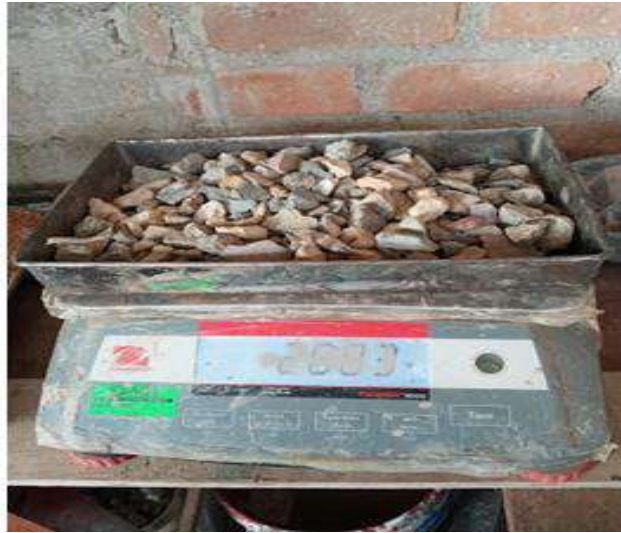
Fig. 22. Ensayo Contenido de Humedad del Agregado Grueso
