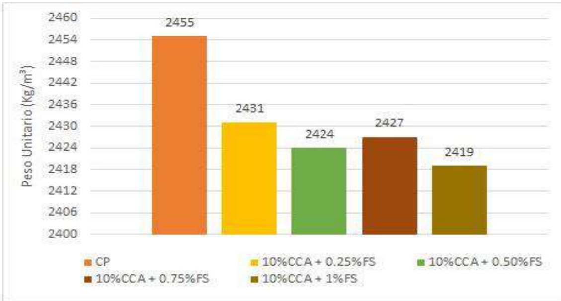
Fig. 17. Peso Unitario del concreto (210 kg/cm 2 ) con % óptimo CCA adicionando FS
