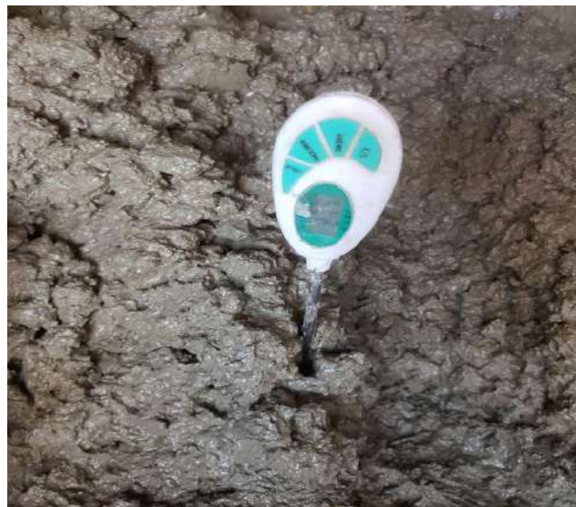
Fig. 27. Determinación de la Temperatura del Concreto.
