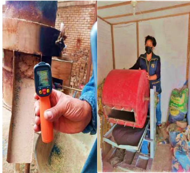
Fig. 11. Temperatura de quemado de cáscara de arroz y el uso de la máquina de abrasión
