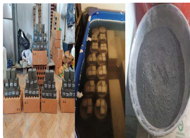
Fig. 12. Cubos de mortero, tiempo de curado y ceniza óptima
