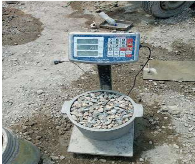
Fig. 21. Ensayo Peso Unitario Suelto Húmedo Agregado Grueso
