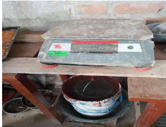
Fig. 24. Ensayo Peso Específico y Absorción del Agregado Grueso
