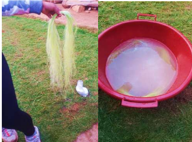
Fig. 15. Fibra tratada y lavada en una solución de agua y cal
