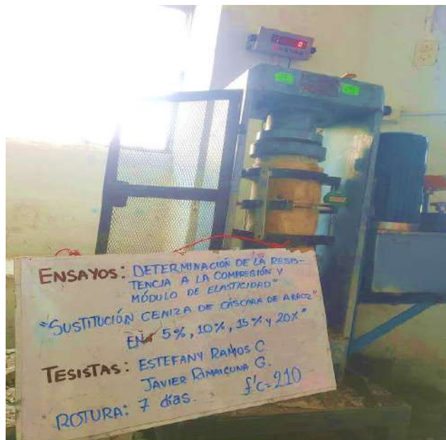
Fig. 31. Ensayo Módulos de Elasticidad del Concreto
