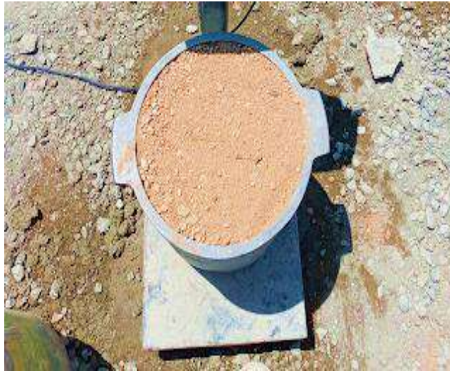
Fig. 17. Ensayo del Peso Unitario Suelto Húmedo del agregado fino
