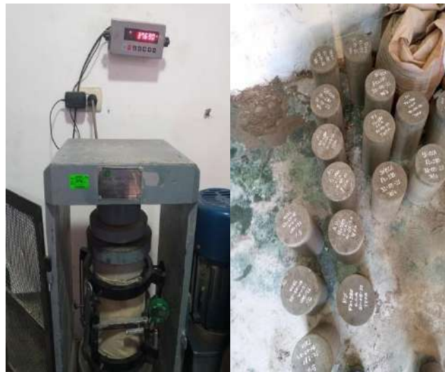
Fig. 28. Determinación de la Resistencia a la Compresión del Concreto
