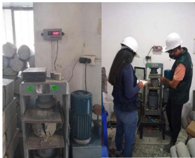
Fig. 29. Ensayo de la Resistencia a la Tracción del Concreto
