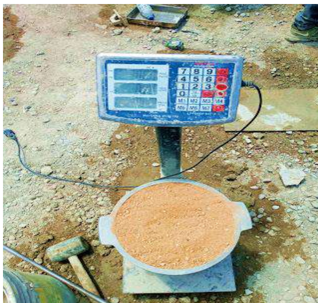
Fig. 18. Ensayo del Peso Unitario Compactado Húmedo del agregado fino
