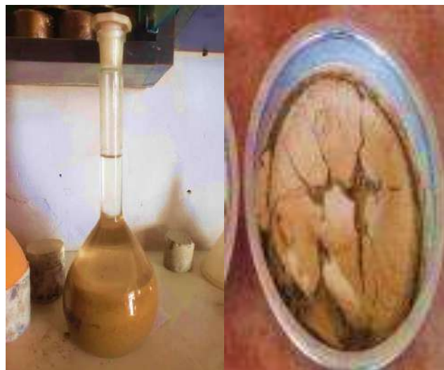
Fig. 20. Ensayo de peso específico y absorción del agregado fino
