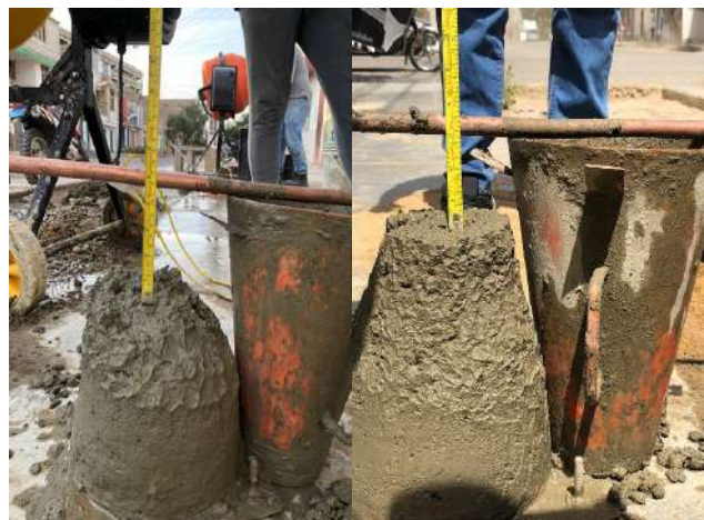
Fig. 26. Determinación del Asentamiento del concreto
