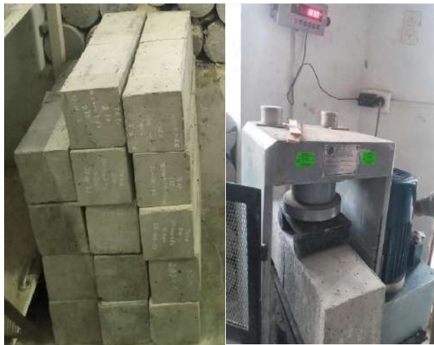
Fig. 30. Determinación de la Resistencia a la Flexión del Concreto
