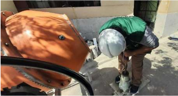
Ensayo de asentamiento “slump”
