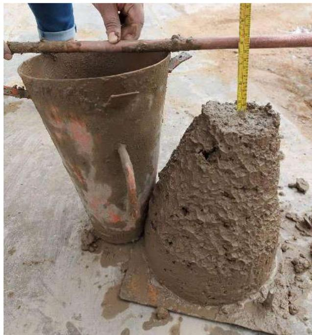
**Fig. 18** Ensayo de asentamiento.
