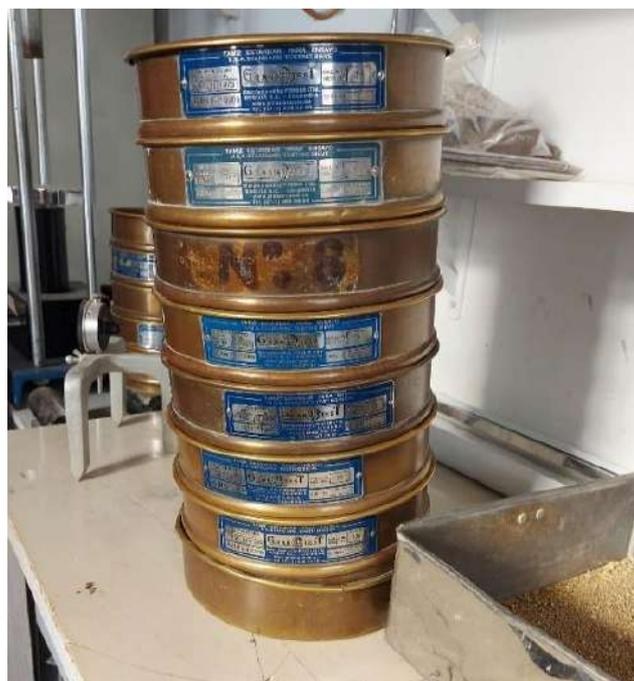
**Fig. 10** Tamizado de agregado fino.
