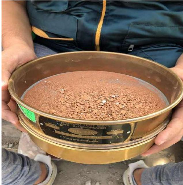
**Fig. 6** Tamizado del PRC por la malla #200
