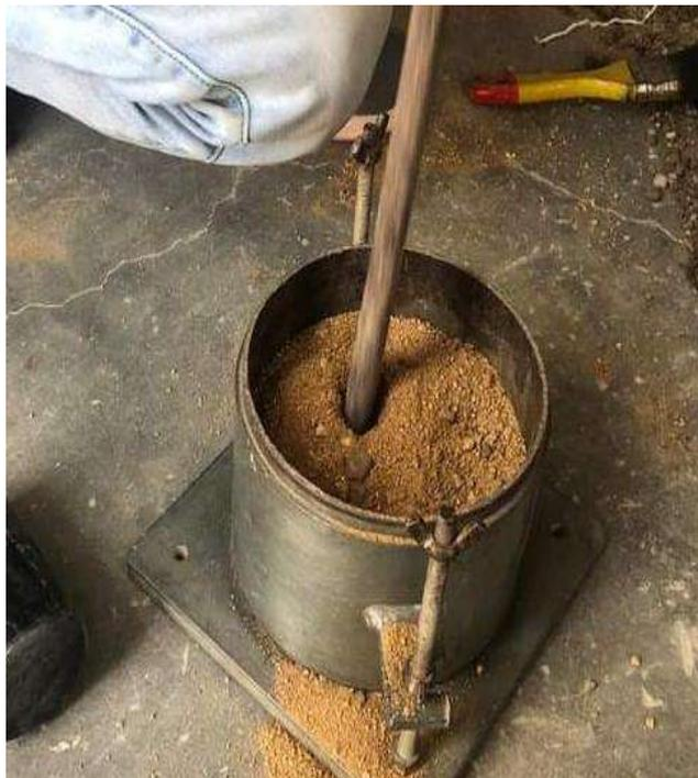
**Fig. 13** Realización del PUC del agregado fino.
