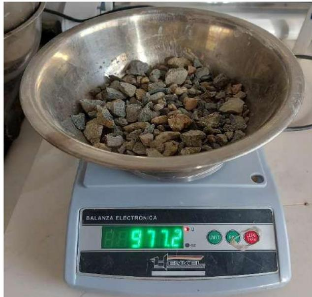
**Fig. 15** Peso de la muestra seca al horno (AG).
