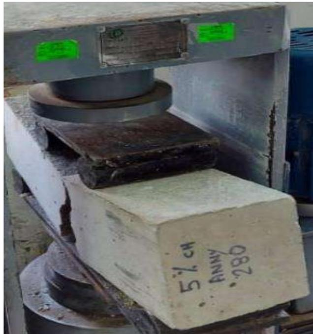
**Fig. 23** Ensayo de flexión del concreto.
