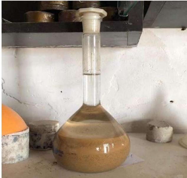
**Fig. 17** E. de peso específico y absorción del AF.
