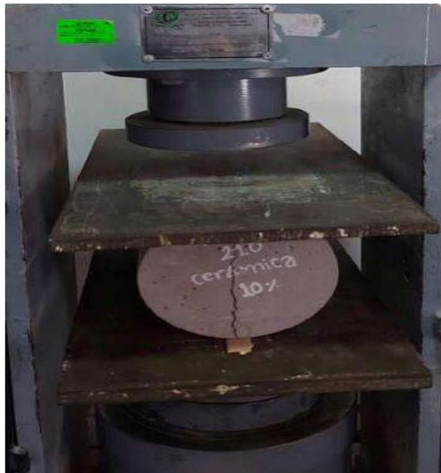
**Fig. 22** Ensayo tracción.
