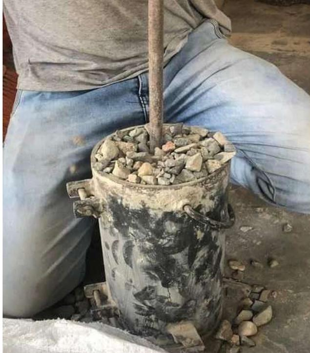
**Fig. 12** Realización del PUC del agregado grueso.
