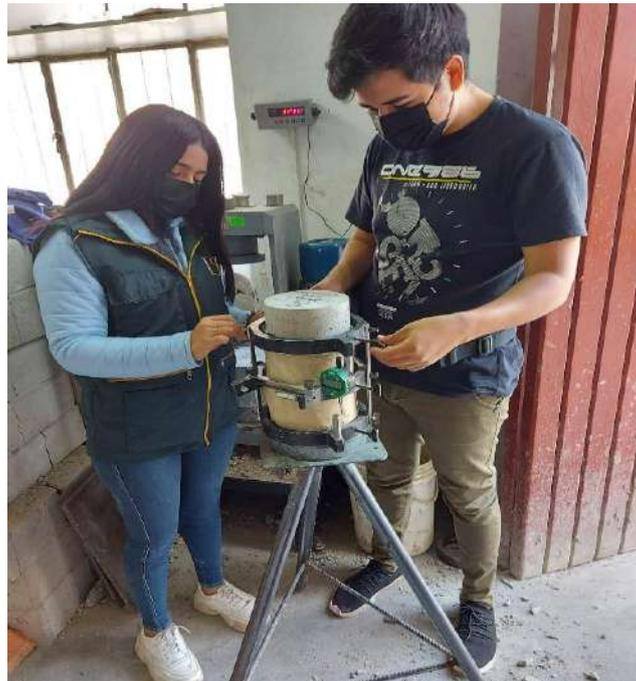
**Fig. 24** Ensayo de módulo de elasticidad.
