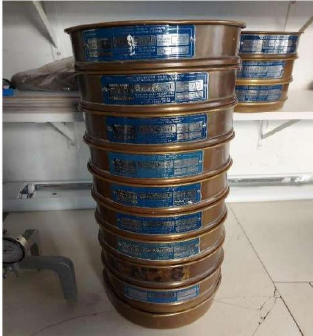
**Fig. 11** Tamizado de agregado grueso.
