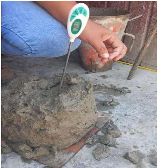
**Fig. 19** Toma de la temperatura del concreto.
