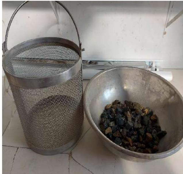
**Fig. 16** E. de peso específico y absorción del AG.
