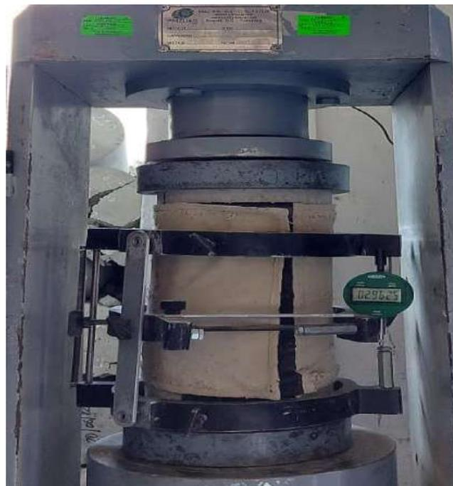
**Fig. 21** Ensayo de compresión.
