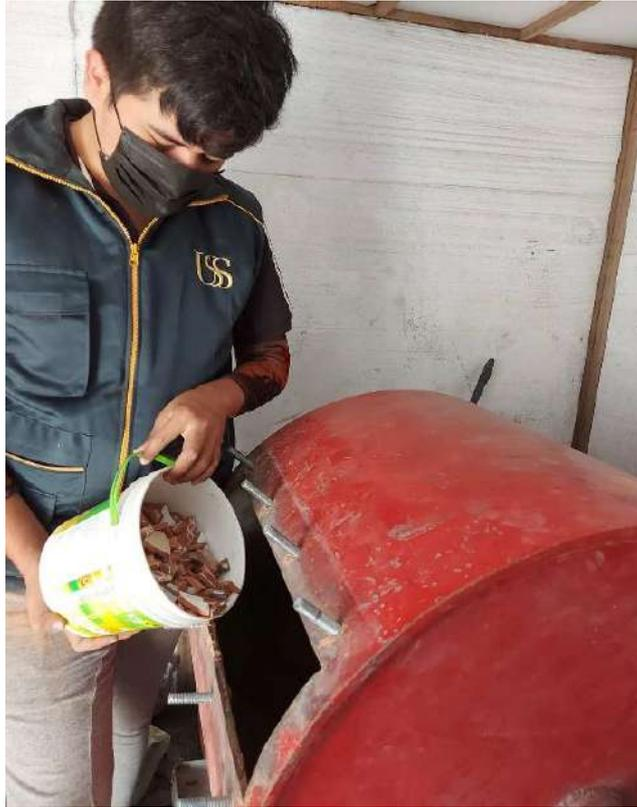
**Fig. 4** Pulverización de los residuos cerámicos en molino
