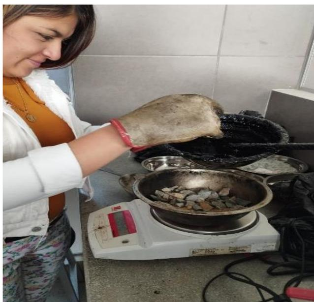
**Fig. 18** Combinación de los agregados, CCA y líquido asfáltico.
