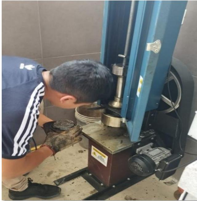
**Fig. 19** Briquetas asfálticas sometidas a compactación.
