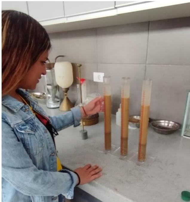
**Fig. 15** Ensayo equivalente de arena
