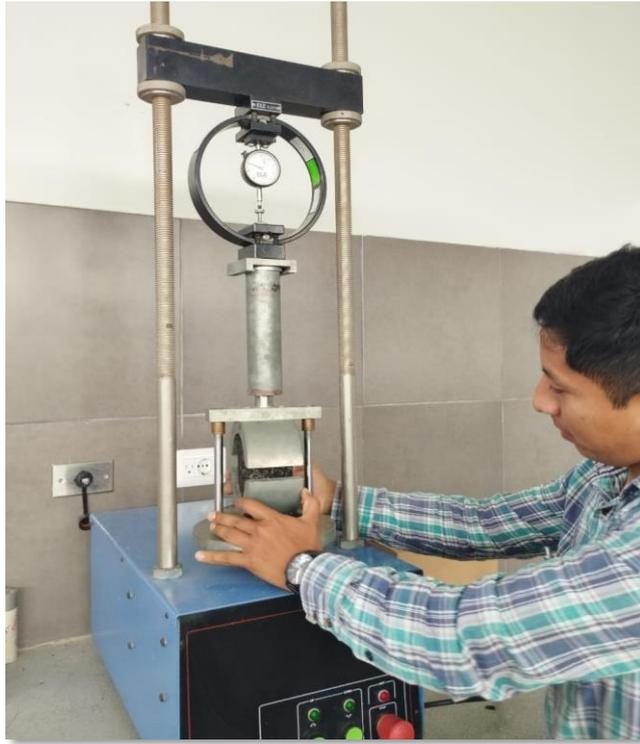
**Fig. 22** Ensayo de Estabilidad; Flujo – Método Marshall.
