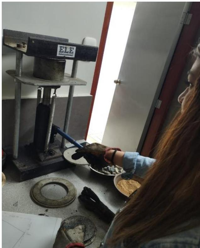
**Fig. 20** Extracción de briquetas asfálticas.
