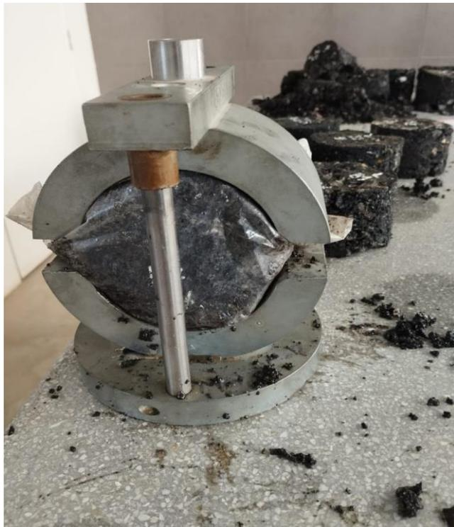
**Fig. 23** Rotura de briquetas con el Método Marshall.
