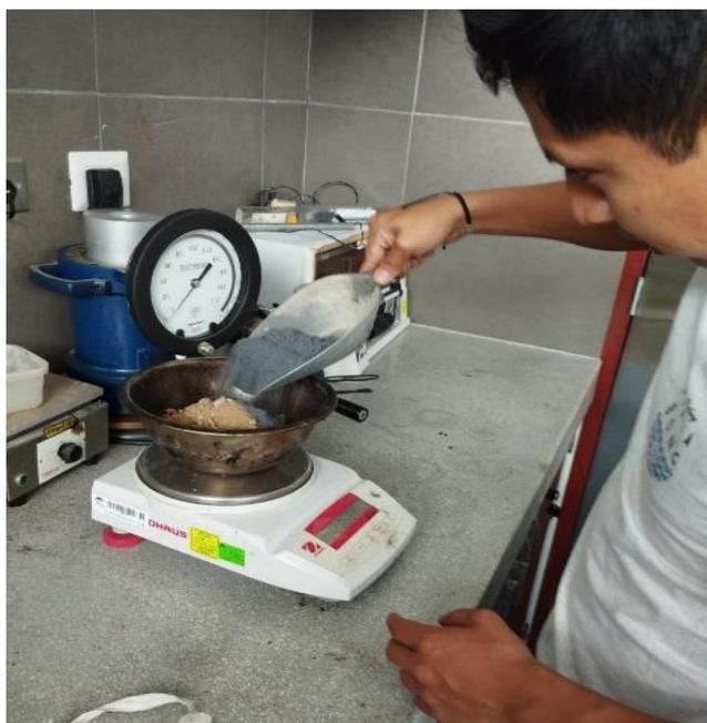
**Fig. 17** Combinación de los agregados para elaboración de briquetas
