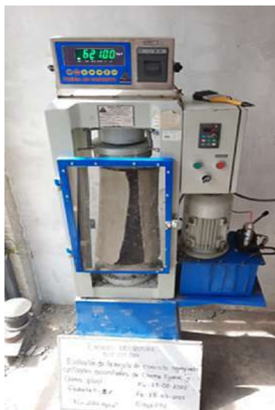
Fotografía 14: Ensayo de resistencia a la compresión, en probetas con adiciones de 8% de micro sílice
