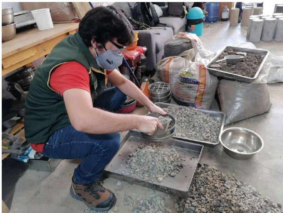
Fotografía 04: Tamizado del agregado grueso
