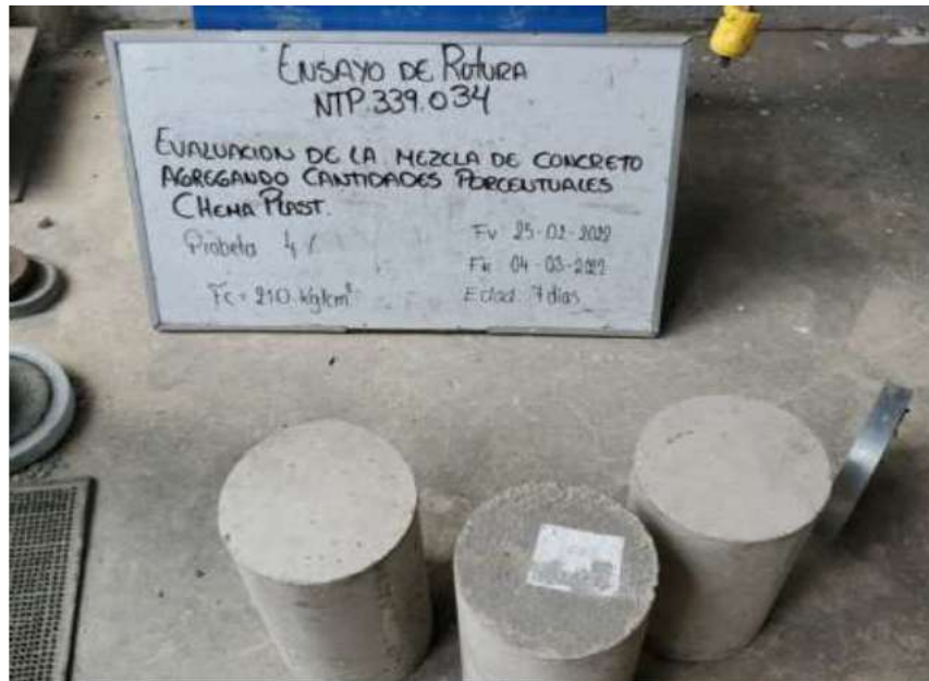
Fotografía 09: Probetas de concreto con adiciones de 4% de microsílíce
