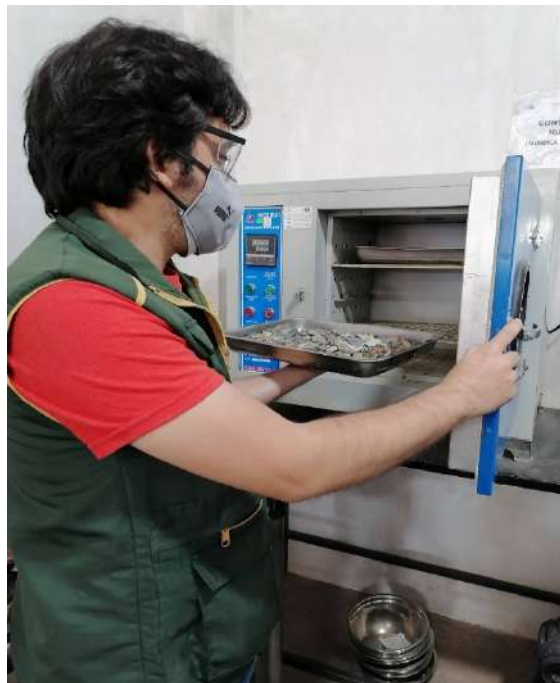
Fotografía 06: Ingresando agregado grueso al horno para su total secado.
