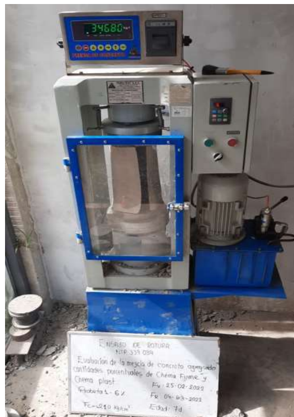
Fotografía 12: Ensayo de resistencia a la compresión, en probetas con adiciones de 6% de microsílíce
