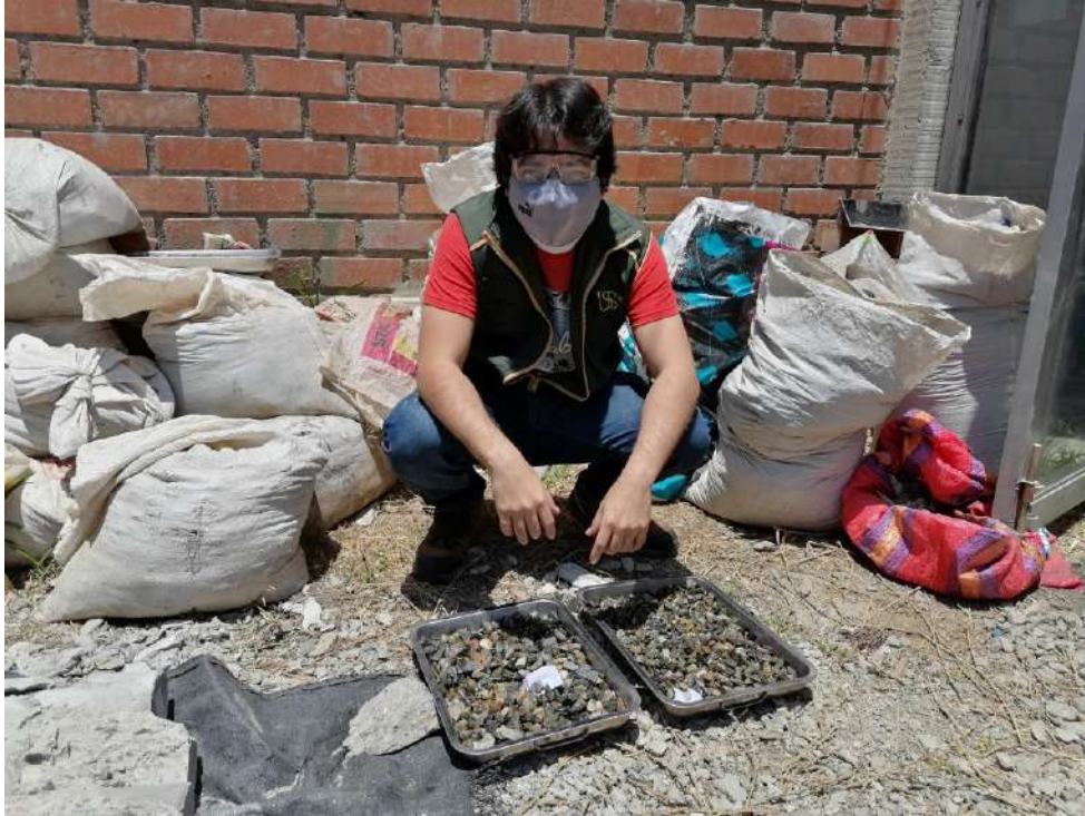
Fotografía 05: Agregado grueso seleccionado después de ser humedecido.
