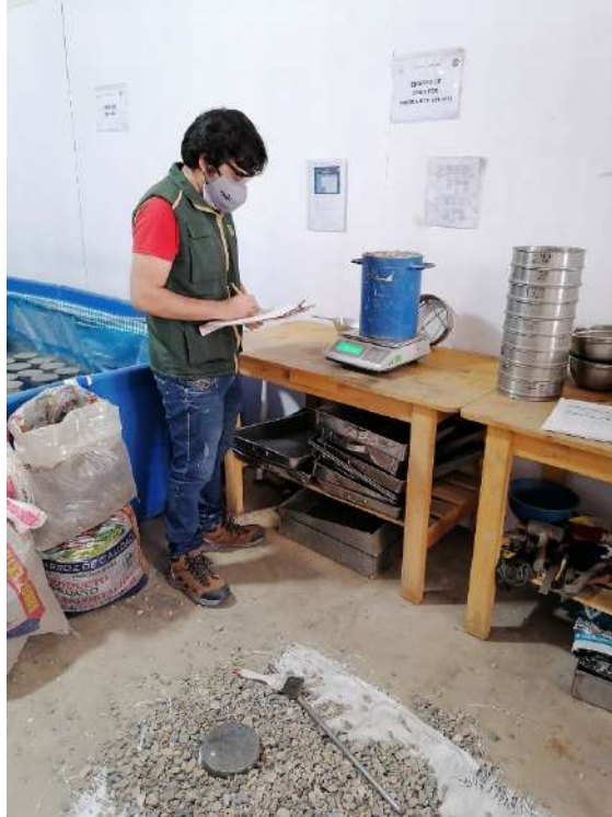
Fotografía 07: Realizando el peso unitario del agregado grueso
