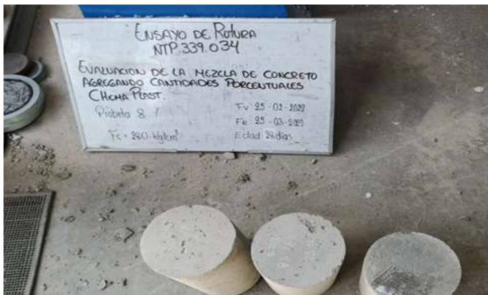
Fotografía 13: Probetas de concreto con adiciones de 8% de microsilíce
