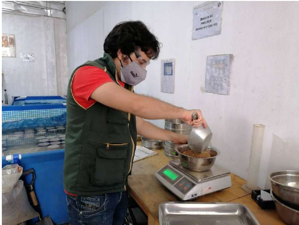
Fotografía 03: Pesado de agregado fino en estado de humedad natural
