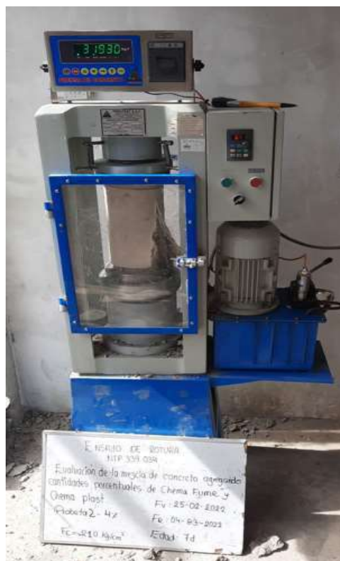
Fotografía 10: Ensayo de resistencia a la compresión, en probetas con adiciones
