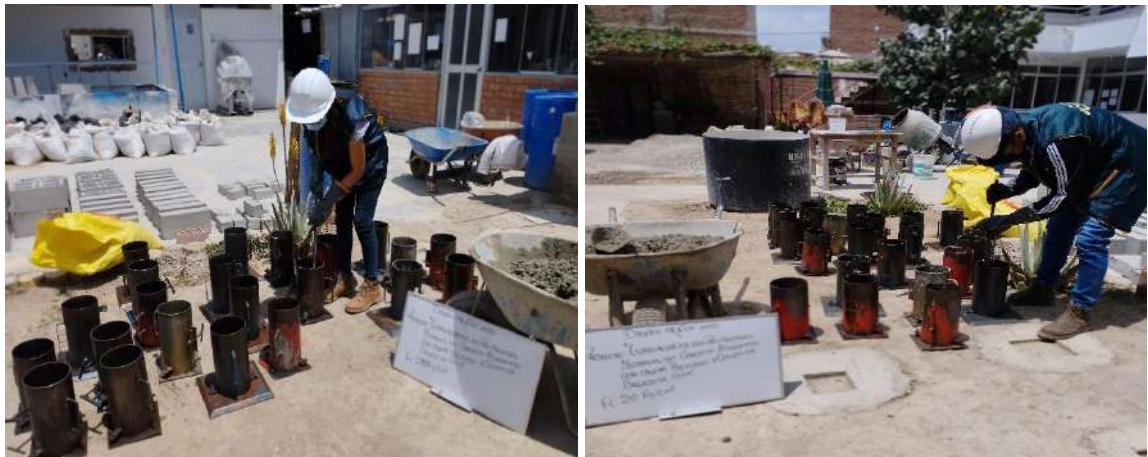
Elaboración de muestras de concreto.
