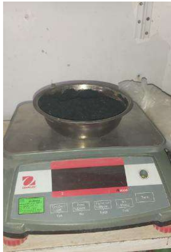
Fotografía 3. Pesado de la fibra de caucho para su incorporación.
