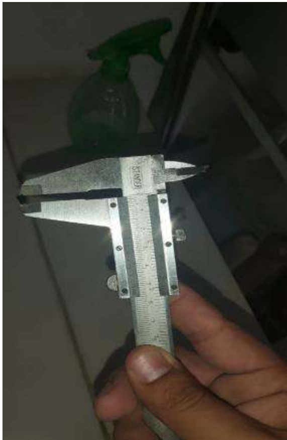
Fotografía 6. Medición de las dimensiones de la probeta de concreto a ensayar.
