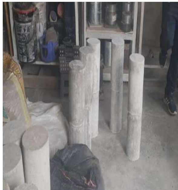
Fotografía 4. Probetas de concreto para ensayo a compresión.
