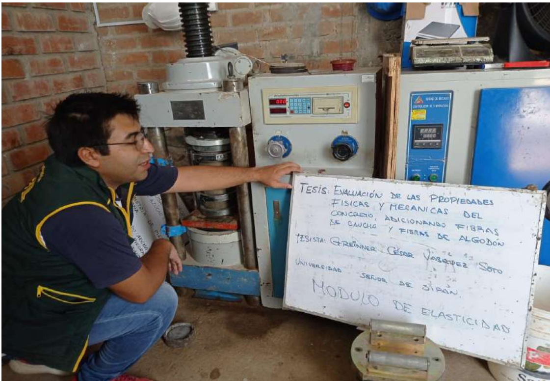
Fotografía 10. Ensayo del módulo de elasticidad
