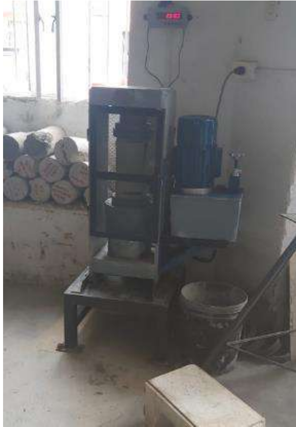
Fotografía 7. Ensayo a compresión de las probetas cilíndricas.
