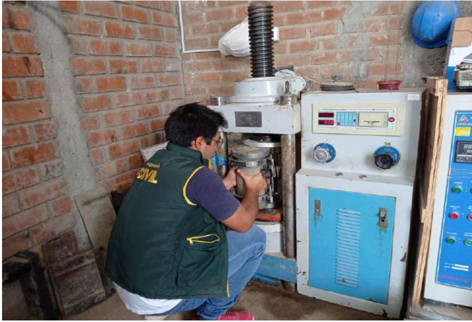
Fotografía 11. Colocación de la probeta para el ensayo de tracción
