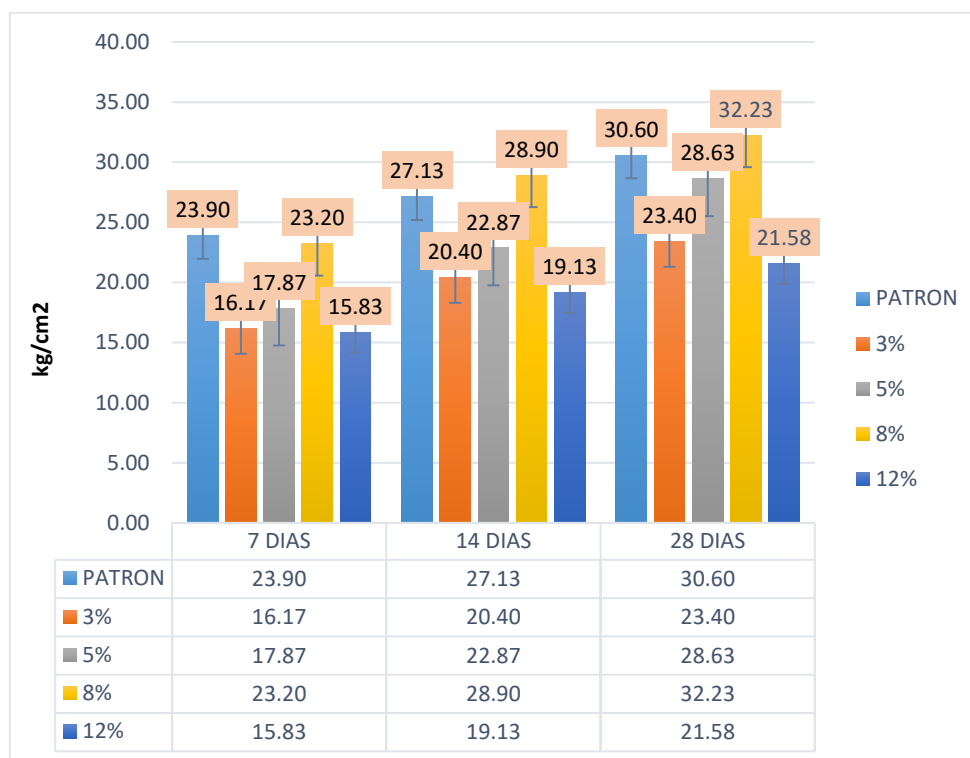
Fig.16. Resistencia a la tracción con adición de CCA para CP 280.
